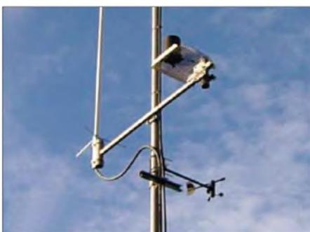
**X-50-Antenne sowie Regen- und Windsensor der WX-Station des APRS-Digis DB0HWR-5**
