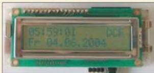
Aus fertigen Baugruppen lässt sich unter Zuhilfenahme eines Mikrocontrollers schnell diese Funkuhr aufbauen, die zusätzlich zur Ansteuerung externer Baugruppen dienen kann. Foto: Bauer
