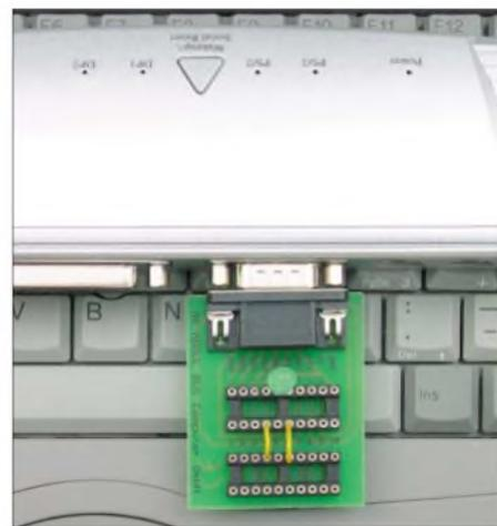
Bild 2: Experimentierplatine an die serielle Schnittstelle stecken und loslegen. USB-RS232-Adapter sind dabei problematisch.
