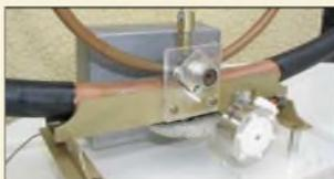
Nicht nur für die Bedienung des Drehkondensators einer Magnetantenne mittels Schrittmotors eignet sich die im abgeschirmten Gehäuse untergebrachte Funkfernsteuerung. Foto: Scholl
