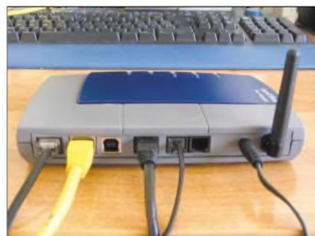
Vor der Installation sind Modem, Router und Telefonanlage zu verkabeln.
