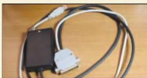
Dieses kleine Plastikgehäuse beherbergt die Hardware, mit der sich im Zusammenwirken mit einem PC ein leistungsfähiger Messplatz für komplexe Impedanzen aufbauen lässt. Foto: IW3HEV
