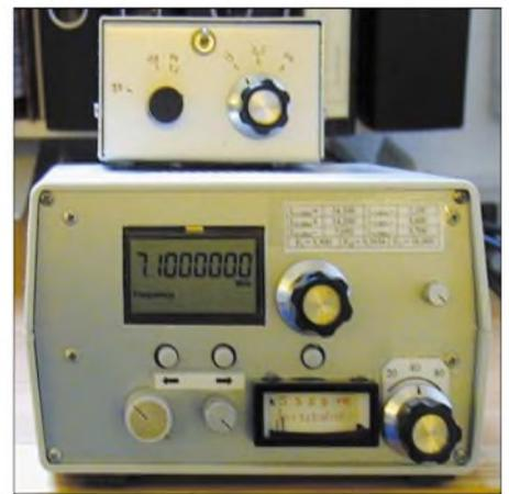
Bild 2: Empfänger mit eingebauter DDS; darüber der Preselektor
