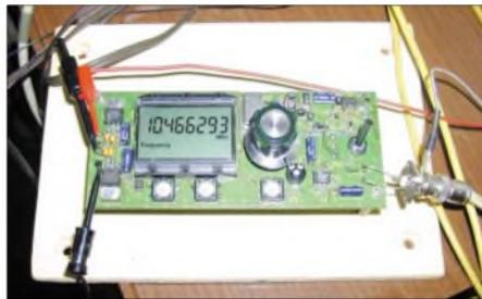
**Bild 3: DDS-Board im Versuchsstadium**
