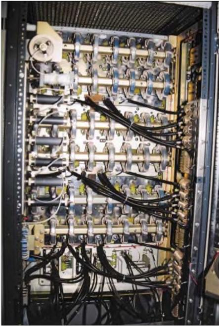
Rückansicht eines 19-Zoll-Gestells mit 48 Ringkern-Spulen zur Auskopplung
