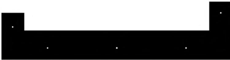
**Bild 12: Die Montageschablone ist aus einer 100 mm x 25 mm großen Platine herzustellen, M1:1.**
