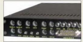
Die Rückseite des EzMasters bietet eine Fülle von Ein- und Ausgängen zur Verbindung von PC, TRX, Lautsprecher, Mike, Keyer, PTT-Taster und mehr.
