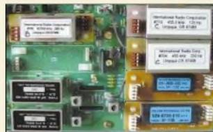
Die Ausrüstung des Yaesu-Transceivers mit hochwertigen Filtern der Fa. Inrad erfordert einige Überlegungen, um die neue Filterstruktur mit dem gegebenen Menükonzept in Einklang zu bringen.
