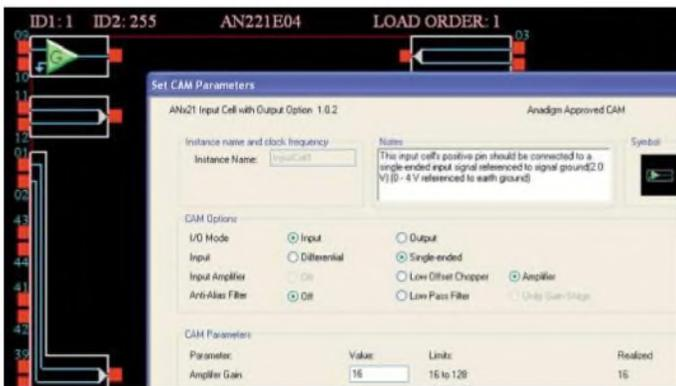
**Bild 10:** Die Eingangszellen des FFPA können in den unsymmetrischen Modus geschaltet werden.
