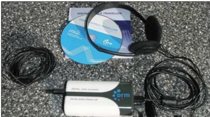
**Bild 1:** Antenne, USB-Kabel, Software und Kopfhörer sind neben dem Notebook alles, was auf eine Reise für DRM-Empfang mitzunehmen ist.
