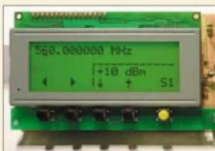
Das beste Gerät nützt wenig, wenn man nicht über seinen Zustand informiert wird und es nicht steuern kann. Für einen Signalgenerator wurde daher eine kompakte Einheit zur Anzeige und Bedienung des Geräts entworfen.
