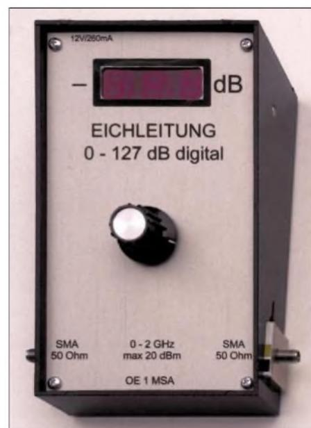
**Bild 1:** Die kommerziell hergestellte Dämpfungselemente werden mit der Steuerung in einem Pultgehäuse untergebracht. Sie lässt sich so ohne Schalt- und Rechenfehler bedienen.
