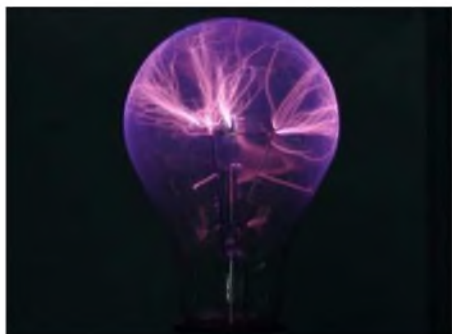
Bild 1: Eine 200-W-Glühlampe kann auch als Plasmakugel dienen.
