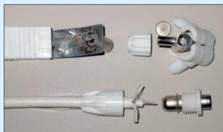
Bild 1: Abisolierung eines 75- \Omega -TV-Kabels für die Klemmontage in einem schraubenlosen Stecker (unten); darüber: IEC-Steckverbinder mit Schraubmontage Foto: DL2RD
