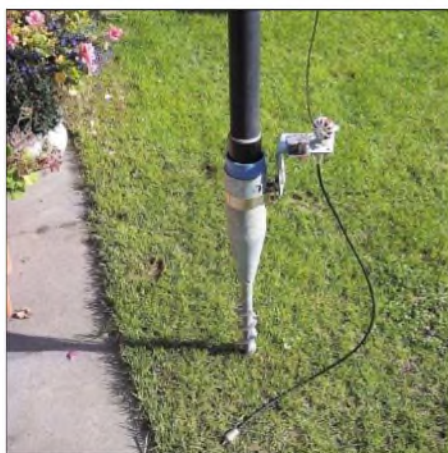
Bild 13: Ein Wäscheständerschraubfuß trägt Glasfaserantenne und Fuchskreis. Fotos: DF1EO
