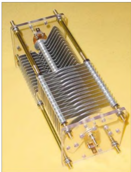
Bild 7: Doppeldrehkondensator zweimal 230 pF/4 kV Fotos: DK7ZB
