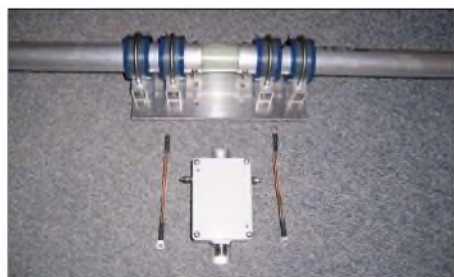
Bild 1: Montageplatte des Rotary-Dipols einschließlich Balun, noch demontiert
