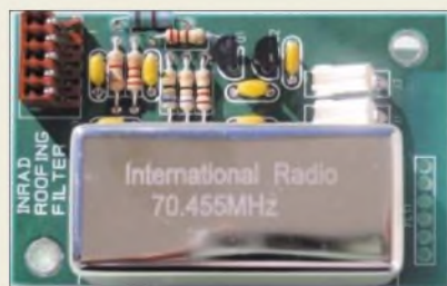
Das Roofing-Filtermodul ist im FT-1000MP leicht nachzurüsten.
