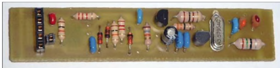
Der 80-m-Sender AS804a des AATiS für den Einsatz bei Foxoring-Wettbewerben. Foxoring ist vergleichbar mit einer Fuchsjagd, nur dass die Sender geringere Reichweiten haben, dafür allerdings die Standorte ungefähr bekannt sind. Der Sender ist mikrocontrollergesteuert und wird mit drei Mignon-Batterien (AA) betrieben.
