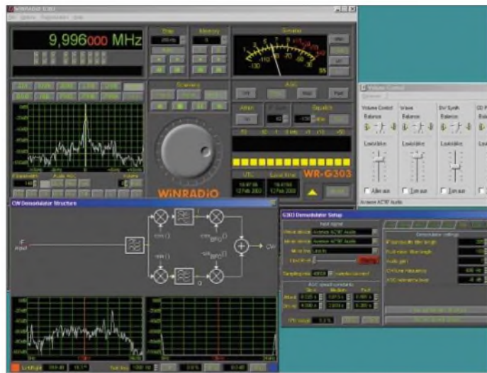
Bild 6: Der Professional Demodulator und seine Einstellmöglichkeiten
