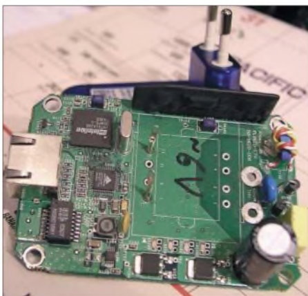
Bild 4: Innenansicht des PLC-Modems von Devolo Fotos: OE3MZC
