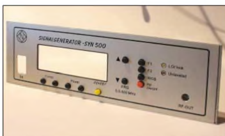
Bild 14: Fertig belichtete Alucorex-Frontplatte mit bereits montierten Tastern
