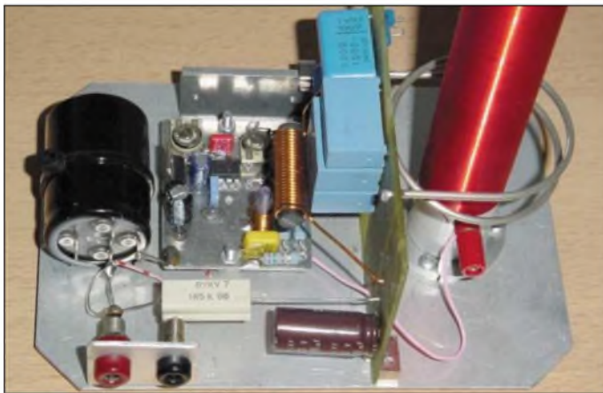
Bild 9: Detailansicht des Primärkreises beim Mini-Tesla
