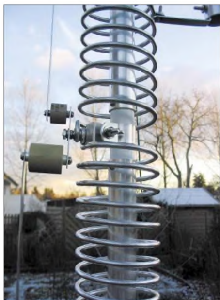
Bild 4: Detail Spulen mit Kondensatoren für 80 und 40 m
