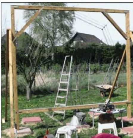
Ein Spinnengewebe der besonderen Art – die Langwellen-Loop von Uwe, DJ8WX
