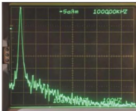
Bild 21: Zum Vergleich das Ausgangssignal eines Marconi 2019A bei 101 MHz
