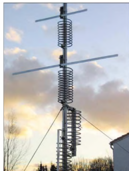
Bild 6: Spulen für 12 m und 17 m mit Dachkapazität Fotos: DL3VL
