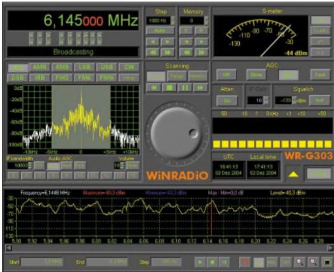
Bild 4: Programmoberfläche mit geöffneter Band-Scope-Anzeige
