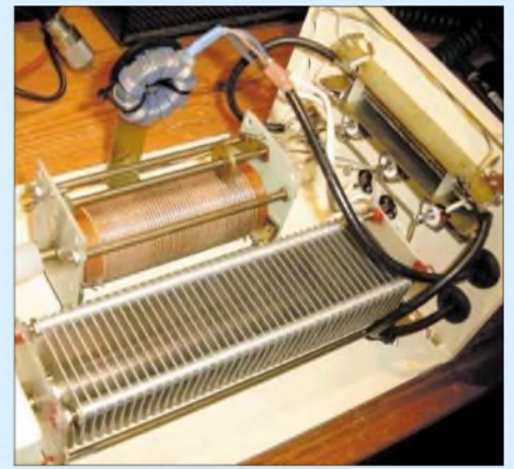
Bild 2: Zur Anpassung von KW-Antennen genügen, wie später gezeigt, bereits eine variable Kapazität und eine variable Induktivität.
