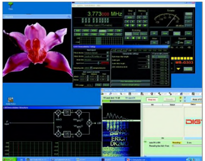
Bild 8: Professional Demodulator mit Echtzeit-Spektrogrammen; gemessen werden exakt 90° Phasendifferenz zwischen I- und Q-Signal.
