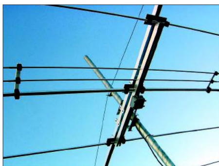
Bild 2: Strahlerzelle, von unten aufgenommen; erkennbar sind auch die Spreizer, mittels derer die 12- und 17-m-Parasitärelemente an die 20-m-Elemente gekoppelt werden.
