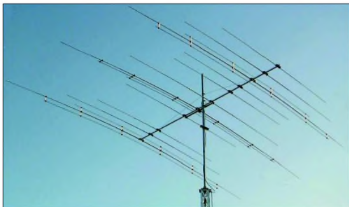
Bild 1: Die OB11-5 arbeitet auf allen fünf Bändern von 20 bis 10 m und kommt mit 6,10 m Boomlänge sowie 6,40 m Drehradius aus.
