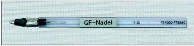
Bild 8: Die Kunststoffhülse über der Tastspitze dient als Verbiege- schutz.
