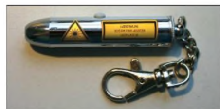
Bild 2: Laserpointer älterer Bauart gemäß Laserklasse 3A, heute nicht mehr zugelassen Foto: DL7UHU
