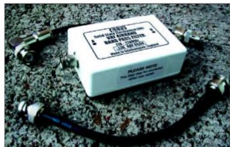
Bild 1: Flugfunk-Bandpassfilter mit Druckgussgehäuse und BNC-Buchsen Foto: Autor
