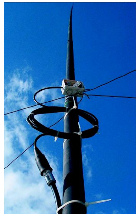
Bild 4: Vertikalstrahler am Glasfibermast; im Vordergrund die Mantelwellensperre aus 6,5 Windungen aufgewickeltem RG58, Rollen-durchmesser etwa 18 cm. Foto: DL2RD
