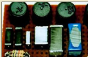
Die in diesem Beitrag vorgestellten steiflankigen CW-Filter mit Cauer- Charakteristik lassen sich mit Fertig- induktivitäten aufbauen – dadurch werden LC-Filter wieder attraktiv!
