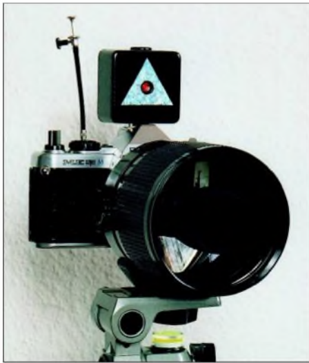
Bild 1: Der Lichtempfänger in der auf einem Stativ montierten Kamera ist mit dem aufgesetzten Sender fertig zum Betrieb.
