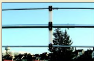
Nahaufnahme der bei der OB11-5 angewandten Spreizertechnik: So werden die 12- und 17-m- Parasitärelemente an die 20-m- Elemente angekoppelt.
