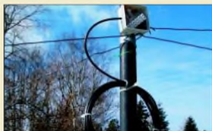
Die beschriebene Zweibandantenne weist bis auf die hier gezeigte Mantelwellensperre keine Induk- tivitäten auf und ist daher schnell aufzubauen.
