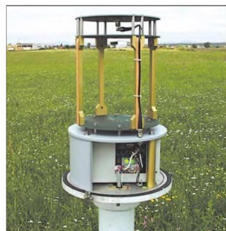
Bild 17: Geöffneter IMPACT-Sensor des Blitzortungssystems von ALDIS
