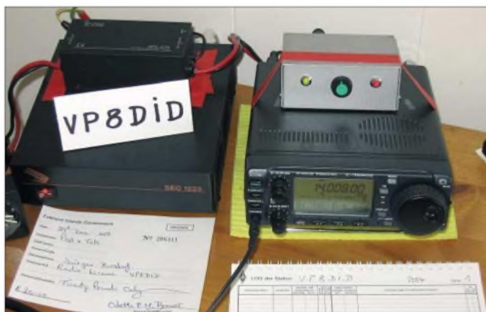
Der Arbeitsplatz von Jürgen, VP8DID, auf den Falkland-Inseln: IC-706 mit SG-237-Tuner
