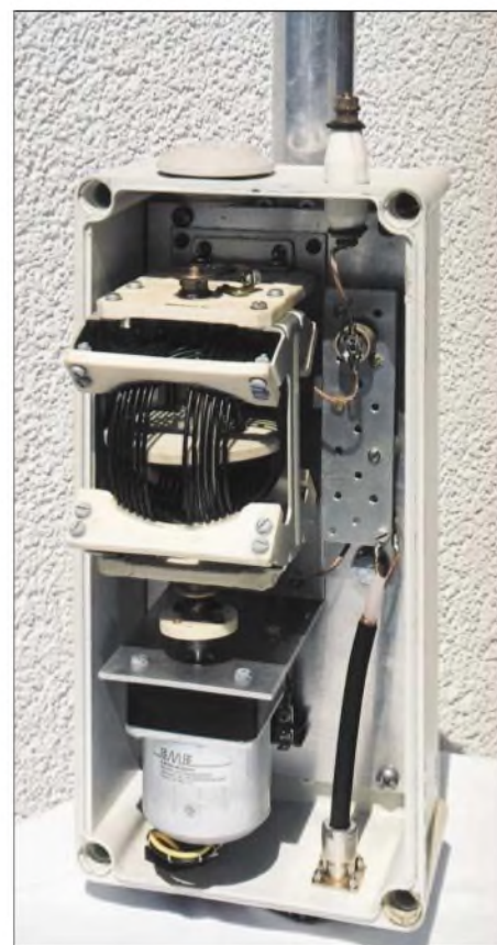
Bild 3: Innenansicht des Antennenkopplers, links unten Synchronmotor mit aufgeflosschem Reduktionsgetriebe, darüber die flexible, keramische Kupplung; links oben das Variometer, rechts davon das Lochblech für die Kondensatoren. Fotos: HB9PL
