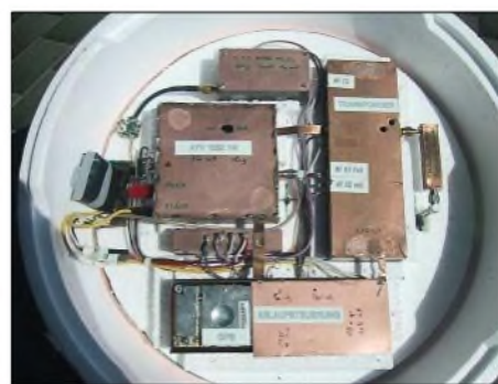
Die Montageplatte mit Sender, Transponder und Ablaufsteuerung
