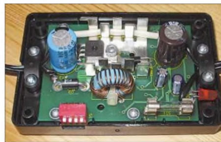
Bild 2: Innenansicht des SUW 12 Fotos und Screenshot: DL6MHW
