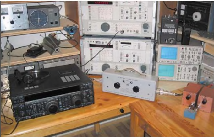
Bild 1: Funkstation OE3HKL mit Messaufbau zur Bestimmung des IP3 bei kleinem Spacing, Details siehe Text Foto: OE3HKL
