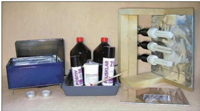
Bild 1: Komplette Ausrüstung zur Herstellung von Leiterplatten; (v.l.n.r.) Trockenofen, Fotoschale mit Chemikalien, Belichtungsgerät mit Bilderrahmen und Papierlayoutvorlage davor
