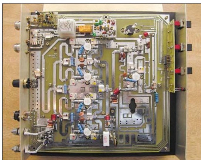
Bild 1: Der Blick in die geöffnete PA offenbart eine professionell aufgebaute und sehr sauber verarbeitete Platine. Durch die gewählte Platzaufteilung weicht die Gehäuseform vom klassischen „Ziegelstein“ ab.
