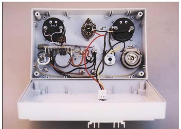
Bild 1: Versuchsgerät beim Entladen eines 3,6-V-Akkumulatorpacks
