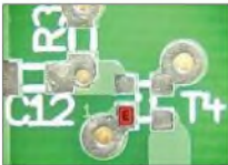
Bild 10: An dieser Stelle ist T4 einzulöten, siehe Text.
