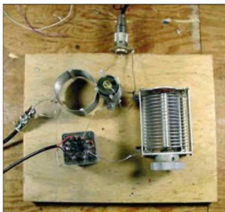
„Brettaufbau“ des einfachen Langwellen-Direktmischempfängers von John, W1TAG. Links oben die Zuführung des Oszillatorsignals, rechts daneben Diode und Trafo. Foto: W1TAG
