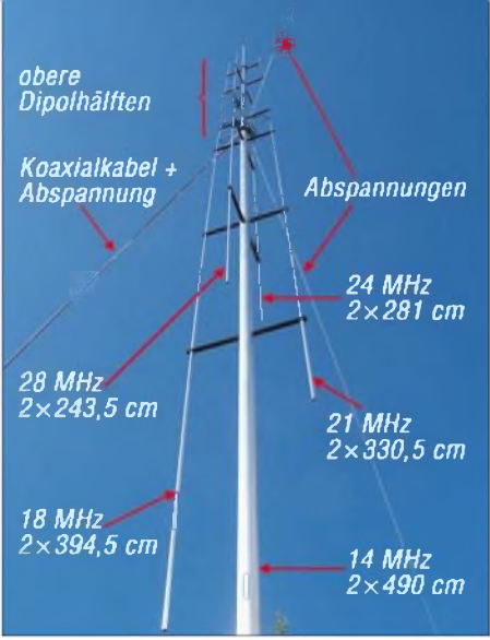
Bild 2: Antenne fertig aufgebaut; das Koaxialkabel verläuft entlang einer Abspannung schräg nach unten.
