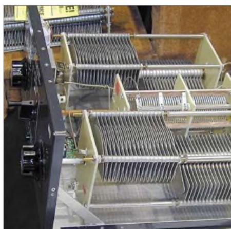
MFJ-975 – symmetrischer Antennenkoppler für 1,5 kW Sendeleistung Fotos: DL2FI (4), DK1BT (3)
