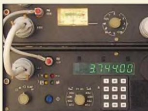
Der Beitrag beschreibt die Nachrüstung einer digitalen Frequenzanzeige und -eingabe für das SEG-100; er vermittelt ferner Anregungen zum Umbau anderer Surplus-Geräte.
