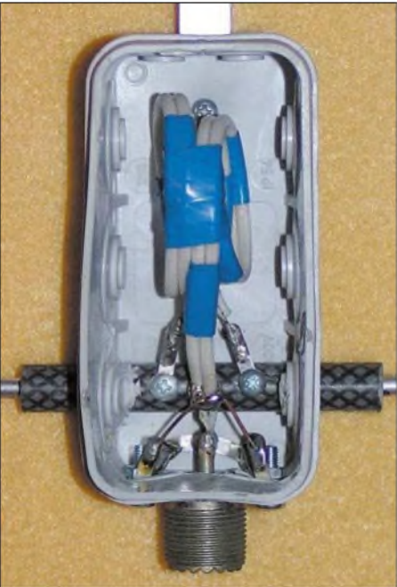
Bild 7: Dose der 12,5-Ω-Yagi mit 2 x 50-Ω-Teflon-Kabel
