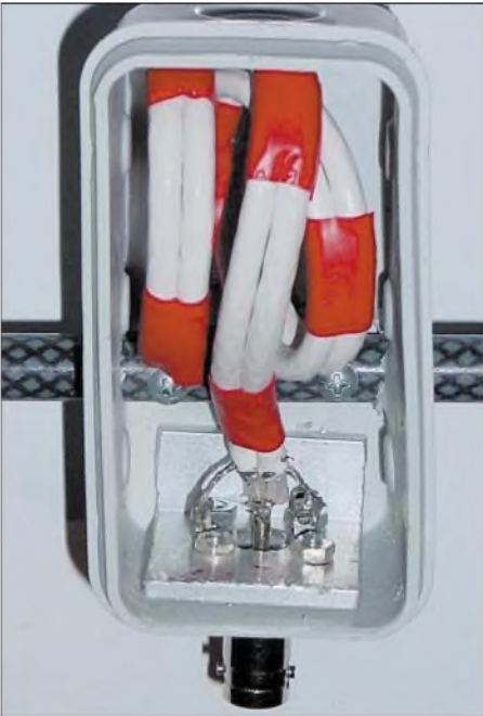
Bild 8: Dose der 28-Ω-Yagi mit 2 x 75-Ω-PE-Kabel
