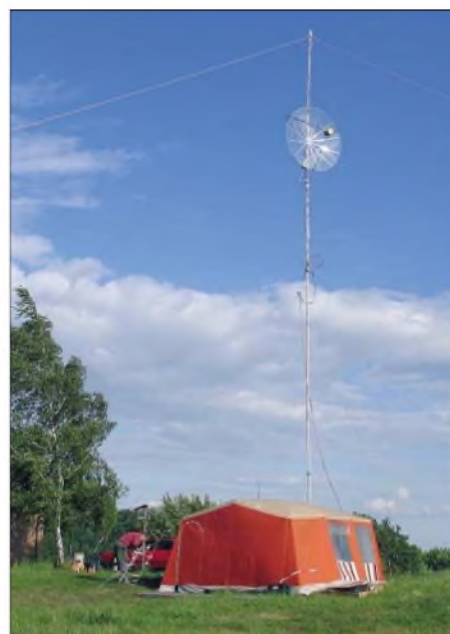
DF0YY: Der Monoband-23-cm-Gitterspiegel nach PA4FP. Der Durchmesser beträgt 1,90 m. Damit gelangen 64 QSOs im Juni-Contest bei einem ODX (im Regen) mit G3XDY. Foto: DL7AKC
