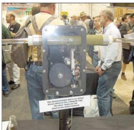
Die Antennen von SteppIR haben Elemente, deren Länge von µC-gesteuerten Schrittmotoren angepasst wird, sodass die Einzelstrahler bzw. Yagis zwischen 13 und 54 MHz arbeiten.
