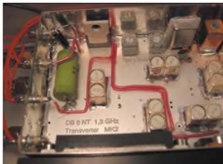
Bild 10: Transvertermodul mit eingelöteten Durchführungskondensatoren
