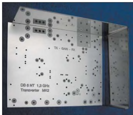
Bild 9: Leiterplatte beim Einpassen in eine Gehäusehälfte Fotos: DG9NCL
