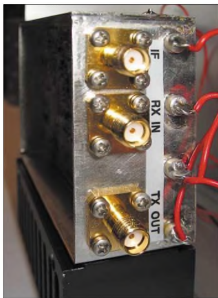
Bild 14: SMA-Buchsen und Durchführungskondensatoren an der Außenseite
