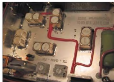
Bild 11: Bestückte Leiterplatte, links der Quarz mit Heizer, darüber die Bandfilter
