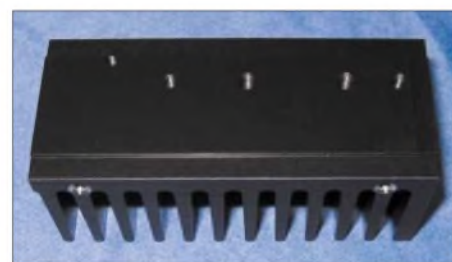
Bild 8: Der Kühlkörper wird fertig gebohrt geliefert.
