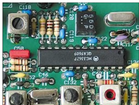
Bild 6: Ausschnitt aus der Hauptplatine. Der Bestückungsaufdruck und die ausführliche Baumappe erleichtern die schrittweise Bestückung.
