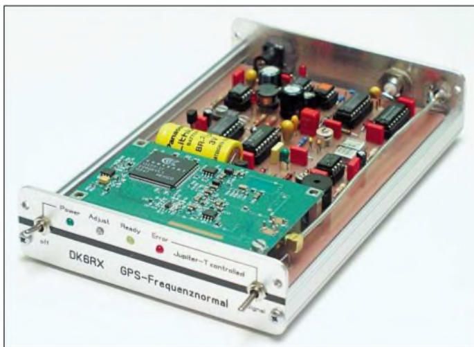
Bild 2: Das Herz des Frequenznormal besteht aus einem GPS-Empfänger.
