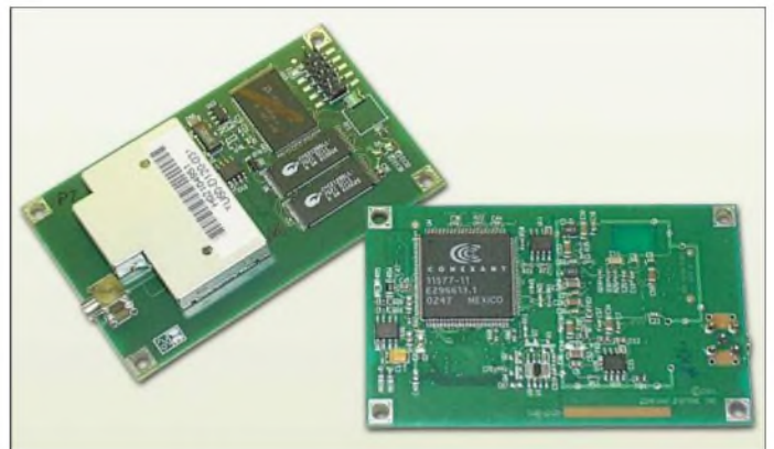
Bild 1: Die letzte Version einer der vielen Prototypen, die bei der Entwicklung für Tests und für die Optimierung des Frequenznormal aufgebaut wurde.
