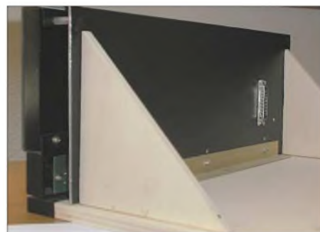
Bild 3: Das ausgebaute Anzeige- und Schalterpanel ist je nach örtlichen Gegebenheiten kippstabil zu montieren.
