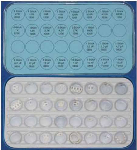
Bild 2: Sortierkasten 1 mit SMD-Bauelementen; die Legende erleichtert die Identifikation.
