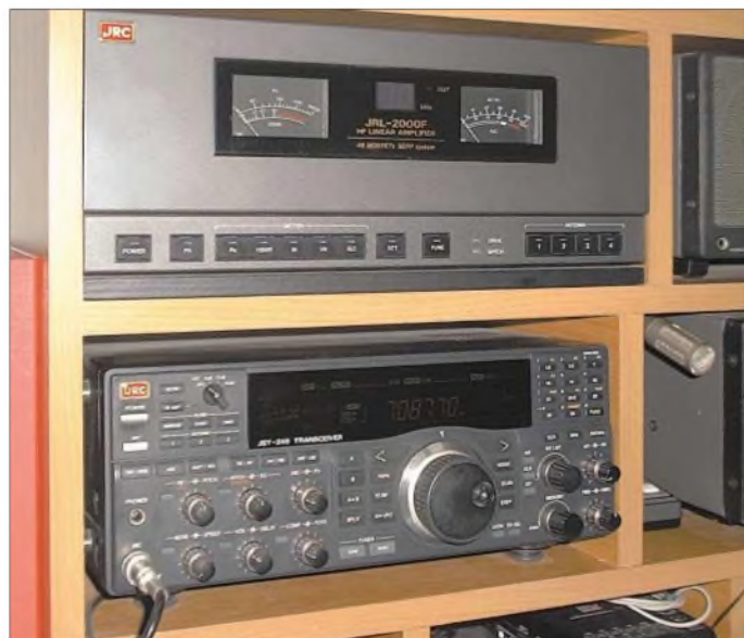
Bild 4: Nach dem Umbau befindet sich die Bedieneinheit direkt über dem Transceiver, während der Rest der Endstufe im Nachbarraum lautstark läuft.
