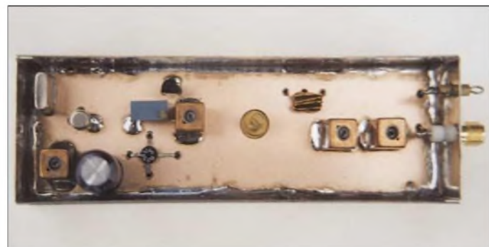
Bild 10: Quarzoszillator 116 MHz für 2-m-Transverter mit High-Level- Ringmischer [10]
