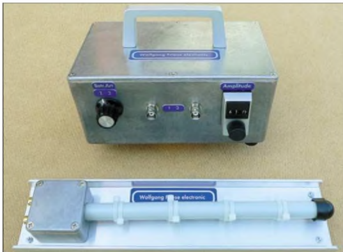
Bild 13: Ein robuster Messverstärker für den Feldeinsatz. Mit dem Umschalter links lässt sich das Übertragungsverhalten des Verstärkers zwischen linear und frequenzabhängig umschalten. Im letzteren Fall wird z.B. die Ausgangsspannung als Funktion der magnetischen Feldstärke der Messspule linearisiert.
