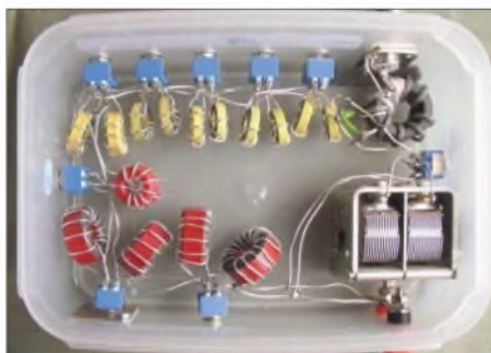
Bild 10: L-Antennenkoppler in Tiefpassschaltung, symmetrische Ausführung
