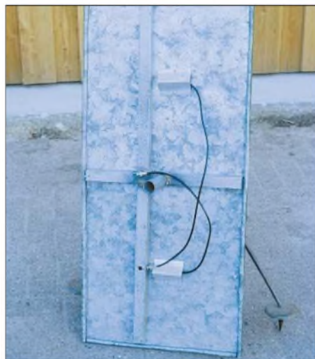
Bild 5: Unterseite der Blechplatte mit dem Kreuz aus Vierkantmaterial und dem Rohrstützen für die Aufnahme des Stativs
