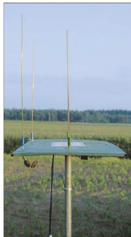
Bild 7: Das Ablesen der Peilung erfolgt von der Seite, d.h. entlang der zu den beiden Strahlern parallelliegenden Kante der Blechplatte. Fotos: DF7BL
