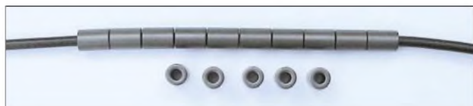
Bild 2: Ferroxcube-Ferritkerne auf RG58CU aufgezogen
