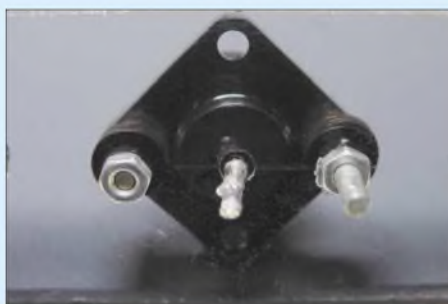
Bild 7: Der verlängerte Mittelstift der SO239-Buchse und die lang herausragende Schraube passen genau in eine Lüsterklemme.
