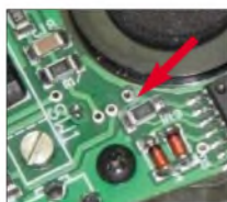
Bild 1: Die Leiterbahn vom IC2 in Richtung PTT-Anschluss ist direkt vor der Durchkontaktierung aufzutrennen.
