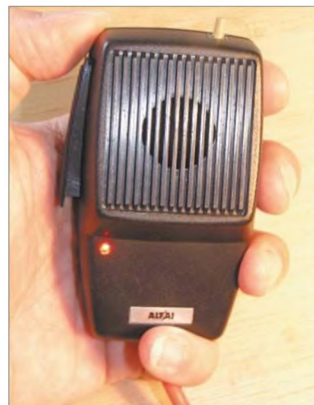
Bild 2: Modifiziertes CB-Mikrofon, rechts oben der Taster zum Start des Aktivsuchlaufes; deutlich zu sehen ist die rote LED zur Funktionsanzeige.
