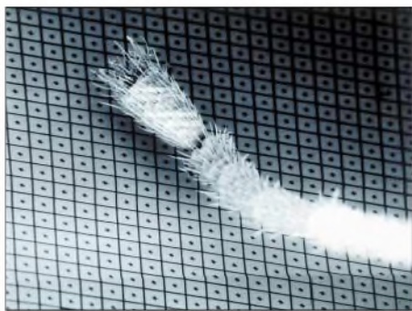
Größenvergleich der Spiegel eines DLP-Chips mit einem Ameisenbein
