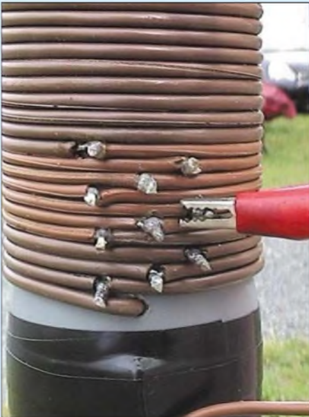
Bild 3: Anzapfungen an der Spule bestimmen die Resonanzfrequenz und ermöglichen auf allen Frequenzen ein SWV von nahezu s = 1.
