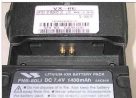
Massive Stiftkontakte verkraften die bis zu 1,8 A Stromaufnahme beim Senden problemlos.
