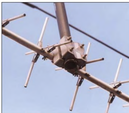
Bild 7: Hochwertige Kreuzungsklemme für eine stabile, rechtwinklige Montage
