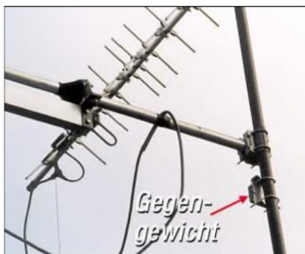
Bild 14: Gegengewicht der 13-cm-Antenne unterhalb der Kreuzungsklemme für die 2-m-Variante
