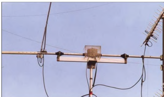
Bild 1: Gesamtansicht der Antennenanlage; die Enden aller Antennen wurden durch Verspannungen stabilisiert.
