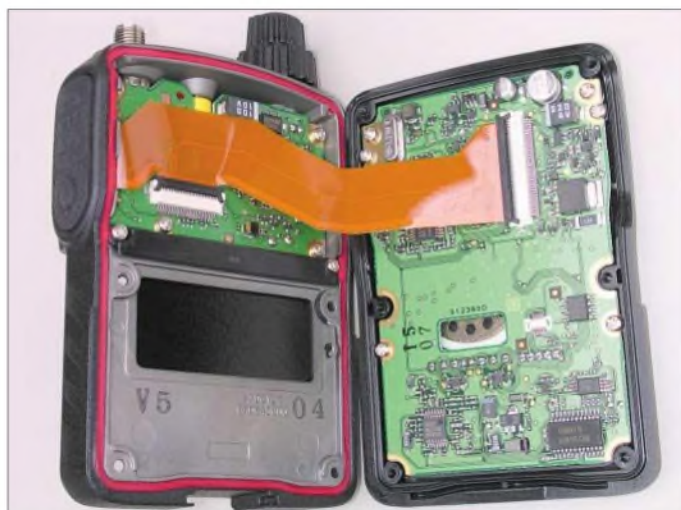
Ein verblüffend ungeräumiger Einblick: Im sehr aufgeräumten Innenleben findet nahezu der gesamte Analogteil links oben Raum in der Größenordnung einer Streichholzschachtel. Fotos: DG1NEJ
