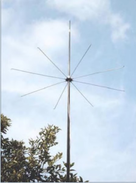
Bild 2: Die Dachkapazität ist eine sternförmige Anordnung aus Fahrradspeichen.
