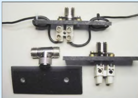
Bild 6: Bestandteile des Dipols auf einen Blick
