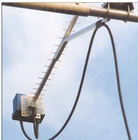
Bild 8: 13-cm-Antenne mit dem direkt dahinter befestigten 2400/144-MHz-Umsetzer
