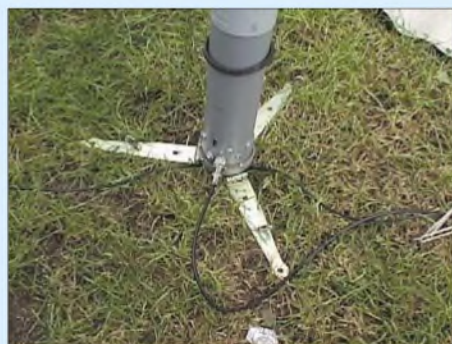
Bild 5: Der Antennenfuß besteht aus HT-Abflussrohren und Türscharnieren aus dem Baumarkt. Er fixiert die Angelrute mithilfe von Zeltnägeln fest am Boden.
