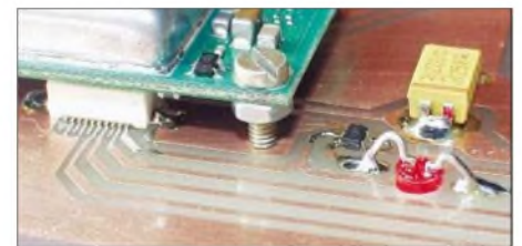
Bild 7: Einbau der LED und Montage der Platine des Jupiter-Pico-T Fotos: DK6RX
