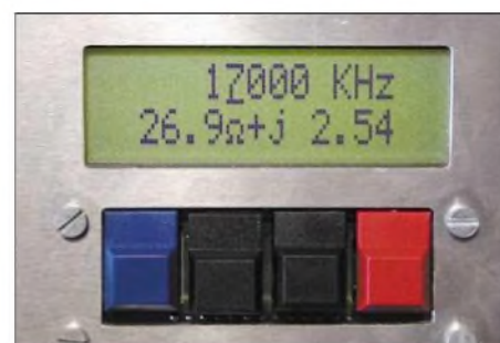
Bild 9: Messergebnis mit aktueller Frequenz, Real- und Imaginärteil
