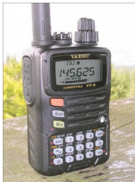
Komplett im Metallgehäuse präsentiert sich das vollausgestattete VHF-/UHF-Handfunkgerät VX-6E von Yaesu.
