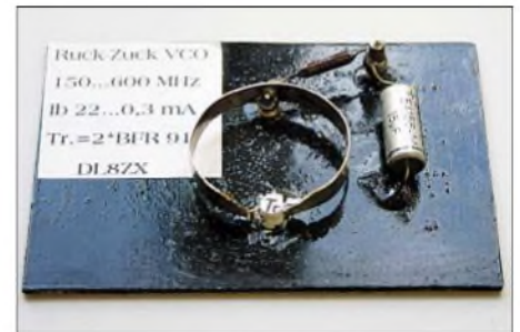
Bild 3: Probeaufbau eines Ruck-Zuck-Oszillators für den UHF-Bereich Foto: Red. FA
