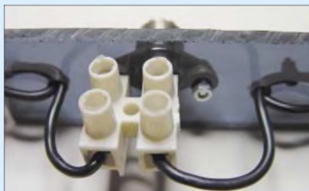
Bild 8: Die Lüsterklemme dient zur Kontaktierung der beiden Dipolschenkel.
