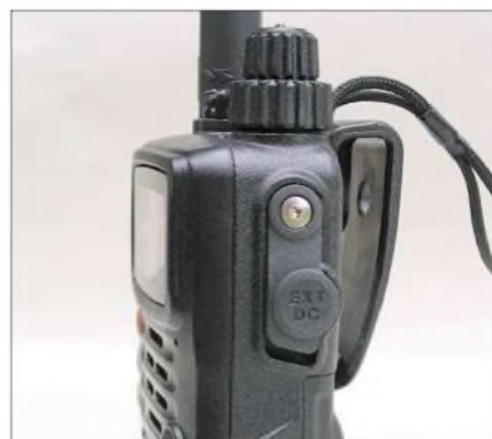
Über die abgedeckte Hohlstiftbuchse auf der rechten Seite kann das Gerät betrieben und der Akkumulator binnen 5 h geladen werden.
