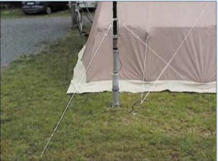
Bild 1: Drei kurze Spannleinen fixieren den Mast in 1 m Höhe. Eine weitere Abspannung ist nur bei Sturm nötig.
