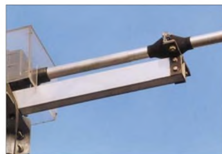
Bild 15: Durch Gummimanschetten ist ein Schutz der Pendelkugellager auf dem Entlastungsunterzug möglich. Fotos: DJ1YQ
