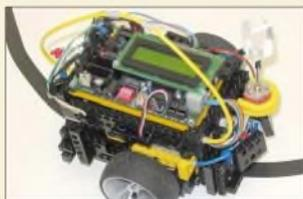
Autark agierende Kleinroboter lassen sich mithilfe einer universellen Steuerplatine leicht selbst aufbauen und programmieren. Foto: Mrkor
