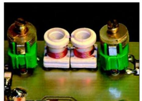
**Bild 2:** Bandfilter L11/C41, L12/C42 am Eingang des DDS-Nachverstärkers
