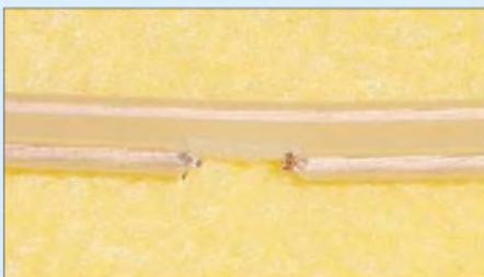
Bild 2: Die Unterbrechung des Leiters zwischen Viertel- und Halbwellenstück
