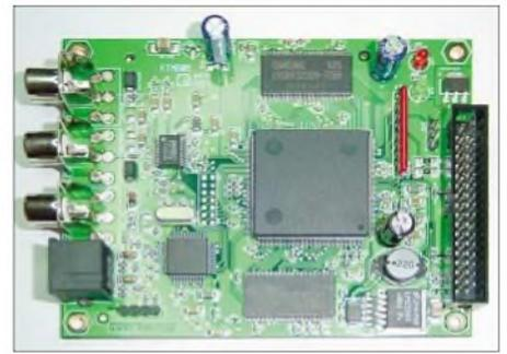
Bild 4: Kernstück des Platinensystems [4] – Video-/Audio-MPEG-Encoder
