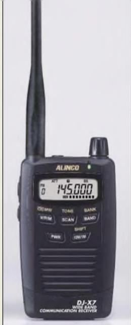
**Alincos Winzling im Scheckkartenformat deckt den Bereich von 0,1 bis 1300 MHz empfangsmäßig in AM, FM und WFM ab.**
