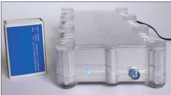
**Bild 1:** Vorderansicht des G313e mit Betriebszustands-LED und Einschalter
