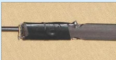
**Bild 6: Anschluss des Koaxialkabels am kalten Ende der Transformationsleitung beim 300-Ω-Kabel**
