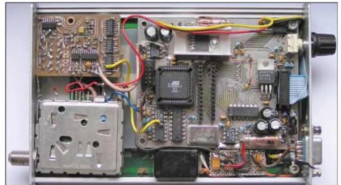
Der LCD-Controller ist das einzige Spezialbauteil. Es ist nicht im Einzelhandel, sondern nur beim Hersteller erhältlich. Epson hatte ihn unter der Typenbezeichnung SED1374 vor wenigen Jahren auf den Markt gebracht, dann aber in SID13704 umbenannt. Der pinkompatible Typ SED1375/SID13705 mit doppeltem Speicherplatz von 80 statt 40 kB sollte ebenfalls einsetzbar sein – sein zusätzlicher Adresseingang bleibt unbenutzt oder ist einzeln zu bedienen.
