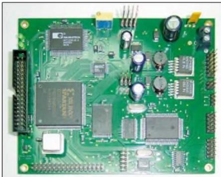
Bild 2: Basisboard mit zwei TStream-Eingängen [4] für die Minimalvariante nach Bild 1
