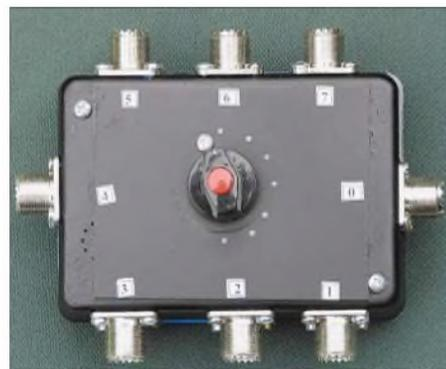
Bild 3: Labormuster mit sieben Schaltstellungen; das Kunststoffgehäuse ist vorn und hinten durch Aufkleben je einer Leiterplatte 10 x 8 cm<sup>2</sup> versteift worden. Fotos: DC9ZP
