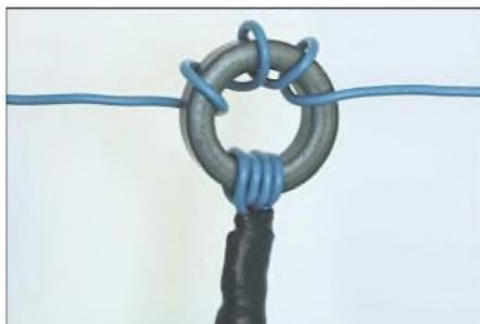
**Bild 5:** Durch die eher lose Strahlerwicklung lässt sich der Ferritringkern samt Koppelspule und Koaxialkabel beim Abgleich leicht verschieben. Foto: Red. FA
