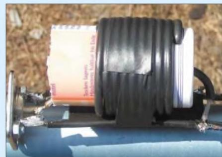
**Bild 10:** Ausführung der Speisedrossel bei einer 6-m-J-Antenne
