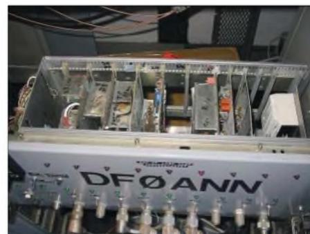
Das Grundgerät von DF0ANN; die Verstärker für die Endleistungen sind separat untergebracht.
