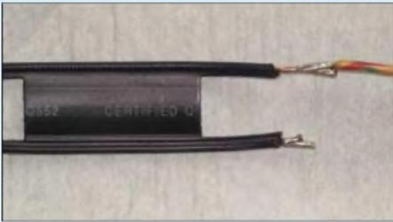
Bild 1: Übergang vom Viertelwellenstück auf den Strahler
