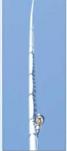
Die J-Antenne hat den gleichen Gewinn von 0 dBd wie ein normaler Halbwellendipol sowie ein identisches Strahlungsdiagramm. Die Bandbreite ist relativ hoch, Tabelle 1 enthält gemessene Werte für verschiedene Musteraufbauten.
