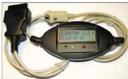
**Bild 13: komplett montierter Adapter im ovalen Gehäuse** **Fotos: Stange**
