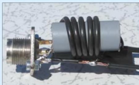
**Bild 9:** Speisedrossel für die 2-m-J-Antenne aus aufgewickelter RG174-Leitung
