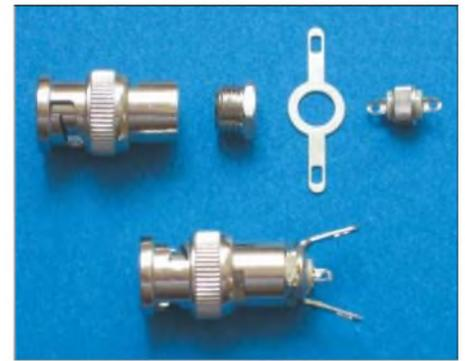
**Bild 5: Umbau von BNC-Steckern zu Messadaptern Foto: HB90J**
