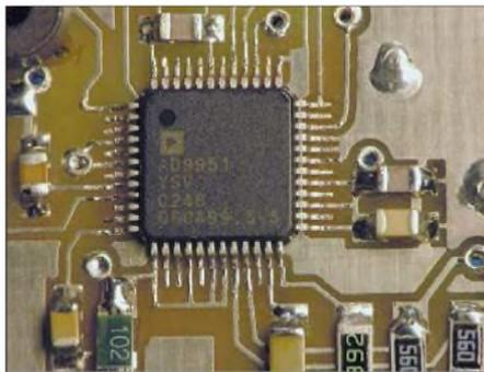
Bild 11: Der DDS-IC ist aufgelötet
