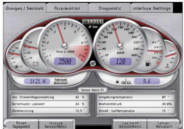
arbeiten, kombinieren und in Echtzeit anzeigen. Ein kleines Telemetriesystem ist mithilfe eines Car-PCs, Notebooks oder PDAs realisierbar. Viele Programmiersprachen sind dafür mehr oder weniger geeignet – Delphi oder C++ sind hier besonders beliebt.
