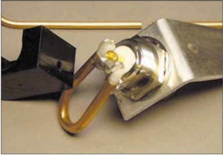
Bild 3: Montage des Baluns an der Dipolanschlussbuchse
