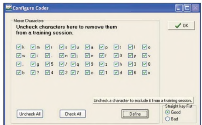
Bild 1: Der Morsetrainer von G4FON ermöglicht das Erlernen von Morsezeichen nach der Koch-Methode.
