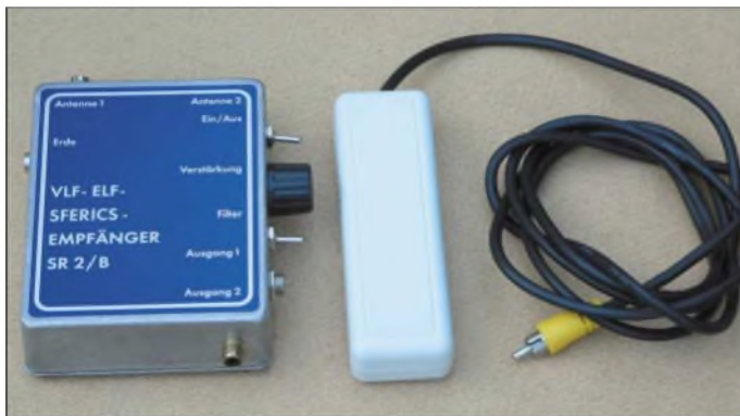
Bild 1: Die Kombination des Sfericeempfängers SR2/B und der Ferritantenne MASE 3 [4] erlaubt durch den Empfang der Sekundärfelder eine effiziente Längstwellenortung.
