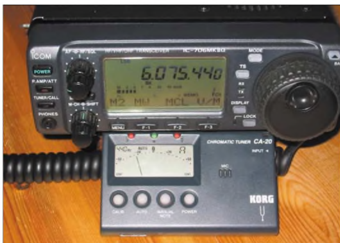
Bild 2: Differenzfrequenz- messung zwischen der Deutschen Welle als Referenzsender und dem Kammer- ton A
