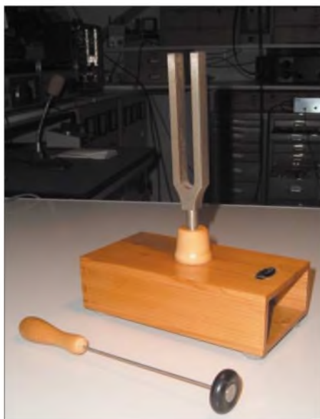
Bild 1: Stimmgabel für den Kammerton A mit Helmholtz-Resonator und Anschlaghammer
