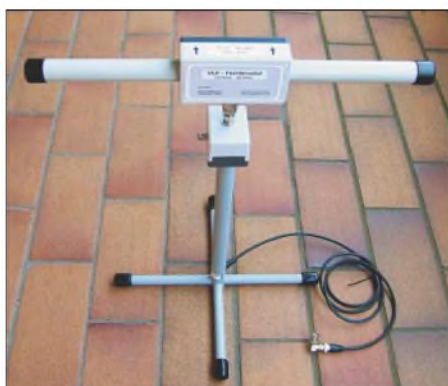
Bild 8: Power-Ferritmodul auf Ständer, auch für vertikale Montage.
