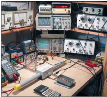
Bild 4: Test des Ferritmoduls; hier wird die reale Abbildung bei bedämpften Betrieb überprüft.
