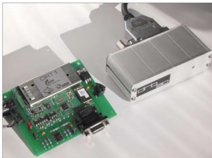
Bild 1: Zwei SDR-Plattformen – links DRT1 [9], rechts DRB 30 [10]
