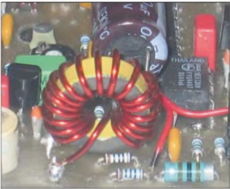
Bild 5: Schaltungsdetail Ringkernspule L3
