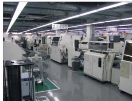
ICOM-Fertigungsline: Bestücken, Lötten, Löttest
