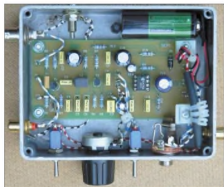
Bild 13: Innenaufbau des für die Messungen verwendeten Sfericsempfängers
