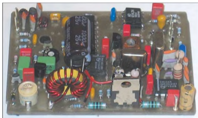
Bild 1: Fertig aufgebauter PLL-VFO, hier noch ohne Gehäuse
