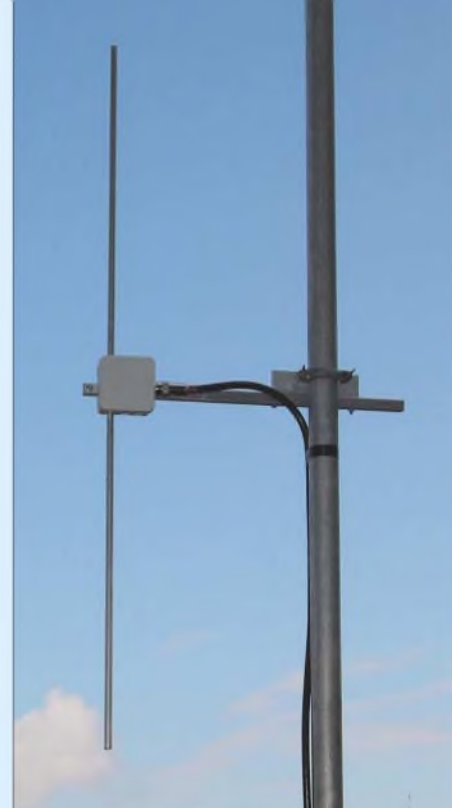
Bild 3: Fertiger Vormastdipol; alle Aussagen in diesem Beitrag beziehen sich auf vertikale Montage und Polarisation!
