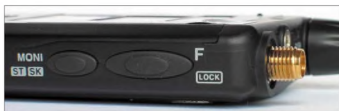
Bild 2: Auf der schmalen Oberseite liegen Buchsen für Antenne und Ohrhörer.
