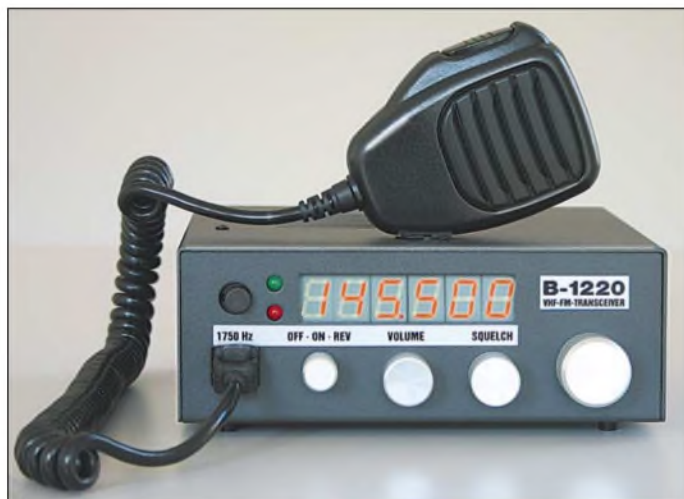
Dieser 144-MHz-FM-Transceiver aus dem Programm der Box 73 Amateurfunkservice GmbH soll bei einem Wochenendseminar in Ennepetal von Jugendlichen aufgebaut werden.
