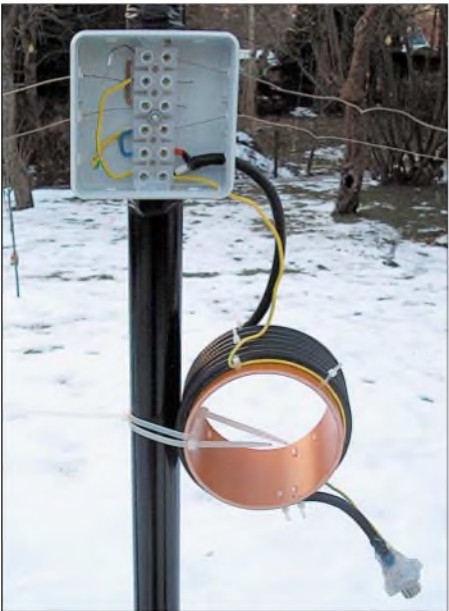
Bild 5: Anschlusskasten und Leitungsbalun; die Buchse gestattet Messungen direkt am Speisepunkt, d.h. nach dem Balun. Fotos: DL2RD
