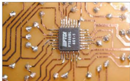
Bild 8: Einziger Wermutstropfen ist der SMD-IC FT232BL; ab Februar gibt es über den FA-Leserservice Platinen, wo dieser bereits bestückt ist. Fotos: DK4MX
