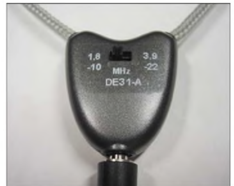
Bild 4: Antennenkopf mit Abstimm-diode und Verstärker. Abgebildet ist die neue Zweiband-Version (1,8 bis 10 und 3,9 bis 22 MHz), die erst nach Testende lieferbar wurde.
