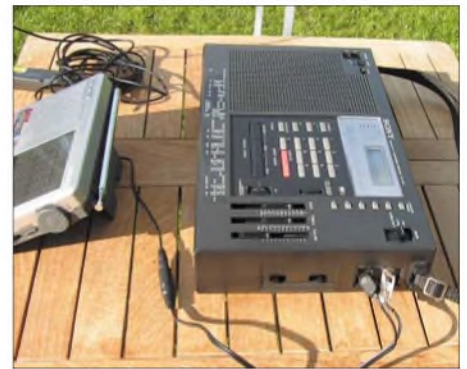
Bild 3: Zum Anschluss von Empfängern ohne Antennenbuchse gehört ein Adapter zur Einspeisung per Teleskopantenne zum Lieferumfang. Fotos: DJ1UGA (11); MicroConsult (1)
