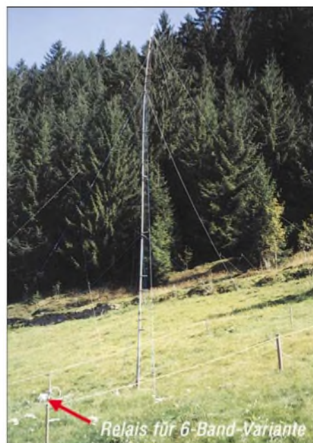
Bild 3: Gesamtansicht der 5-Band-Antenne inklusive der am Schluss des Beitrags beschriebenen Erweiterung für 40-m-Betrieb
