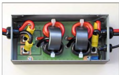
Das EMC-Filter in der Stromversorgungsleitung ist mit 115 × 55 × 45 mm 3 riesig.
