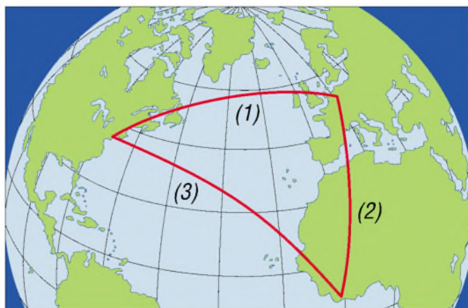
Bild 2: Auf der direkten Linie Berlin – New York (1) wird die MUF überschritten. Über den Umweg Afrika und der dortigen höheren MUF (2) kann die Welle seitengestreut (3) ihr Ziel erreichen.
