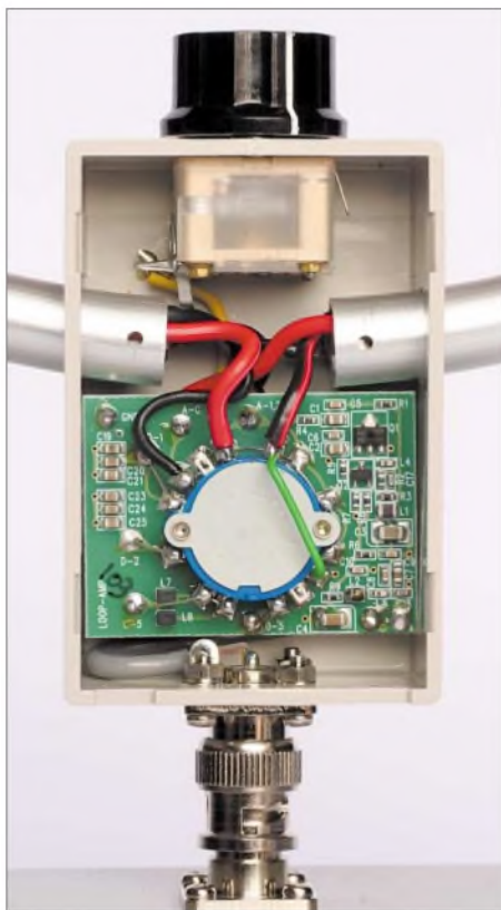
Bild 3: Im Gehäuse am Fußpunkt des Empfangsrahmens liegen der Drehkondensator und der 20-dB-Verstärker.
