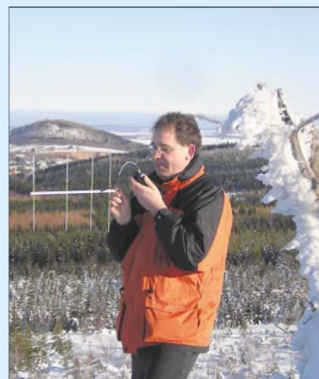
Bild 12: Durch Einsatz einer kleinen Yagi, die abzüglich Kabel- und Steckerverlusten noch einen Antennengewinn von G_{\text{Ant, isotrop}} = 5 auf dem 70-cm-Band aufweist, werden aus den 2 W Sendeleistung des Handfunksprechers 10 W EIRP.
