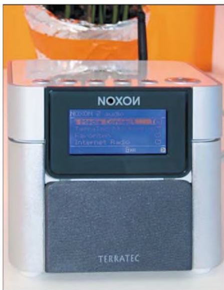
TerraTecs Noxon Audio empfängt Internet-radio ohne Computerhilfe.
