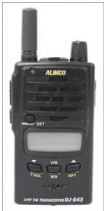
Bild 1: Alincos neuer Duobander DJ-S45 CQ für PMR446- und LPD-Sprechfunk. Hier die Variante mit Kurzanntenne.
