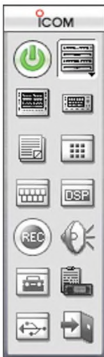
Bild 4: Bei der Bedienung von IC-PCR1500 und IC-R1500 per PC ist diese Werkzeugleiste der Ausgangspunkt, um etwa die Bedienoberfläche aufzurufen oder den Digitalrecorder manuell zu starten.
