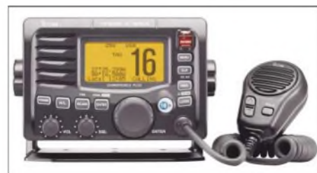
Moderne VHF-Seefunktransceiver, wie der Icom IC-M504, senden auf Knopfdruck ein DSC-Notsignal mit den Schiffsdaten.
