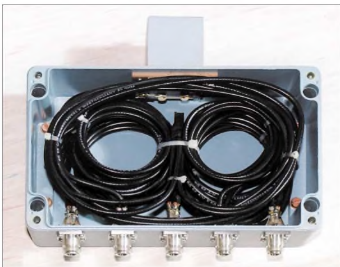
Bild 5: Blick in einen geöffneten Splitter/Kombinierer
