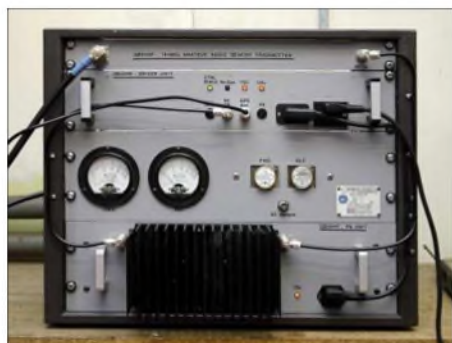
Die Sendeeinheit von GB3VHF
