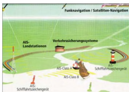
AIS dient primär zur automatischen Identifizierung von Schiffen auf See. Zusätzlich empfangen Landstationen die Funktelegramme zur Überwachung des Schiffsverkehrs entlang der Küste. Grafik: BMVBW
