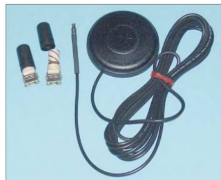
Bild 2: Als Antennen eignen sich aktive oder passive Geohelix- oder Patchtypen.
