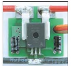
Bild 3: Die zur Sensorplatine führenden Leitungen sind großflächig aufzulöten, wobei die Masseleitung nicht zu unterbrechen ist.
