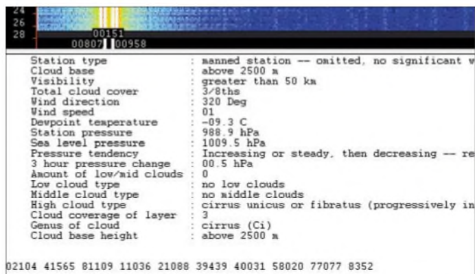
Bild 5: Im Synop-Modus wandelt SkySweeper codierte Wettertelegramme von Bodenstationen in Klartext.
