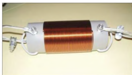
Bild 16: Ansicht einer Verlängerungsspule mit Plastrohr als Wickelkörper Foto: OE5CWL
