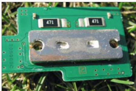
Bild 1: Detailaufnahme des Kühlblocks mit den eingelöteten Transistoren
