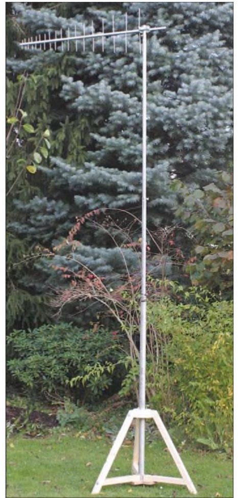
Bild 4: Das Holzstativ im ersten Einsatz
