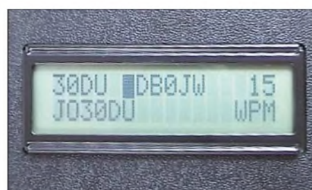
Bild 8: Decodierter Text der auf dem 2-m-Band empfangenen Bake DB0JW
