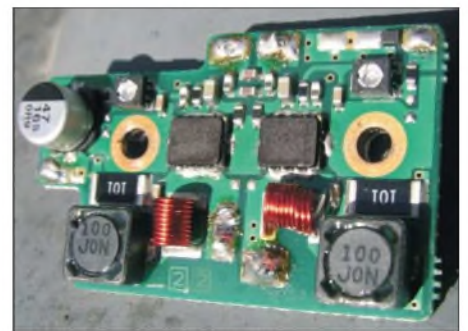
Bild 2: Die gesamte FT-817-Endstufenplatine final unit misst nur 2 cm x 4 cm. Fotos: OE3MZO
