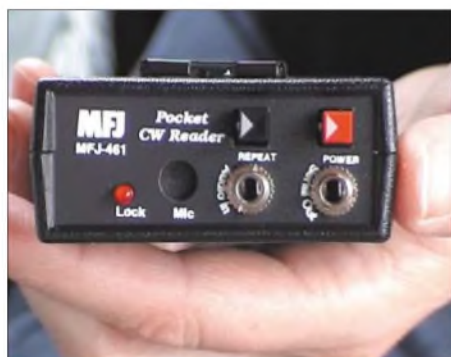
Bild 4: An der Gerätestirnseite befinden sich der Ein-/Aus-Schalter für das Gerät sowie der Taster REPEAT; ferner die Klinkenbuchse für den externen NF-Signaleingang und eine zur Textanzeige auf einem Computer.
