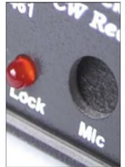
Bild 3: Die Detailaufnahme zeigt das Bohrloch im Gehäuse, hinter dem sich das eingebaute Mikrofon befindet.
