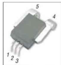
Bild 5: Ansicht und Pinbelegung des Stromsensors
