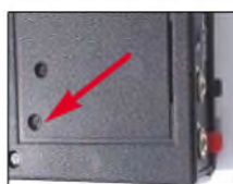
Bild 5: Am Trimpotenzio- meter auf der Geräte- unterseite ist die Eingangsfrequenz im Bereich von 500 bis 1000 Hz einstellbar.
