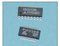
Bild 3: Der PW0268 im Vergleich zu einem normalen SMD-Schaltkreis.
