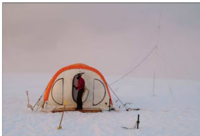
Das Zelt von „OP A“ mit dem Vertikaldipol für 12 und 17 m
