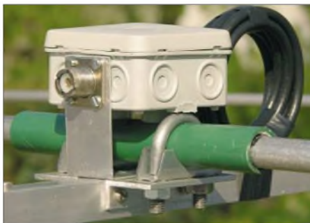
Bild 4: Strahlermittelstück mit aufgerollter Speisedrossel
