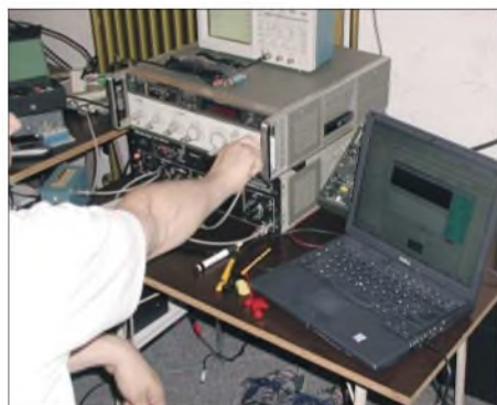
Bild 6: Die beiden Signalgeneratoren zur Messung des Großsignalverhaltens
