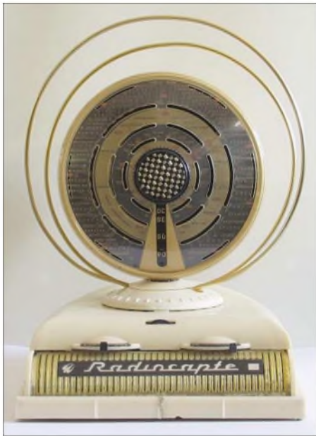
Der Radiocapte ist ein Superhet zum Empfang der Kurz-, Mittel- und Langwelle und wurde Mitte der 50er Jahre in Frankreich gebaut.
