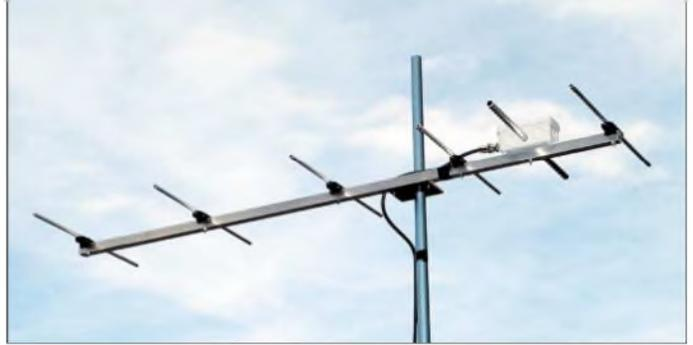
**Bild 4: 6-Element-70-cm-Yagi beim Portabeinsatz**
