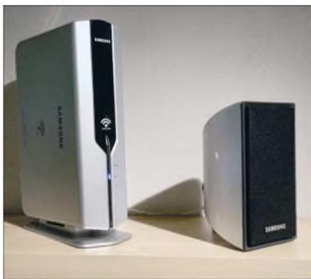
Ein ebenfalls digital auf 2,4 GHz arbeitendes Funksystem bietet Samsung an, um so die lästige Strippenzieherei bei Dolby-Digital 5.1 zu reduzieren; hier der Empfänger und eine der beiden Surround-Rear-Boxen.
