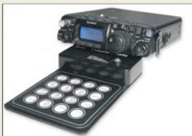
Mit dem neuen **Externen Keyboard** für **FT-817, -857 und -897** lassen sich häufig benötigte Funktionen bequem erreichen, ohne durch Menüs hangeln zu müssen. Das für 149 € erhältliche, 100 x 50 x 23 mm<sup>3</sup> große Keyboard kommt an die CAT-Buchse des Funkgeräts und wird von dort mit Spannung versorgt. **Bezug: WiMo GmbH, Am Gäxwald 14, 76863 Herxheim, Tel. (07276) 96680, Fax 6978, [www.wimo.com](http://www.wimo.com), [ir.fo@wimo.com](mailto:ir.fo@wimo.com)**
