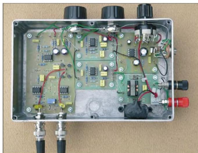
**Bild 14:** Innenansicht des für die Versuche verwendeten Empfängers, links die UPA INAw [7] Fotos, Screenshot: DG9WF
