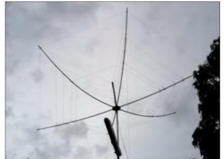
Der 5-Band-Hexbeam an einem ausgedienten Laternenmast
