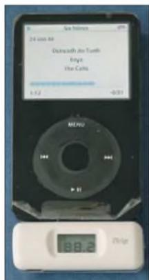
Statt 50 mW nur 50 nW und damit legal: der in Deutschland seit kurzem zugelassene UKW-Sender *iTrip* an einem *iPod Video*
