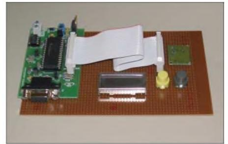
Durch ein- bzw. zweimalige Integration der Beschleunigung werden beim Projekt von Mario Forner die Geschwindigkeit eines sich bewegenden Objekts und die zurückgelegte Wegstrecke berechnet.
