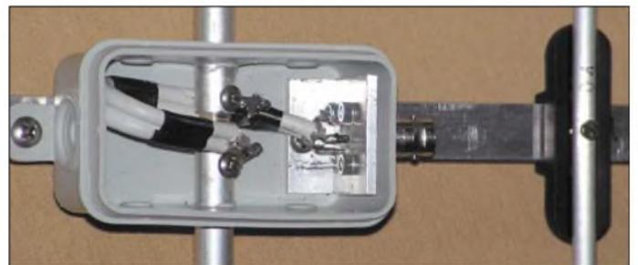
**Bild 2:** Innenansicht der Strahlerdose bei einer 70-cm-Yagi
