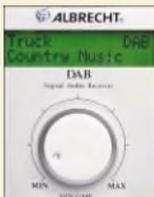
Dieser neue Kombiempfänger demoduliert terrestrisches Digitalradio nach dem Eureka-147-Standard (DAB) und analogen FM-Hörfunk mit RDS. Der Beitrag stellt das preisgünstige Radiogerät vor.
