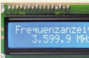
Digitalskalen für Superhetempfänger erfordern zum Teil noch die Eingabe von Konstanten, um korrekte Anzeigewerte zu erhalten. Die hier vorgestellte Variante ermittelt den gewünschten Wert hingegen selbst.
