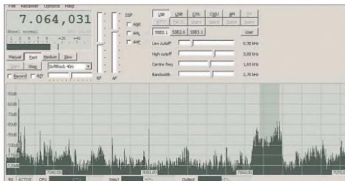
**Bild 12: Nutzeroberfläche des SDR-Programms von M0KGGK; Beispiel mit dem SoftRock V. 5.0 aus dem SSB-Teil des 40-m-Bandes**
