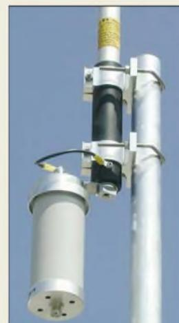
Herzstück der für den Einsatz unter eingeschränkten Platzverhältnissen vorgesehenen Vertikalantenne ist der Anpasstransformator.
