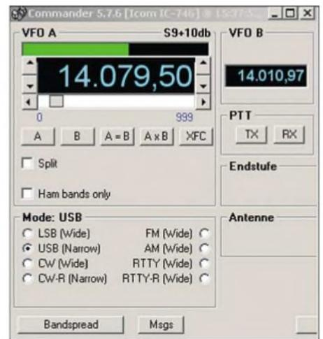
Der Commander steuert bis zu vier Transceiver. Per Maus und Tastatur lassen sich Frequenz, Mode, Filter und VFO wählen. Das Erfassungsfenster zeigt außerdem die relative Empfangsfeldstärke.
