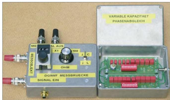
**Bild 13:** Impedanzmessgerät für Erd- und Baumantennen [7]
