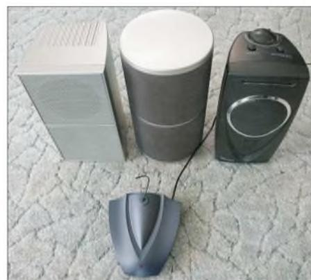
Drei untereinander kompatible Funklautsprechermodelle von Tevion (bei Aldi erhältlich), die oberhalb 863 MHz in FM empfangen und davor ein dazu passender Sender; die lange Leitung am Sender ist die Stromversorgung, die Antenne ist der kurze Drahtkabel oberhalb. Bei den Empfängern ist die Antenne im Inneren der Lautsprecher versteckt und von außen nicht sichtbar.
