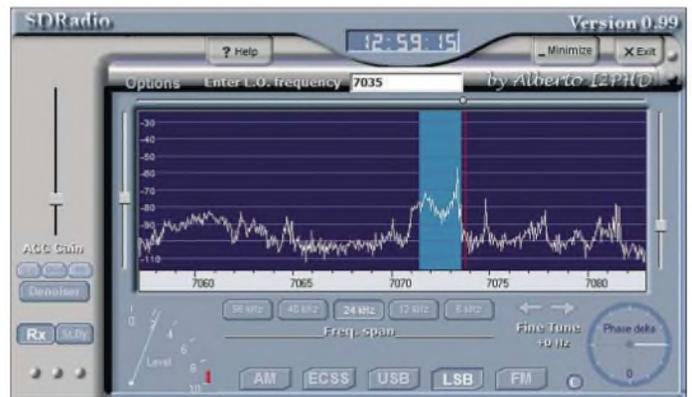
**Bild 13: Betrieb des SoftRock V. 5.0 mit dem Programm SDRadio**
