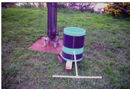
Die Langwellen-Ladespule nach dem bewährten Motto „je größer desto besser“
