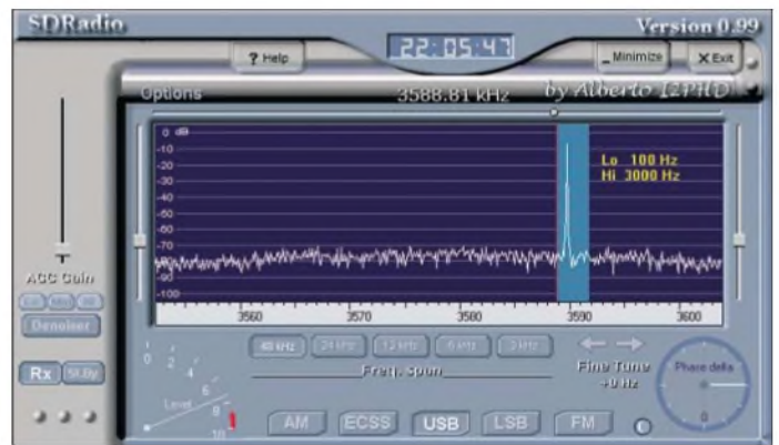
Bild 7: SDRadio- Empfangsbeispiel für einen unmodulierten Träger
