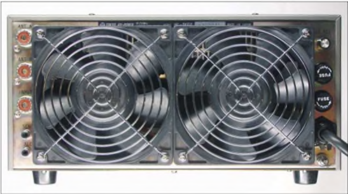
Bild 6: Rückansicht der Linear-Endstufe HL-2KFX. Den meisten Raum nehmen die beiden großzünftig dimensionierten Ventilatoren ein. Links bzw. rechts sind die Anschlussbuchsen und Sicherungseinsätze erkennbar.
