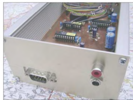
Bild 3: Blick auf die Rückseite des Peilers
