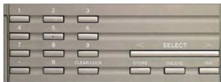
Bild 4: Frequenzen lassen sich per Zehner-tastatur direkt eingeben.
