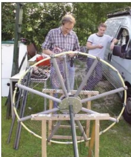
**Die kapazitive Dachlast der Langwellenantenne von PA4VHF/p**
