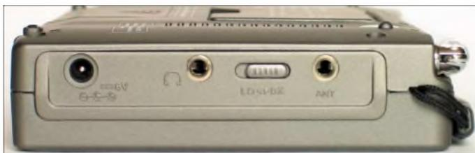
Zum Empfang etwa von Amateur- und Wetterfunkstationen aktiviert die SSB-Taste den Einseitenbandempfang mit BFO, den das seitlich aus dem Gehäuse ragende Einstellrädchen auf optimale Verständlichkeit trimmt. Der E5 wählt das zur Betriebsart passende Filter nicht automatisch, sodass man bei SSB-Empfang per seitlichem Schieber die schmale Bandbreite manuell schaltet. Der Lautstärkepegel ist in 32 Schritten über zwei Drücker auf der Frontseite einstellbar.
