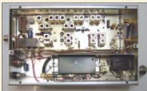
Baubeschreibungen für derartige Umsetzer waren wegen der prinzipbedingt notwendigen Doppelumsetzung bisher selten; SMD ermöglicht nun den Aufbau auf einer 148 x 55 mm<sup>2</sup> großen Platine – hier ein Aufbau mit Mitsubishi-10-W-Modul Foto: DF5SL
