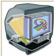
Der Depthcube z1024 realisiert die 3D-Darstellung durch das Projizieren des Farbbilds eines Beamers auf ein Feld aus 20 hintereinander gestaffelten LCDs.
