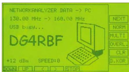
Bild 27: Displayanzeige während des Wobbels mit PC-Unterstützung
