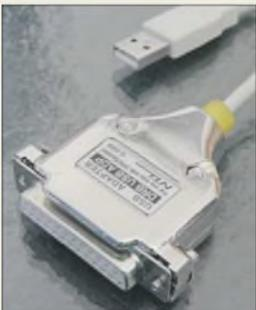
Der USB-Adapter kommt an die rückseitige Sub-D9-Buchse des DRB30.
