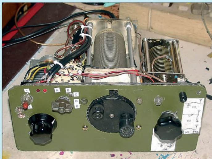
Bild 2: Blick in das Z-Match mit dem SWV-Meter aus einem konventionellen Richtkoppler Fotos: DL8OL
