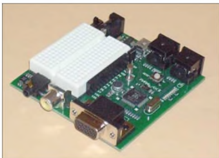
Bild 1: Das Development-Kit ist fertig aufgebaut und erlaubt den Anschluss von Tastatur, Maus und VGA-Monitor oder TV-Gerät.
