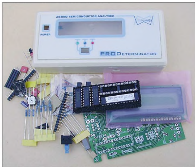
Bild 6: Deutlich mehr Komfort bietet der als Bausatz erhältliche Transistor- Analysator [1], der sich in etwa 1 h zusammenbauen lässt.
