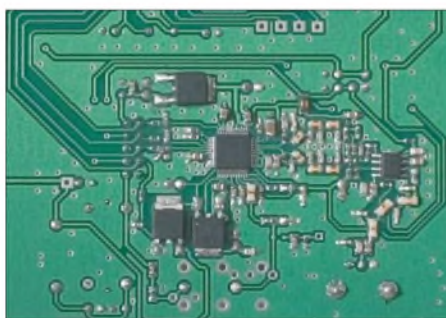
Bild 2: Detailansicht der werkseitig bestückten Platineunterseite, etwa in der Mitte der 48-polige DDS-IC, rechts daneben die Aliasfilter, ganz rechts Endverstärker-IC, darunter Ausgangstiefpass
