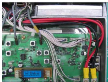
Bild 1: Der FT-847, Unterseite geöffnet, oben rechts der einzig mögliche Platz für den Einbau der beiden Filter und des Relais. Die roten Kabel müssen dazu zunächst abgeklemmt werden.
