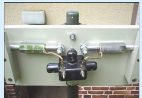
Bild 3: Fertig montiertes Mittelstück; es durch zwei Rohrschellen mit Gummieinlagen am Tragemast befestigt. Fotos: DL4OBP
