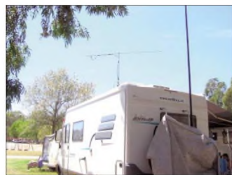
Wie viele andere DXpeditionäre arbeitete auch SV/OE6IWG/p mit einer Neunelement-Tonna. Fotos: OE6IWG
