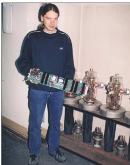
Techniker Arne Schenk mit einem 1-kW-Verstärkermodule; rechts daneben einige der ehemals verwendeten Sendetrioden SRW 357
