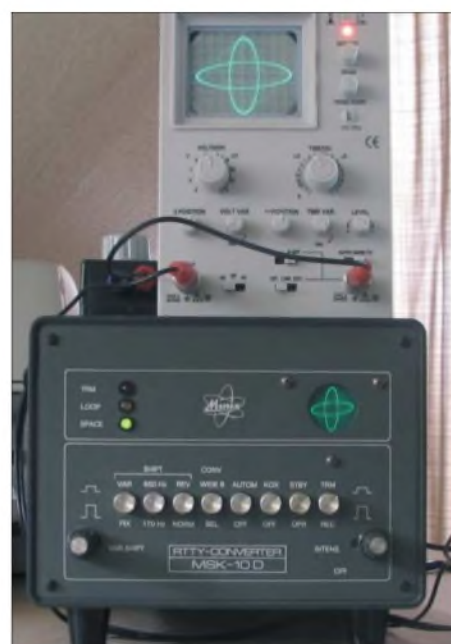
Bild 4: Unten der MINIX-Konverter mit der 3-cm-Oszillografenröhre, darüber zur Kontrolle eine Oszillografenanzeige. Die Abstimmung ist richtig, wenn X- und Y-Achse der Ellipsen senkrecht aufeinanderstehen. Schaltbilder einer Oszillografenanzeige und des DJ6HP-Konverters findet man in [8]. Der Konverter wurde auf die neuen AFSK-Töne abgeglichen. Fotos: DC9ZP
