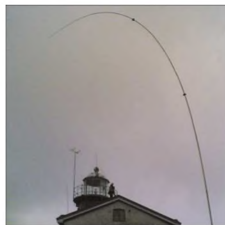
Unsere durchgebogene Vertikalantenne für das 80-m-Band im tosenden Sturm Fotos: OH0BH
