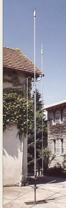
Fertig errichtete Antenne sowie unterer Rohrsteckaufbau mit Einspeisung und abgleichbereiten Fußpunktschaltungen
