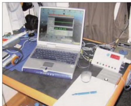
Blick ins Wohnmobil-Shack bei SV/OE6IWG/p. Am eingeschalteten DTR und dem auf dem PC laufenden WINMDS-DSP sieht man, dass das Foto während eines HSCW-Skeds gemacht wurde.
