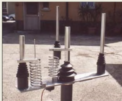
Fertig errichtete Antenne sowie unterer Rohrsteckaufbau mit Einspeisung und abgleichbereiten Fußpunktschaltungen
