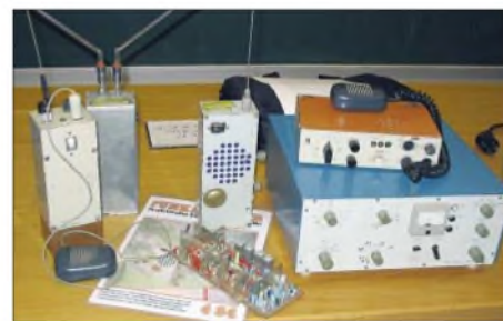
Teil der Geräteausstellung zur Festveranstaltung: hinten links der legendäre S23-Handfunksprecher mit „Geweiht“ (FA 2+4/80), daneben 2-m-Geräte mit 600-kHz-ZF (FA 12/83 ... 4/84), rechts unten 150-W-PA zum 10-Band-KW-TRX ML-77 (FA 11/78 ... 4/82).
