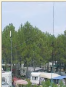
Das Bild zeigt eine EH-Antenne für 20 m neben der Referenzantenne, einem 14-MHz-Vertikal-dipol.
