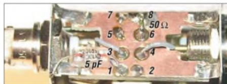
Bild 9: Platine mit quer liegendem PDC-20-1BD und 50- \Omega -Referenzwiderstand vom Anschluss 6 gegen Masse. Für höchste Richtschärfe ist ein Kapazität von etwa 5 pF von Stift 1 nach Masse erforderlich.
