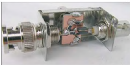
Bild 5: Nach Einlöten der bewickelten Ferritperle ist die Messbrücke betriebsbereit, ein Deckel mit Beschriftung komplettiert sie.
