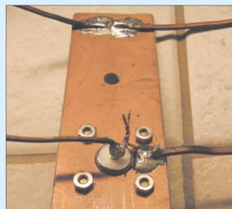
Bild 2: Trägerplatte mit Reflektor (hinten), Strahler und N-Buchse; der verdrehte, lack-isolierte Kupferdraht dient zum Feinabgleich auf bestes SWV.
