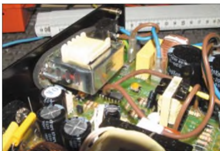
Bild 3: Um Platz im Schaltnetzteil zu schaffen, wurde die Netzdrossel an die Rückwand des Gehäuses verlegt.
