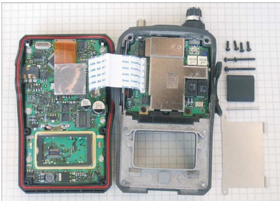
Das Innenleben: Links Steuerplatine mit unten sichtbarem Optionssteckplatz, rechts der „Rest“ – die beiden Sende-Empfänger...
