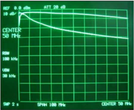
Bild 4: Verstrkung des Testaufbaus 0 bis 10 MHz (oben) und 0 bis 100 MHz (unten) mit REF = 50 dB Gain
