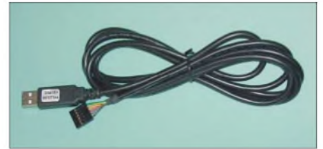
Bild 7: Bei diesem USB-Kabel ist im Stecker alles zur Umsetzung von USB auf RS232-TTL-Signale enthalten.
