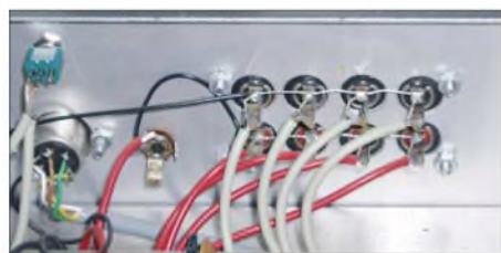
Bild 2: Verdrahtung der Cinchbuchsen in der Steuereinheit
