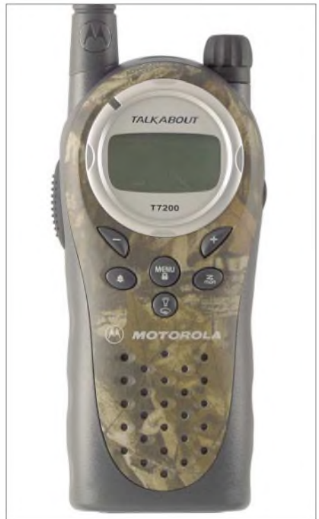
Bild 2: Motorolas Talkabout T7200 [3] sieht aus wie ein PMR446-Funkgerät, ist aber für FRS programmiert.
