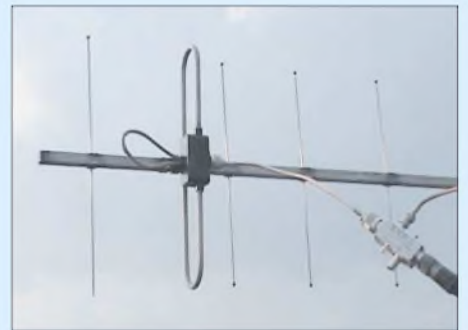
Bild 5: Zur Entkopplung wird das kurze Stück Koaxialkabel von der Antenne zum Richtkoppler etwa waagerecht weggeführt. Sein direkter Anschluss an die Antenne ist wünschenswert, aus Platzgründen jedoch nicht möglich. Fotos: Autor
