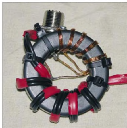
Bild 2: Praktische Ausführung des Baluns
