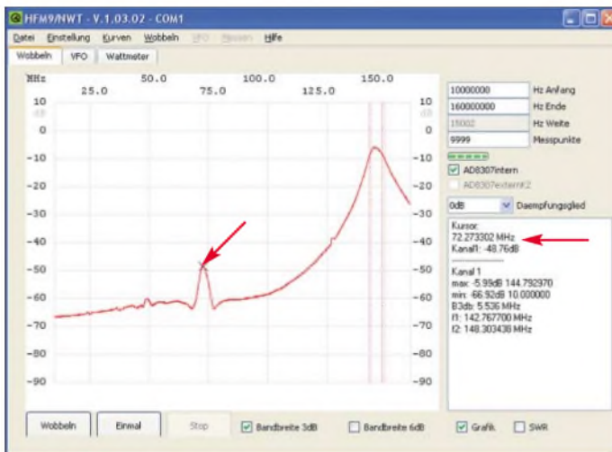
Bild 1: Die Steuerung der Wobbelndurchläufe ist über das entsprechende Arbeitsblatt möglich. Alle aufgenommenen Messwerte werden grafisch ausgegeben – einzelne Messwerte lassen sich per Cursor ermitteln.
