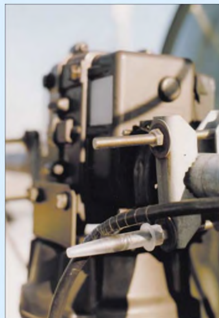
Die Plastikhülse schützt auch eine etwas zu kurz geratene Koaxialleitung vor dem Durchscheuern. Foto: Autor
