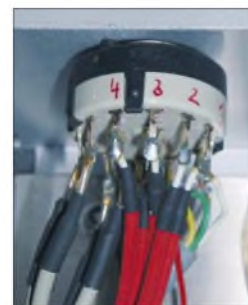
Bild 8: Relativ eng geht es am Drehschalter zu. Doch die abgeschirmten Kabel lassen sich mit etwas Geschick trotzdem gut anlöten.
