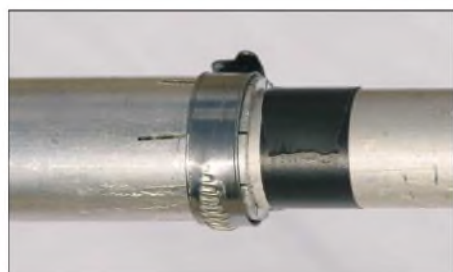
Bild 5: Die verschiebbaren Rohrübergangsstücke mit der Schlauchschelle
