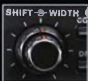
DSP in der ZF: Bandbreite und Shift einstellbar
