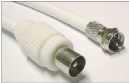
Bild 9: Koaxialstecker (IEC-Norm) und F-Stecker in der TV-/Sat-Technik (75 Ω)
