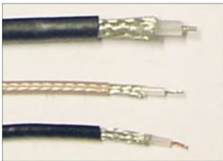
Bild 4: Übersicht verschiedener 50-Ω-Koaxialkabel, v.o.n.u. RG58C/U, RG316/U, RG174U
