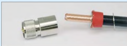
Bild 7: Nach dem Kürzen des Abschirmgeflechts sollte es etwa so aussehen.
