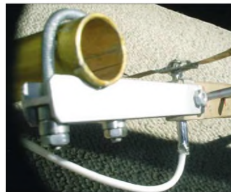
Bild 3: Detailansicht von Antennenhalterung, Mastschelle, Dipol mit Symmetrierung und Koaxialkabel sowie Ende des Booms aus anderer Perspektive Fotos: DJ1UR
