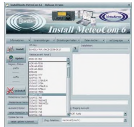
Bild 2: Der Wetterdecoder steuert fast alle gängigen SSB-Empfänger.
