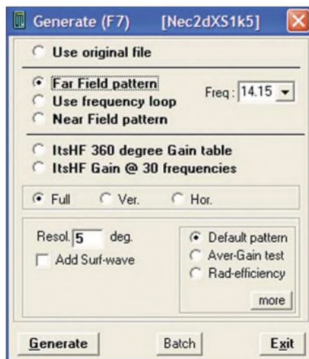
Bild 7: Auswahlmenü Generate (F7) zum Start der Simulationsrechnung; es kann unter anderem zwischen der Berechnung des Fernfelds, dem Durchlauf eines vordefinierten Frequenzbereichs und der Berechnung des Nahfelds gewählt werden. Generate (links unten) startet die Berechnungen.
