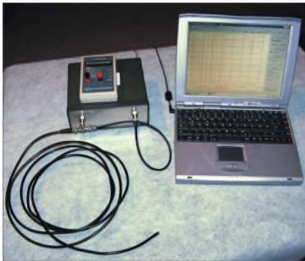
Bild 1: Messaufbau mit NWT und LC-Meter sowie Laptop
