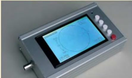
Der vorgestellte Antennenanalysator, für den sich ein Bausatz in Vorbereitung befindet, zeichnet sich durch eine hohe Messgenauigkeit – auch beim Phasenwinkel – aus, wozu u. a. das angewandte selektive Messverfahren beiträgt. Dank eigenen Grafikdisplays arbeitet das Gerät völlig unabhängig von einem PC.
