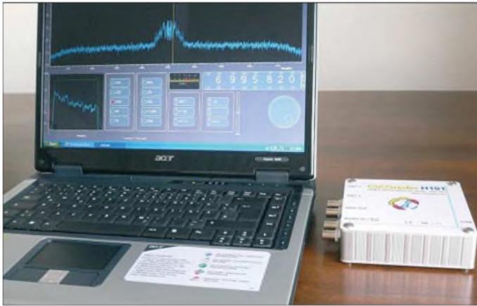
**Bild 1:** CIAO Radio mit Programmoberfläche
