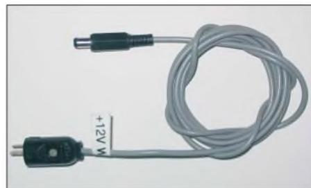
**Bild 4: Beschriftung mittels Labelprinter für gerätespezifische Kabel**
