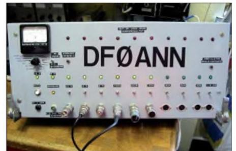
Basisstation der Bake, die Koaxialkabel ab 9 cm sind im Dachboden des Turmes nahe am Antennenfuß untergebracht, um die Leitungsdämpfung zu minimieren. Alle Frequenzen sind an einen Quarzthermostaten mit sehr hoher Genauigkeit über eine PLL angebanden. Fotos: DL8ZX
