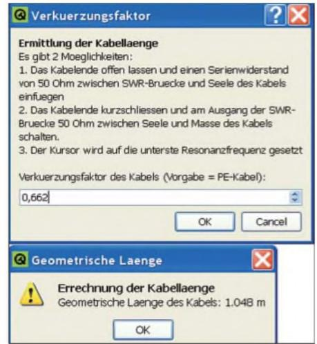
Bild 4: WinNWT berechnet entweder aus VF die mechanische Kabellänge oder aus diesen den Verkürzungsfaktor.
