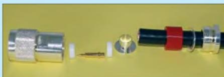
**Bild 18:** Mutter, Druckscheibe und Dichtung sind zuerst aufzufädeln.
