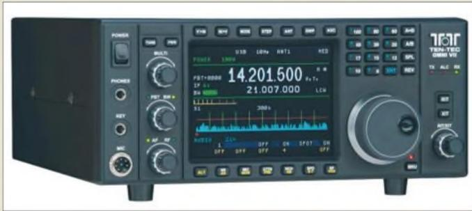
Der neue KW-Transceiver OMNI-VII von Ten-Tec lässt sich erstmalig komplett über das Internet fernsteuern.
