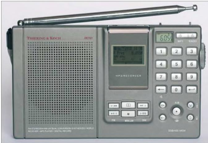
**Bild 1:** Der Thieking & Koch DE1121 ist das erste Reiseradio mit integriertem Digitalrecorder und Speicherverwaltung per Computer.
