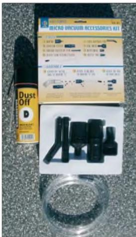
**Konventionelle Druckluftdose, links, und nur doppelt so teures, dafür aber mehrmals verwendbares PC-Staubsauger-adapterset, rechts**
