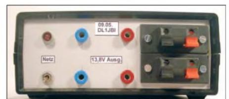
**Bild 2: Stromversorgung mit zwei zusätz-lichen Doppelklemmen** Fotos: DL1JBI
