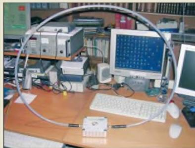
Die aktive schleifenförmige Breitbandantenne **L-101** ist für den Einsatz zwischen 0,1 und 30 MHz vorgesehen. Ihre Schleife weist einen Durchmesser von 60 cm auf; diese kann zum Transport einfach zu einem nur noch 25 cm messenden Ring aufgerollt werden. Die Antenne bedarf keiner Abstimmung und besitzt zwei entkoppelte BNC-Ausgänge, an die zwei Empfänger ohne gegenseitige Beeinflussung anschließbar sind.
