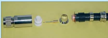
Bild 32: Der Mantel des Ecoflex muss auf 7 mm entfernt werden. Fotos: Fa. Kusch
