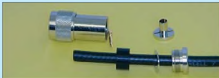
Bild 39: Wie gehakt, sind Mutter, Druckring und Dichtung aufzuschieben.
