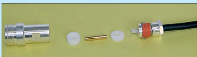
Bild 50: Vor dem Zusammenbau die zweite Scheibe aufstecken.
