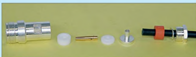
Bild 46: Zur Buchse gehören zwei Isolationsscheiben.
