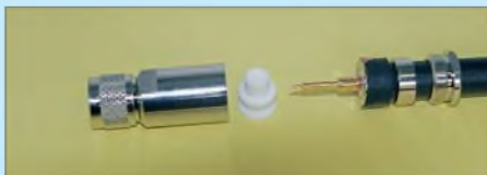
Bild 35: Beim Aufstecken des Innenstifts müssen alle Adern von ihm gefasst werden.
