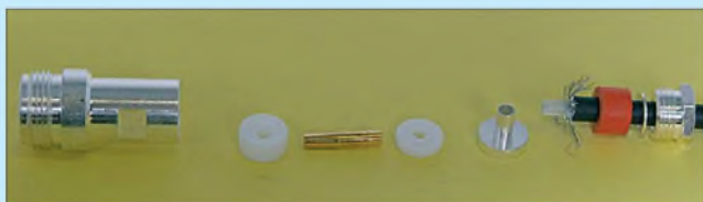
Bild 49: Nach dem Aufstecken der ersten Scheibe den Innenstift festlöten.
