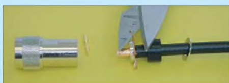
Bild 41: Schere oder Seitenschneider leisten beim Kürzen des Geflechts gute Dienste.
