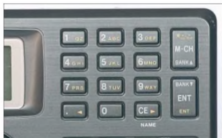
Bild 5: Frequenzen lassen sich per Zehner-tastatur eingeben oder aus einem der 1000 Speicherplätze abrufen.
