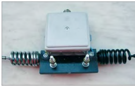
Bild 2: Von den Strahlerenden führen zwei Drähte in den Kasten. Fotos: DL8ZX (2)
