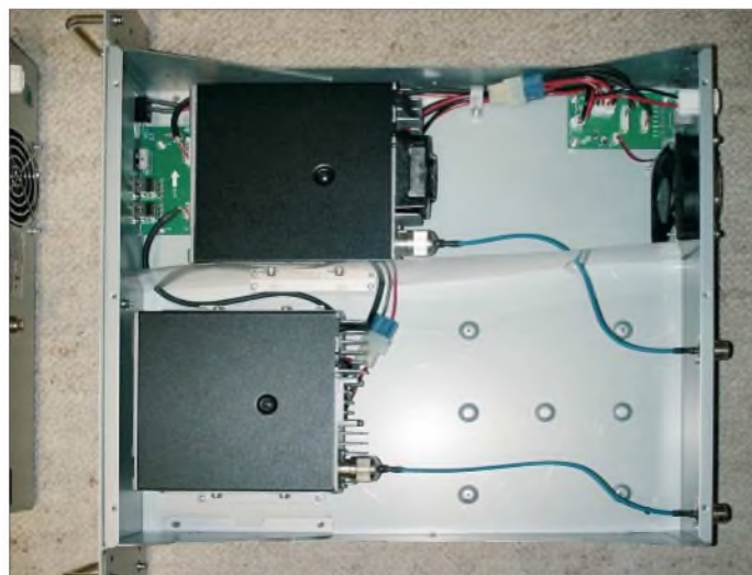
Bild 7: Blick in den 23-cm-Sprachumsetzer ID-RP2V
