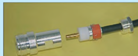
Bild 49: Nach dem Aufstecken der ersten Scheibe den Innenstift festlöten.
