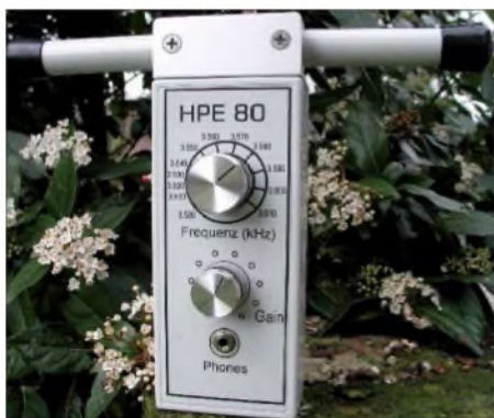
Der 80-m-Peilempfänger HPE 80 von DL3BBX
