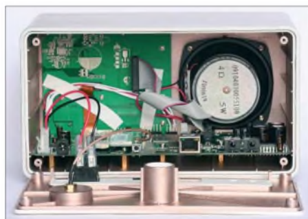
Bild 6: Blick ins Innenleben eines Internetradioempfängers
