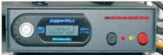
Bild 1: Die Player-Anzeige ist durch eine Gehäuseöffnung auch nach dem Einbau sichtbar.
