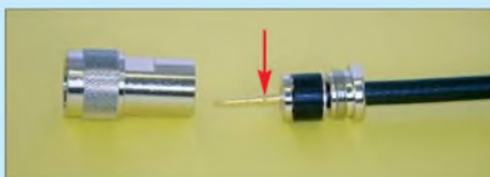
Bild 44: Über das seitliche Loch des Innenstifts lötet man den Innenleiter sorgfältig fest.
