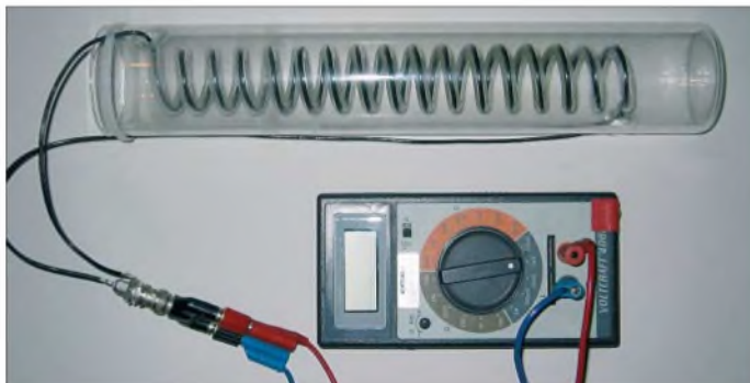
Bild 1: Einkoppelspule für die Aqua-Antenne Fotos: DJ6HP
