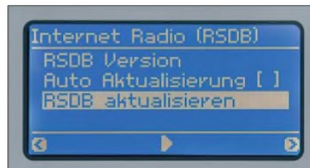
Bild 8: Noxon iRadio speichert eine Datenbank der empfangbaren Stationen. Auf Wunsch aktualisiert das System den Datenbestand täglich automatisch.
