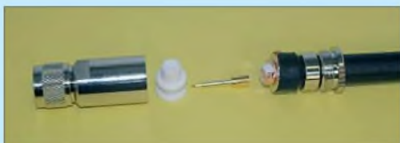
Bild 33: Nach dem Entwirren des Geflechts den Schaftkegel bis zum Mantel einschieben.
