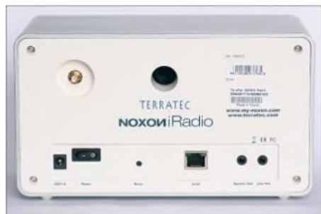
Bild 5: Noxon iRadio hält per WLAN oder Ethernet Kontakt zum Netzwerk. Funkantenne und Netzkabel lassen sich auf der Rückseite anschließen.
