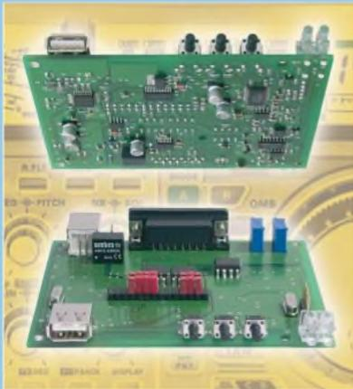
Das abgebildete und in nunmehr zwei Folgen im FA beschriebene USB-Interface stellt die Verbindung zwischen einem PC und einem modernen Transceiver her. Sowohl NF-Signale zum und vom Sende- bzw. Empfangsteil als auch sämtliche digitalen Signale, die zur Steuerung des Transceivers bzw. zum Loggen am Computer notwendig sind, werden potenzialgetrennt übertragen. Ein integrierter Soundchip entlastet obendrein den PC. Den FA-Bausatz gibt es ab Ende Mai.
