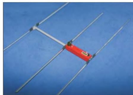
**Bild 6:** Die Elemente dieses Peilempfängers bestehen aus Abschnitten eines Stahl-Bandmaßes, die im Unterholz ohne Schaden zu nehmen nach hinten wegnicknen.
