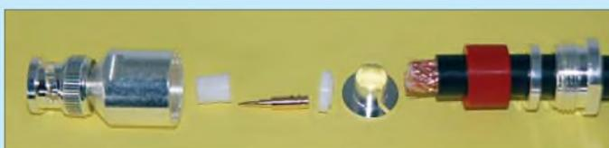
**Bild 52:** Der Mantel ist auf 6 mm zu entfernen.
