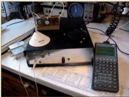
Aufbauend auf seinen vorigen, im FA veröffentlichten Arbeiten, beschreibt der Autor in diesem Beitrag das Transceiver-Modul DSP-TRX1, welches die komplette Signalverarbeitung vom Ausgang des 1. Empfangsmischers bis zum Lautsprecher sowie vom Mikrophon bis zum Eingang des Sendemischers auf digitaler Basis erledigt.
