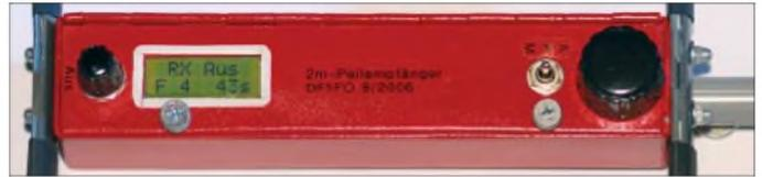
erst mit Strom versorgt, wenn der Hörer eingesteckt ist. Die Bedienung erfolgt über den Drehgeber und einen Kippschalter mit drei Stellungen der Schaltfolge Taster-Aus-Ein für die Funktionen Abschwächer-Peilen-Menü.
