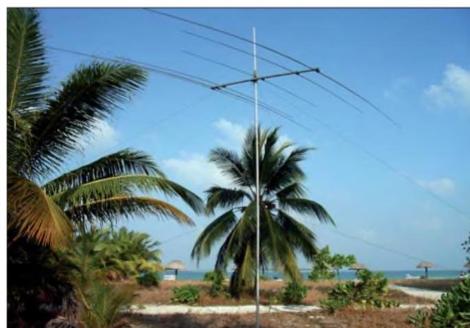
Die auf Bangaram-Island zum Einsatz gekommene Siebenelement-Yagiantenne für 20 bis 10 m
