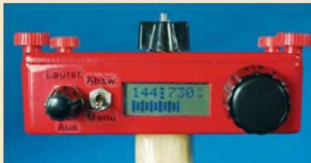
Neben einer hohen Empfindlichkeit und Trennschärfe bietet dieser Peilempfänger für das 2-m-Band dank eines Mikroprozessors auch eine einfache und logische Bedienung, die trotzdem keine Wünsche mehr offen lässt.
