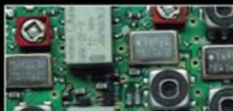
1. ZF: Drei Roofing-Filter bei 69,45 MHz
