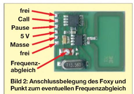
**Bild 2:** Anschlussbelegung des Foxy und Punkt zum eventuellen Frequenzabgleich
