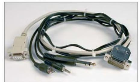
**Bild 24: Ein aus einseitig konfektionierten Leitungen (Sub-D9, Cinch, Klinkenstecker), Sub-D15-Steckverbinder und Griffschalen aufgebautes Anschlusskabel für den Yaesu FT-847**
