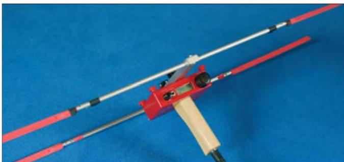
**Bild1:** Peilempfänger mit aufgesetzter HB9CV-Antenne und handfreundlichem Holzgriff
