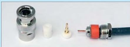
**Bild 62: Dielektrikum und Folie schneidet man vorsichtig bündig mit dem Kegel ab.**
