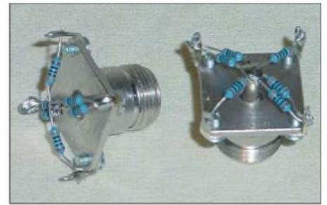
**Bild 13: Selbstgebaute 50-Ω-Abschlusswiderstände mit N-Buchse**
