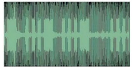
Bild 8: Der Screenshot zeigt deutlich, dass die Antennenempfindlichkeit für die Aufnahme des SAQ-Signals ausreicht ist, jedoch der hohe Störpegel an der Antenne das Signal überdeckt.
