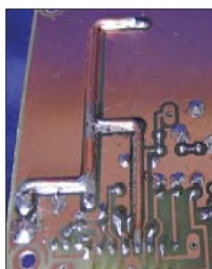
Bild 5: Die im Layout an den breiteren Leiterbahnen erkennbaren Leiterzüge sind mit aufgelöteten Kupferdrähten von 1,5 mm 2 zu verstärken.
