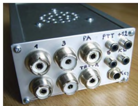
Bild 5: Für die Umschaltbox eignet sich das Aluminiumgehäuse 1030 von Conrad sehr gut. Es muss flach sein, da an der Rückseite diverse, mitunter störrische Koaxialkabel anliegen. Fotos: DL7CM
