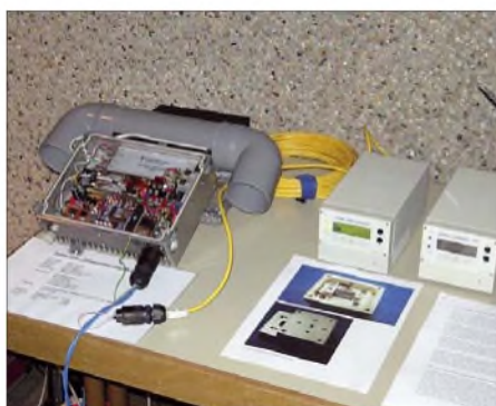
Der neue 10-GHz-Transverter von DLOGTH
