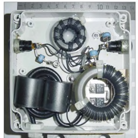
Bild 5: Das Innere des Einspeisenetzwerks
