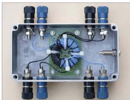
Bild 1: Durch das robuste Aluminium-Druckgussgehäuse und die Polklemmen, die auch Kabelschuhverbindungen zulassen, eignet sich der universelle Übertrager auch für den rauen Einsatz unterwegs.
