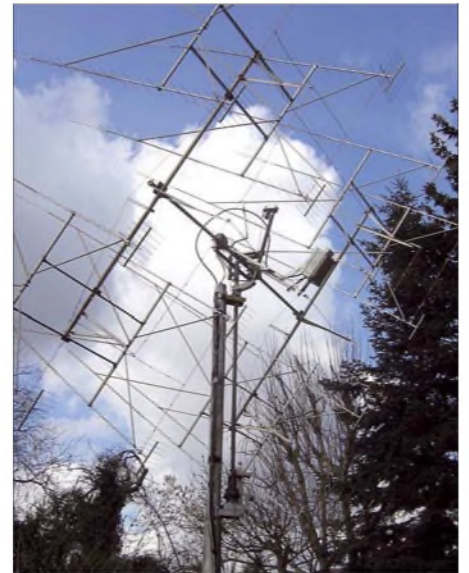
In wuchernde „Biomasse“ eingebettet: Die Gruppe von 16 x 24-Element-Yagis für 70 cm bei DL9KR
