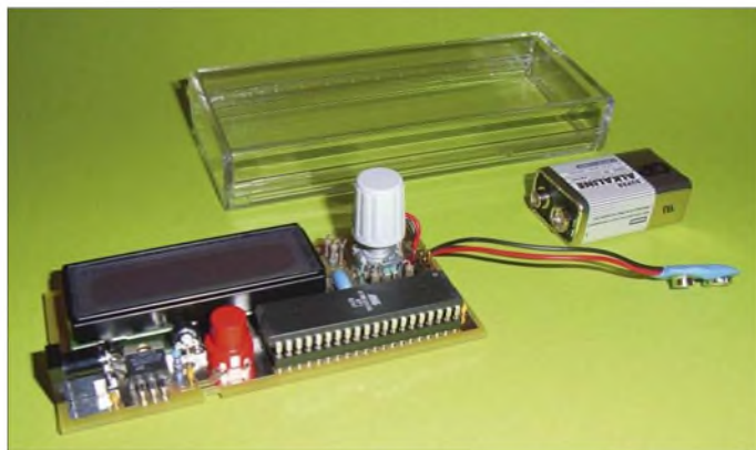
Bild 1: Der Locator-Rechner wird in ein glasklares Kunststoffgehäuse eingebaut.
