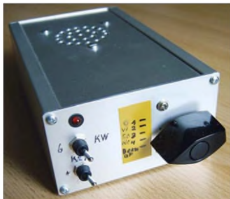
Bild 1: Frontansicht der Umschaltbox; vorn rechts der Antennenwahlwähler, links von oben nach unten LED-Betriebsanzeige, Schalter 6 m/KW, 12-V-Fernumschaltung
