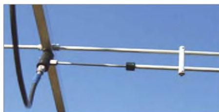
Bild 2: Gamma-Anpassung mit SO239-Buchse für hohe Leistungen
