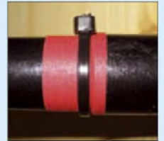
Bild 2: Sicherung der Elemente einer Angelrute mit Isolierband und Kabelbinder Fotos: DC1DV
