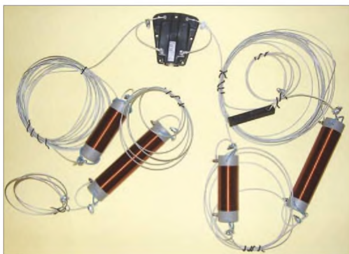
Bild 1: Dreibanddipol für 160/80/40 m mit CWL-Traps; Dimensionierung siehe Bild 10
