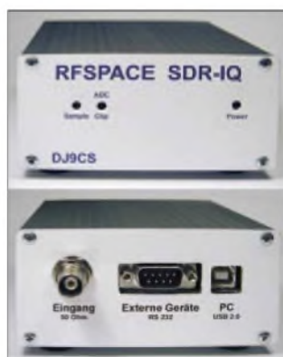
Bild 9: Ansicht des Standardgehäuses der Abmessungen 104 x 48 x 104 mm³ mit der SDR-IQ-Platine. Das Seriengerät wird ein anderes Gehäuse besitzen.
