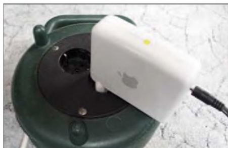
Apple AirPort Express: Benötigt nur 230 V und WLAN, um einen Verstärker drahtlos anschließen zu können.
