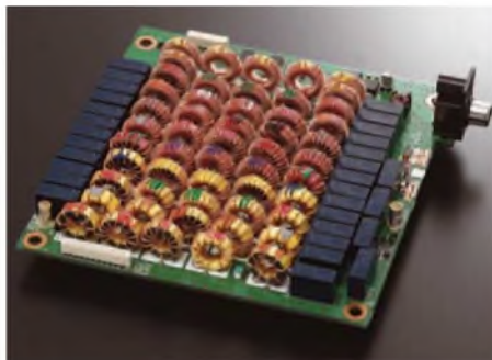
Bild 4: Mit Relais geschaltete Suboktav-Eingangsfiler für den KW-Bereich (links)
