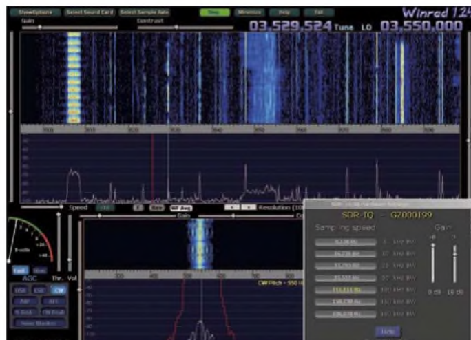
Bild 8: Einsatz der Software Winrad zusammen mit dem SDR-IQ als Empfängereingangssteil. Die Konfiguration des SDR-IQ erfolgt über das Menü rechts unten. Fotos, Screenshots: DJ9CS
