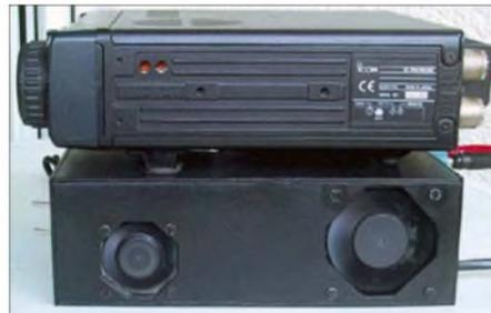
**Bild 5:** Seitenansicht des Netzteils; die größeren Ventilatoren sind dem Kühlkörper zugeordnet.
