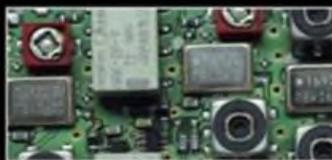
1. ZF: Drei Roofing-Filter bei 69,45 MHz
