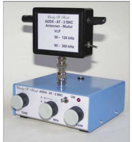
Bild 8: *ADDX-Verstärkermodul* mit VLF/LW-Ferritantenne
