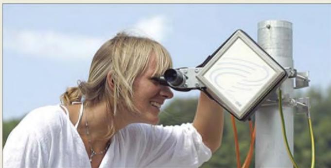
Für die Ausrichtung des Sencity Link auf die Gegenstation lässt sich am Gehäuse einfach ein Fernrohr befestigen.
