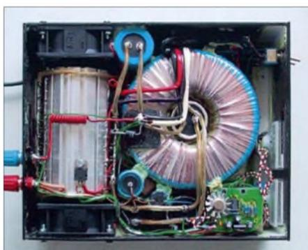
**Bild 4:** Innenansicht des Netzteils; Elektrolytkondensatoren, Shunt, Drehzahlregler sind im Hinblick auf die angestrebte Größe des Netzteils nach dem Einbau des Kühlkörpers und Transformators dort unterzubringen, wo Platz ist. Rechts befinden sich die beiden Anzeigeelemente.
