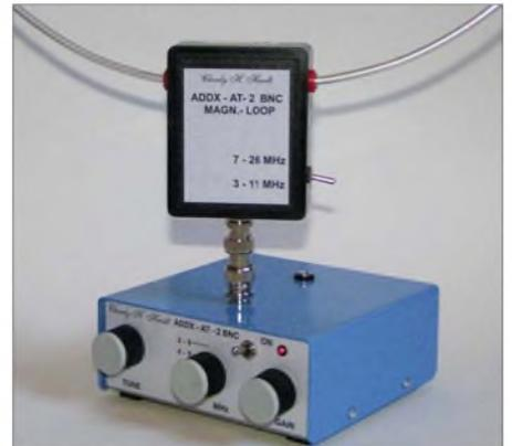
Bild 2: KW-Empfang mit ADDX Schleifenantenne
