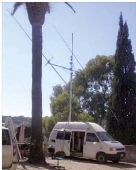
**UKW-DX aus dem Bus – das EME-Set-Up von 1A0KM mit zwei 17-Element-M<sup>2</sup>-Yagis (18 dBd); man erkennt gut die störende Palme.**
