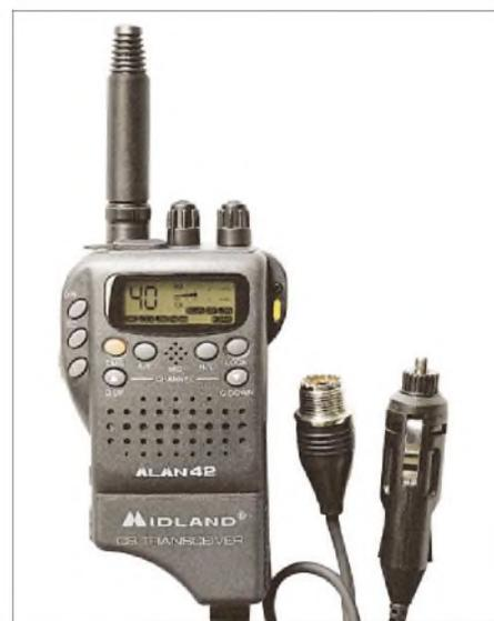
Zum Lieferumfang beider CB-Handsprechfunkgeräte gehört eine Mobileinheit zur Versorgung aus dem 12-V-Kfz-Bordnetz und zum Anschluss einer externen Antenne. Beim Alan 42 ersetzt der ansteckbare Mobiladapter das Batteriegehäuse.
