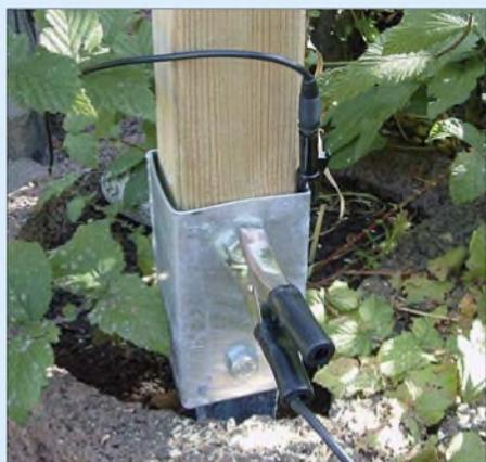
Bild 9: Zusätzliche Erdung an einer vorhandenen Einschlaghülse
