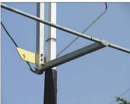
**Bild 14:** Reflektorbefestigung im am Ende U-förmig aufgeschlitzten Ausleger zur Vermeidung einer Kurzschlusswindung; zur Fixierung dient Heißkleber.
