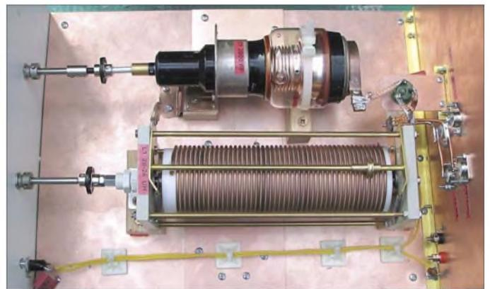
Sind dem Drehkondensator für 160 m Kondensatoren parallel zu schalten, müssen diese nicht nur für die geforderte Spannung, sondern auch für die auftretenden Ströme ausgelegt sein. Dafür eignen sich nur Typen, die für Sendezwecke geschaffen sind und entweder aus Glimmer oder keramischen Materialien bestehen und Schraubabschlüsse besitzen. In [6] sind dazu Einzelheiten nachzulesen.
