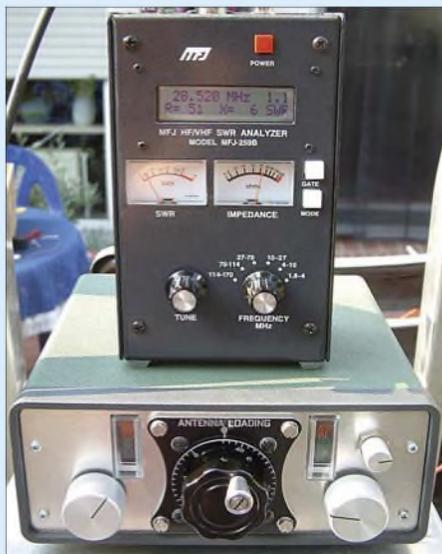
**Bild 16: MFJ-Antennenanalysator mit Selbstbaukoppler**
