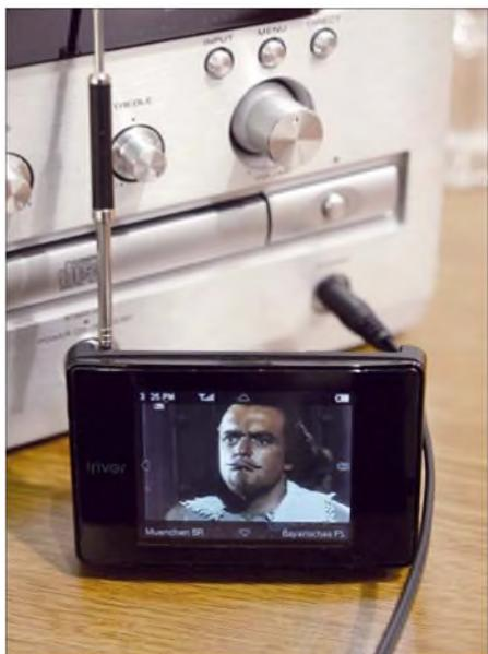
**Bild 7: Marantz DAB-CD-Mini-Stereoanlage, davor DMB-Mini-Fernseher**
