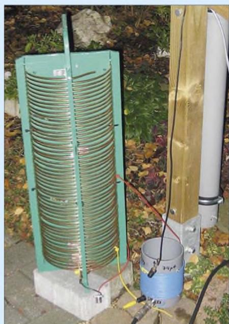
**Bild 15: Spule aus 4,5 mm dickem Kupferdraht und daneben Variante aus 1,5-mm<sup>2</sup>-Installationsdraht**
