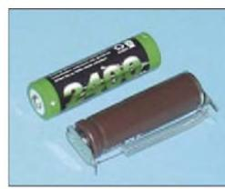
Bild 5: Der Sensor TGS5042 besitzt die Form und Größe einer Mignonzelle. Foto: Sander
