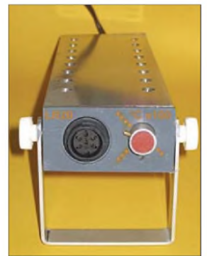
Bild 4: An der Frontseite des Reglers befinden sich die Anschlussbuchse des LötKolbens und der Einstellknopf für die Temperatur.
