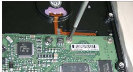
Bild 4: Ausbau der defekten Steuerplatine mit Torx-8-Schraubendreher.
