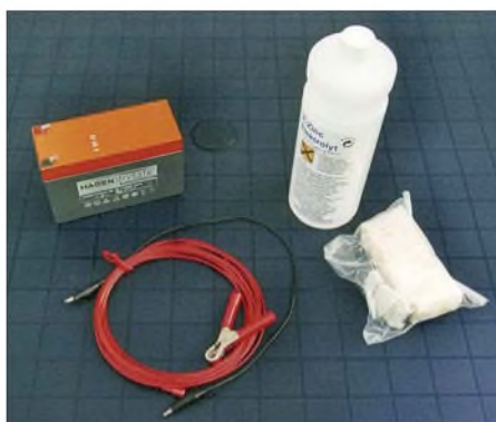
Bild 2: Das ist die komplette Ausstattung: Eine Flasche Elektrolyt, Elektroden, Kabel und Tampons des Galvanosets. Nicht zu vergessen, eine ausreichend starke Stromquelle. Hier ein kleiner Blei-Gel-Akkumulator, es kann aber auch ein entsprechend belastbares 12-V-Netzteil sein.
