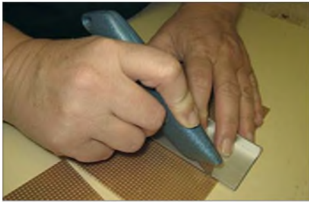
Bild 2: Die Bohrungen bei Lochrasterplatten erleichtern das beidseitige Anritzen sehr.
