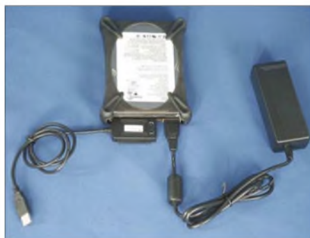
Bild 3: Anschluss einer Standard-3,5"-IDE-Festplatte mit übergezogenem Silikonummantelung an USB-Adapter und Netzteil: Fertig ist die preiswerte Speichererweiterung!
