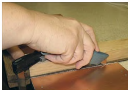
Bild 4: Um ohne zu verrutschen anritzen zu können, ist die Führung festzuspannen.
