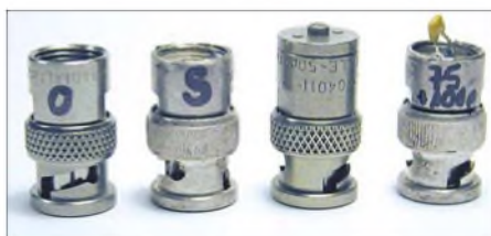
Bild 5: Die drei BNC-Kalibrierstandards und ein Teststecker
