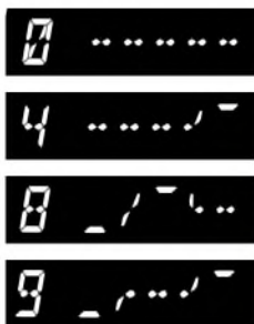
Bild 7: Der Sendefrequenzgang lässt sich durch einen im Menü sehr anschaulich dargestellten DSP-Equalizer optimieren. Bei 0 wird er umgangen. 4, 8 und 9 sind Frequenzgänge mit Höhenanhebung.
