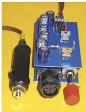
Bild 1: Die beiden Platinen der Reglerbaugruppe lassen sich platzsparend übereinander montieren.
