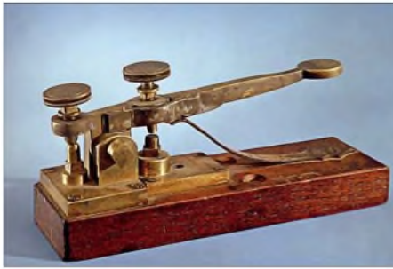
Die von A. Vail gebaute Morsetaste (1844)
