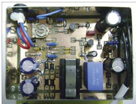
Bild 1: Elektronische Anodenbatterie im Weißblechgehäuse Foto: DB1NV
