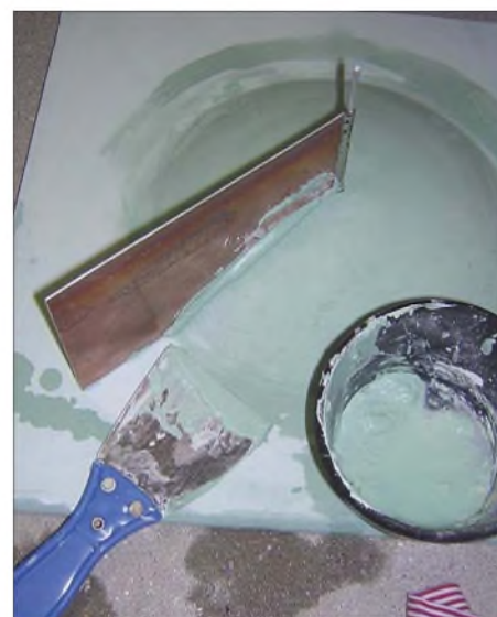
Bild 14: Herstellung der Gipsform für den Parabolspiegel
