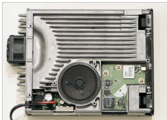
Bild 3: Innenansicht des IC-E2820, oben mit eingesteckter Digitaleinheit UT-123 und großen Kühlrippen
