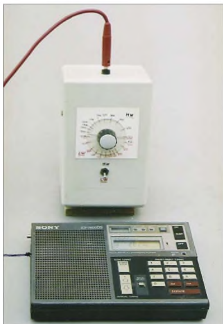
Bild 1: Anordnung des Fuchskreises zum Empfänger; durch Verändern des Abstands lässt sich die Kopplung leicht anpassen. Der Holzkeil unter dem Fuchskreis ist entbehrlich.
