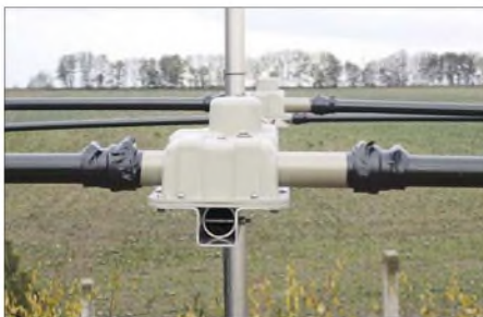
Bild 16: Eingesetzte Elemente mit zusätzlich umwickelten Muffen
