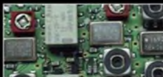
1. ZF: Drei Roofing-Filter bei 69,45 MHz
