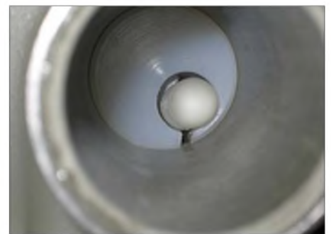
Bild 3: Hier sieht man im Boden vom Elemente-Aufnahme-Stützen der Elementegehäuse (Bild 2) – bei vollständig eingefahrenem Elementeband – den weißen Bandkopf, der das reibungslose Ausfahren des Kupfer-Beryllium-Bandes sichert.
