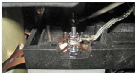
Bild 15: Befestigung eines der beiden Vierfach-Schleifersysteme für das Strahlerband
