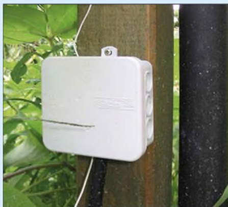
Bild 2: Ein Holzpfahl dient als Ständer der Angelrute und nimmt die Verteilerdose zum Anschluss von Antenne, Radials und Speiseleitung auf.
