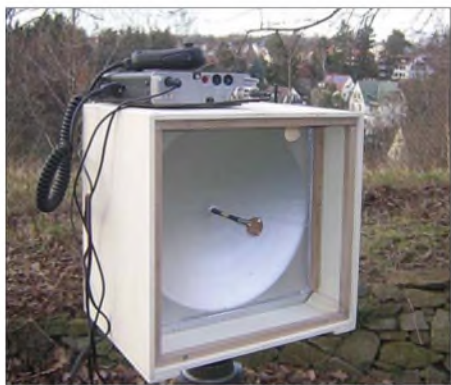
Bild 1: Betriebsbereite 47-GHz-Station mit Parabolspiegel in der Transportkiste und darauf stehendem Nachsetzer FT-817
