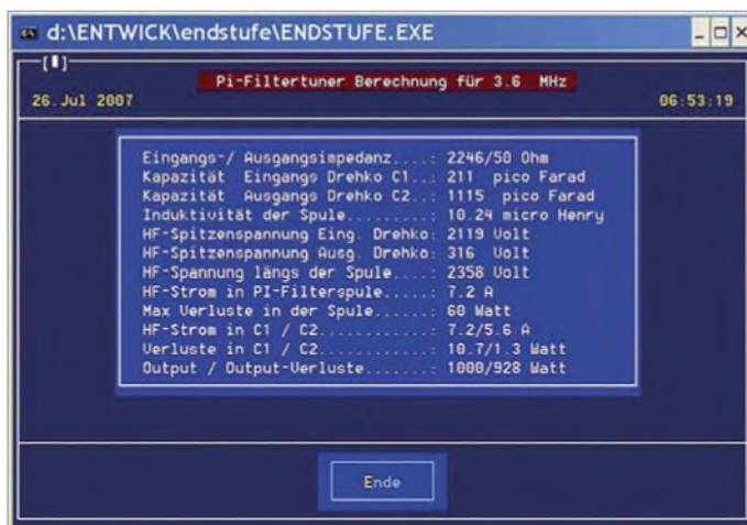
Bild 2: Berechnungsergebnis eines typischen \Pi -Filters in einer PA mit etwa 1000 W Output bei 3,6 MHz [3]; man beachte insbesondere die hohe HF-Spannung, die längs der Spule liegt, die unvermeidlichen Verluste, die sich durch Erwärmung äußern und die Schaltkontakte, besonders bei Dauerbetrieb, erheblich belasten.
