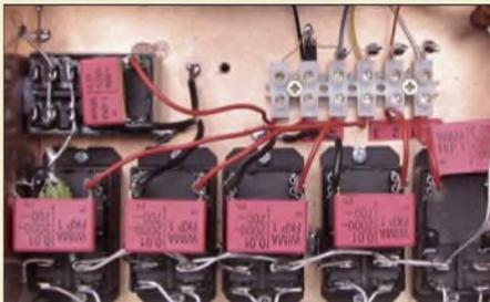
Der im Beitrag beschriebene ferngesteuerte Antennenumschalter verkraftet ein 750-W-Dauerstrich-Signal und sorgt auch für eine saubere zweipolige Umschaltung der Speiseleitungen. Das erfordert eine sehr sorgfältige Bauelementeauswahl. Foto: DC9ZP 1312
