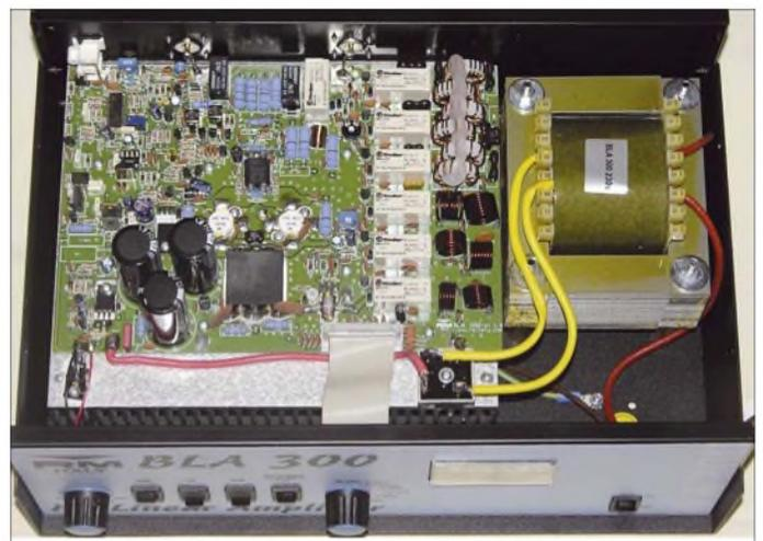
**Bild 2:** Innenaufbau der BLA 300
