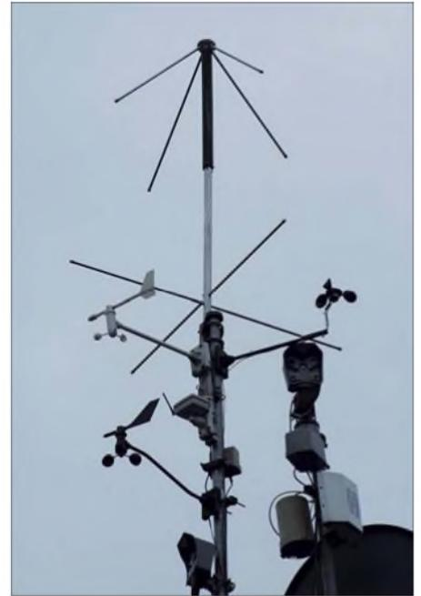
**Bild 3: Blick auf den Mast mit Anemometer, Böenmesser und Wetterkameras**
