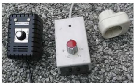
**Bild 7:** Thermostat und Timer in separaten Steckergehäusen
