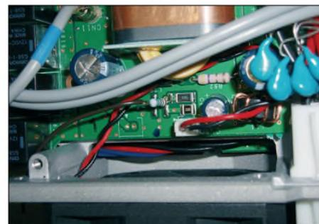
**Bild 5:** Lüftervorwiderstände mit stehend montiertem 75-Ω-Widerstand
