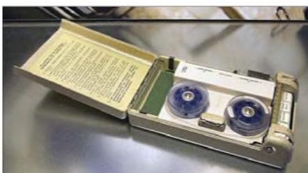
**Bild 12: Tondraht-Diktiergerät „Minifon Attache“, Protona, gebaut 1958 bis 1962, vier Transistoren, auch für Spionage mit Mikrophon in Krawattennadel oder Uhr**
