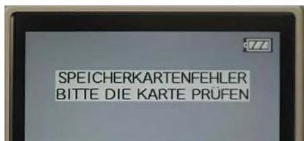
**Bild 5:** Eine 4-GB-*SD*-Karte in einer *SDHC*-Kamera führt zu Frust...
