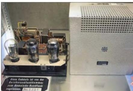
**Bild 10: Telefunken-Elva-Verstärker von 1937 mit zwei AD1, 10 Watt Ausgangsleistung**
