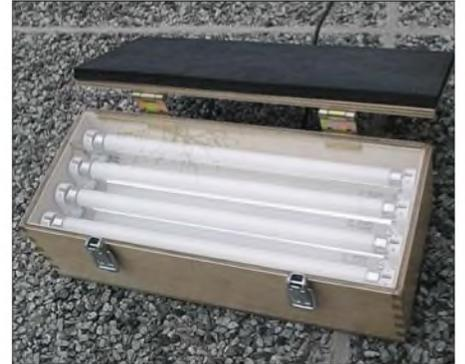
Bild 4: Beleuchtungsgerät im innen verspiegelten Sperrholzkasten
