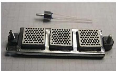
Bild 2: Ansicht des Keramikheizelements und des Heißleiters
