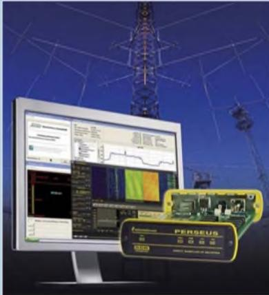
PERSEUS, ein softwaredefinierter Empfänger made in EU, glänzt mit Direktumsetzung des gesamten KW-Bereichs und eröffnet neue Möglichkeiten der Signalanalyse. Lesen Sie den Bericht von Dr. Seidenberg ab S. 1286! Foto/Design: Red. FA
