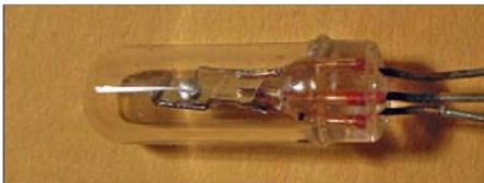
**Bild 1: Kein Selbstbau – Transistor OC44 im Glasgehäuse**
