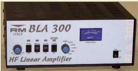
Die transistorisierte KW-Endstufe BLA 300 aus italienischer Produktion verstärkt ein QRP-Transceiver wie FT-817 oder IC-703 entstammendes Signal auf 100...200 W und machte am Messplatz eine erstaunlich gute Figur. Foto: DK7ZB 1282
