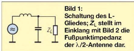
Aus diesen Gründen habe ich mich näher mit endgespeisten  $\lambda/2$ -Antenne und deren Speisung befasst [2]. Sie bieten einen bequemen Zugang zum Speisepunkt und lassen sich freitragend an einem Fiberglasmast aufbauen. Ein solcher mit 12 m Länge [3], [4] eignet sich am besten für alle fünf Bänder von 10 bis 20 m, da dann noch etwas „Luft“ für die Befestigung des Mastes, z. B. am Balkongeländer, bleibt.
