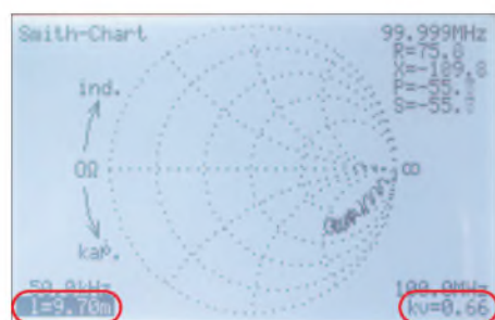
Bild 2: Bereits 0,1 m Abweichung von der korrekten Länge ergeben keine Gerade mehr.
