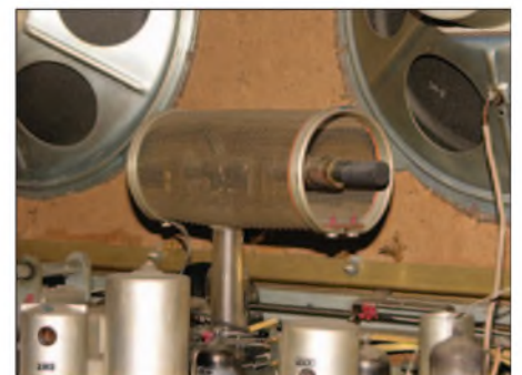
Bild 15: Drehbare, gegen elektrische Störungen abgeschirmte Ferritantenne
