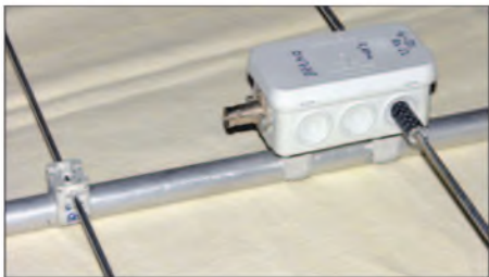
Bild 8: Mittelteil der 2-m-Yagi mit 6 Elementen
