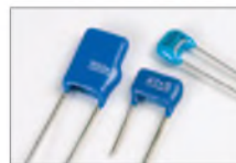
Bild 4: Sehr gute Entstöreeigenschaften haben keramische Vielschicht-kondensatoren.
