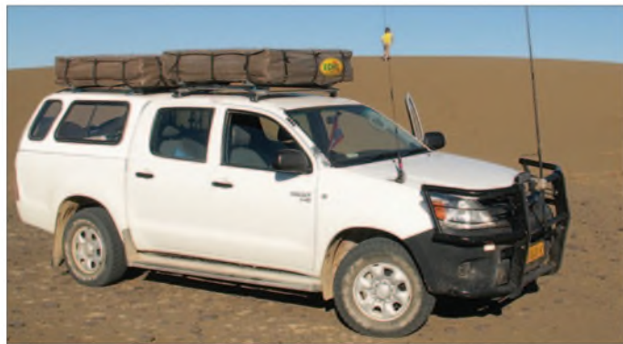
Bild 1: Am Kuhfänger des Allradfahrzeugs befand sich die Mobilantenne, sodass die Karosserie als Gegengewicht für die Mobilantenne fungieren konnte.
