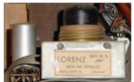
Bild 10: Einfacher Pendelaudion-Empfänger mit UCF12 (hier von Lorenz).
