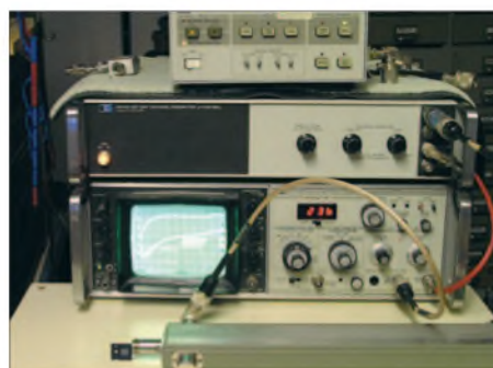
Bild 11: Messaufbau mit kommerziellem Spektrumanalysator und Richtkoppler
