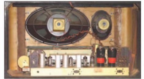
Bild 14: Innenansicht des Grundig 5010 mit den zweimal EL12-Endröhren
