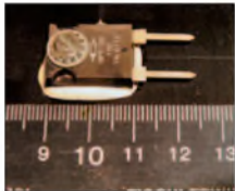
Bild 1: Widerstand 100 Ω/100 W vor dem Anlöten
