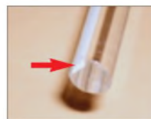
Bild 7: Bei dieser Faser ist links der weiße Reflektor zu erkennen. Fotos: Sander
