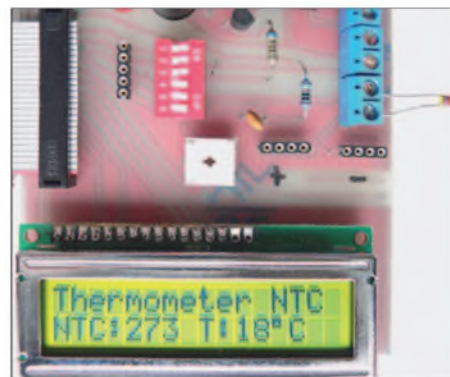
Bild 3: Die Zusatzbaugruppe Experiment 2 ermöglicht auf Grundlage des MikroKid2 z. B. mit einem passenden Sensor den Aufbau eines Thermometers.
