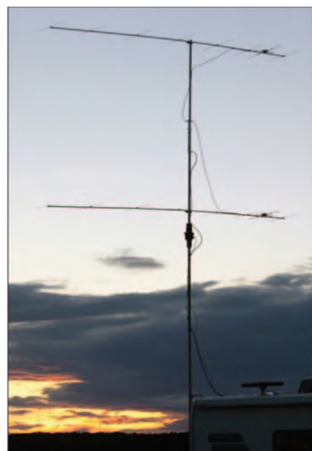
Bild 3: Gestockte Gruppe 8 über 8 für 2 m, 14,8 dBd Gewinn
