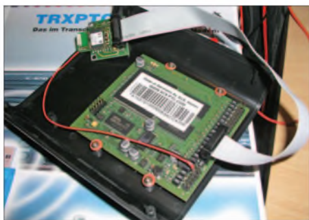
Bild 3: In den Deckel des automatischen 100-W-Antennentuners Z-100 von LDG ließ sich noch das TRX-PTC-Modul verstauen und mit vier Schrauben sichern.
