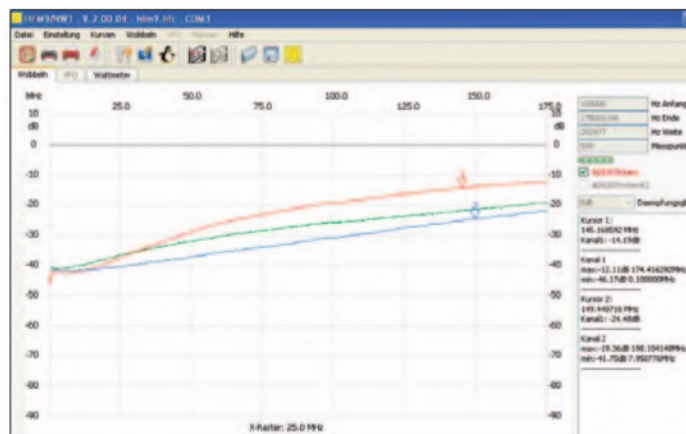
Bild 19: Reflexionsdämpfung der 100- (grün), der ersten 200-W- Version (rot) sowie der verbesserten 200-W-Version (blau)
