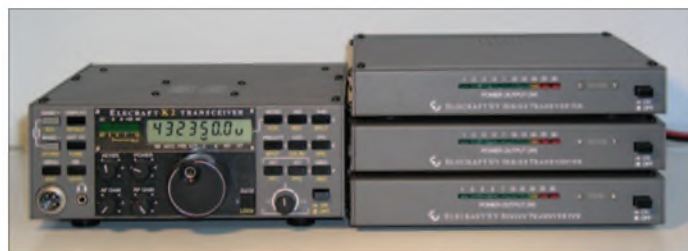
Bild 2: Anschluss der Transverter am K2 Fotos: DL7MAJ
