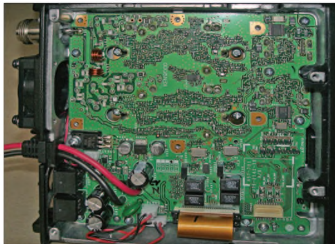
Bild 5: Kleinste SMD-Bauweise beherrscht das Innenleben, Bauteile sind kaum noch zu identifizieren.
