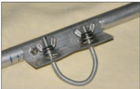
Bild 10: Selbstgefertigter Leichtbau-Haltebügel für Metallmasten
