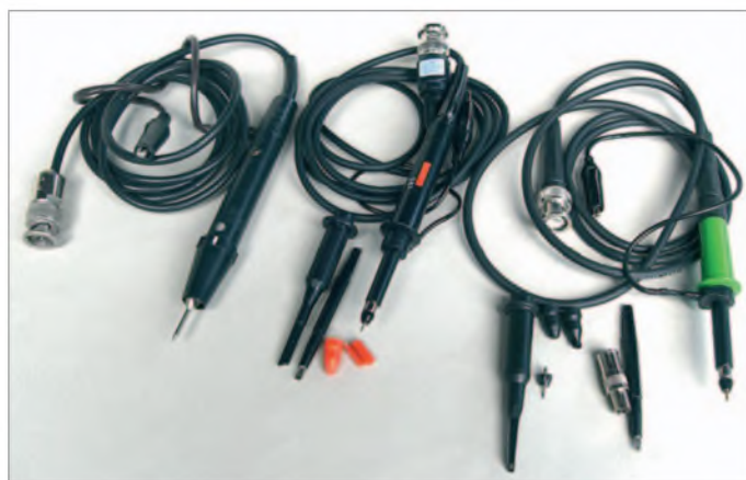
Bild 11: Wer am Tastkopf spart, spart am falschen Ende. Bereits die Mechanik entscheidet über Arbeitserleichterung oder Kontaktprobleme. Die minderwertige Krokodillemme des OP1M-Tastkopfs (links) sorgt z. B. eher für Verdruss als für eine ordentliche Masseverbindung.
