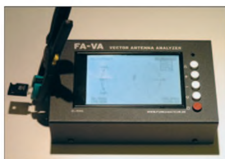
Bild 10: Einsatz des FA-VA zur Bestimmung der Eigeninduktivität eines einzelnen Widerstands
