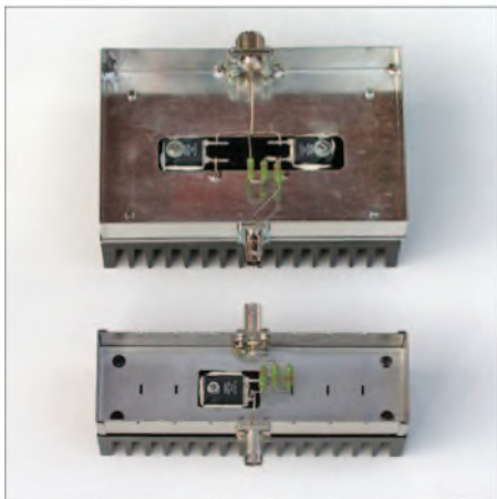
Bild 3: Oben 200-W-Version in der ersten Variante, darunter 100-W-Version, geöffnet
