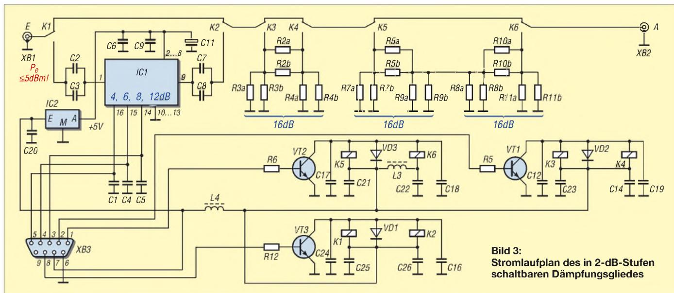
**Bild 3:** Stromlaufplan des in 2-dB-Stufen schaltbaren Dämpfungsgliedes
