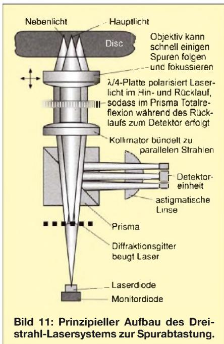
**Bild 11:** Prinzipieller Aufbau des Dreistrahl-Lasersystems zur Spurabtastung.
