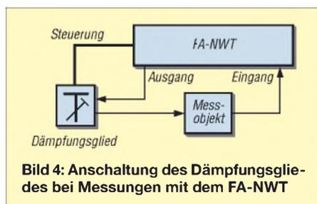
**Bild 4:** Anschaltung des Dämpfungsgliedes bei Messungen mit dem FA-NWT
