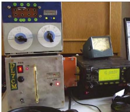
**Bild 1:** Netzteil und HF-Teil stehen übereinander, was bei kleineren Tischen von Vorteil sein kann.
