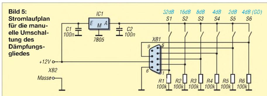
**Bild 5:** Stromlaufplan für die manuelle Umschaltung des Dämpfungsgliedes
