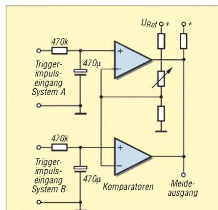
**Bild 14: So lässt sich eine UND-Verknüpfung der beiden Eingangssignale erreichen. Das Warnsignal wird nur dann ausgegeben, wenn beide Systeme eine vorgegebene Aktivität überschreiten. Dieses Schaltungsprinzip eignet sich zur Störunterdrückung durch den Aktivitätsvergleich von zwei (oder mehreren) örtlich getrennten Empfangssystemen.**
