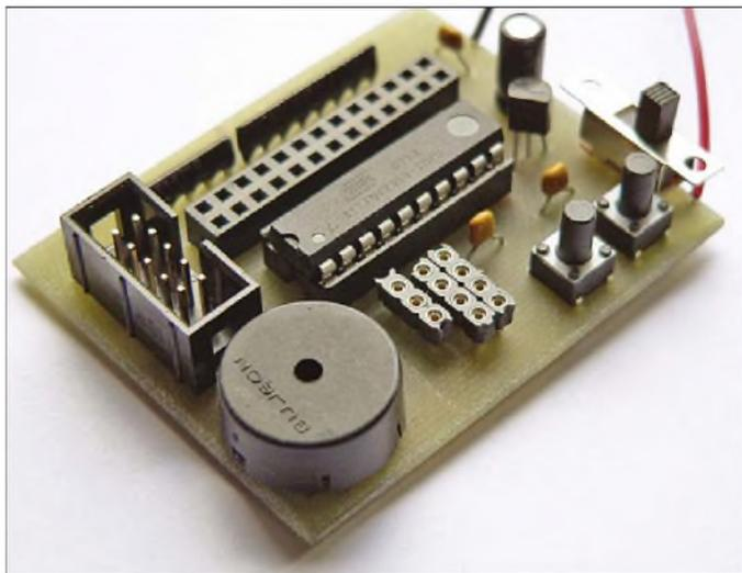
**Bild 1:** Piezosummer, Taster, Controllert und Spannungsquelle – mehr ist für die Erzeugung von Melodien nicht erforderlich. Und diese Komponenten stellt das MikroKid 2 bereit.
