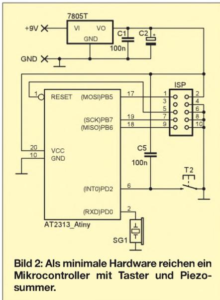
**Bild 2:** Als minimale Hardware reichen ein Mikrocontroller mit Taster und Piezosummer.
