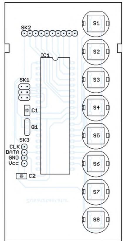
**Bild 4: Bestückung der Tastaturplatine**
