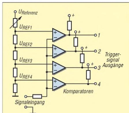
**Bild 9: Prinzipschaltung einer vierstufigen Amplitudenselektion mittels Vierfach-Komparators**
