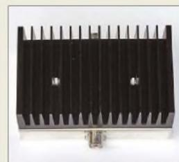
Das 40-dB-Dämpfungsglied wird bis 100 W belastbar sein.
