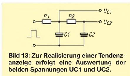
**Bild 13: Zur Realisierung einer Tendenzanzeige erfolgt eine Auswertung der beiden Spannungen UC1 und UC2.**
