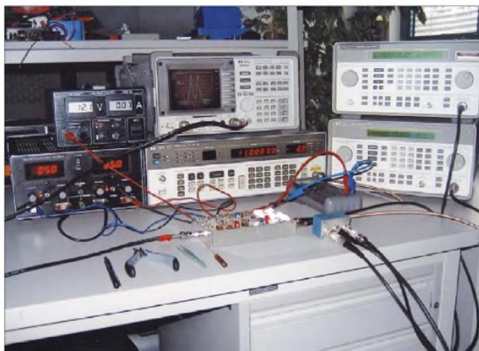
**Bild 1:** Messplatz mit drei *HF*-Generatoren, Spektrumanalysator, Netzteilen und Leistungsteil/-addierer
