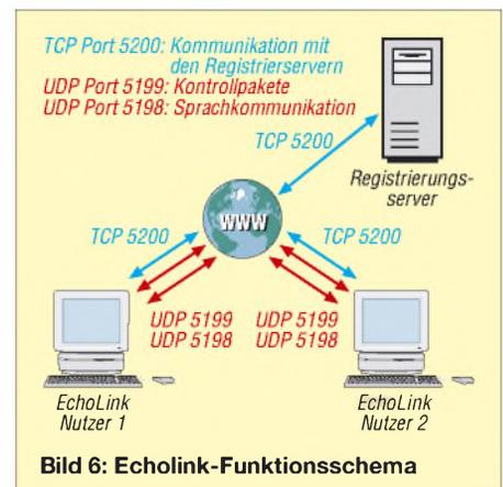
**Bild 6: Echolink-Funktionsschema**
