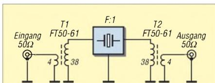
Bild 2: Stromlaufplan des Probeaufbaus für ein einzelnes Quarzfilter
