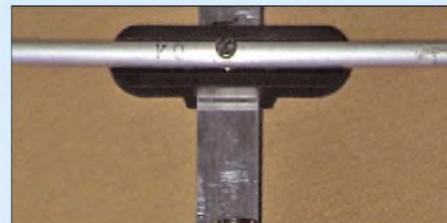
**Bild 4:** Isolierte Elementmontage mittel Halteklammer; die Schraube befindet sich im Spannungsnulldotpunkt und ist ohne Einfluss.
