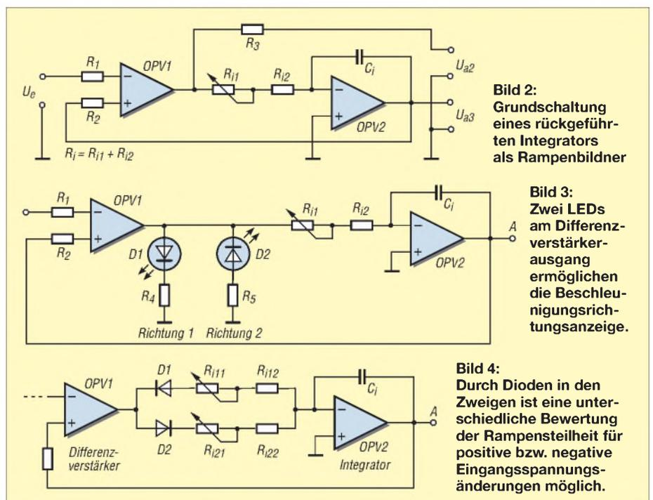
**Bild 2: Grundschiung eines rückgeführten Integrators als Rampenbildner**
