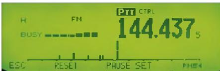
**Bild 20:** Wie schon beim TM-D700E ist auch hier wieder die auf Tastendruck erreichbare Spektraldarstellung beeindruckend. Je nach Einstellung kann die Aktivität des gesamten 2-m-Bandes auf einen Blick erfasst werden!
