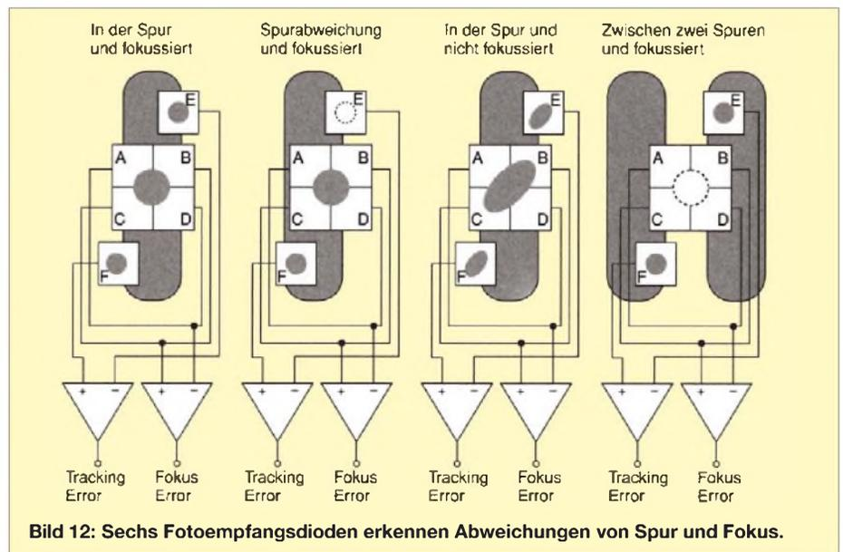
**Bild 12:** Sechs Fotoempfangsdioden erkennen Abweichungen von Spur und Fokus.
