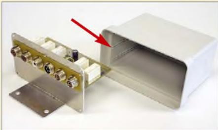
Dieser ferngesteuerte Antennenumschalter passt in ein handelsübliches Mastgehäuse und eignet sich für Sendeleistungen bis 100 W. Platine und Bausatz sind demnächst im FA-Leserservice erhältlich. Das aufgebaute Modul wird so in die Haube des Mastgehäuses eingeschoben, dass die Platine in eine vorgefertigte Nut gleitet – siehe Pfeil. Foto: FA 186
