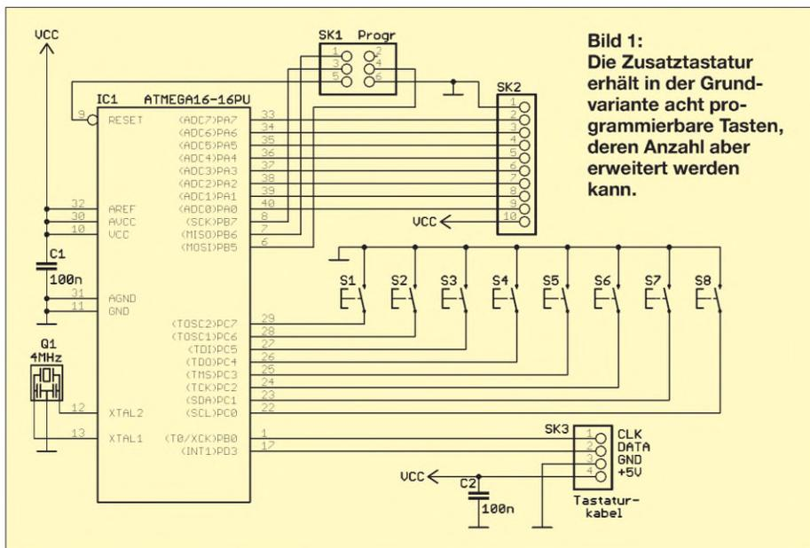
**Bild 1:** Die Zusatztastatur erhält in der Grundvariante acht programmierbare Tasten, deren Anzahl aber erweitert werden kann.
