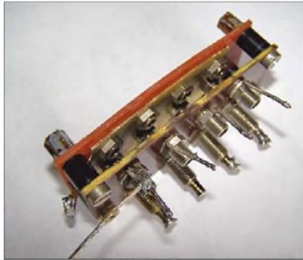
**Bild 6:** Hier besteht die hintere Buchsenplatte noch aus, wie sich erst später herausstellen sollte, nicht tauglichem Hart-PVC. Die vordere Buchsenplatte aus Bakelit ist unkritisch, da sie mit einer alle Kontakte verbindenden Messingplatte hinterlegt ist und zum anderen hier (50 Ω) keine hohen HF-Spannungen anliegen. Fotos: DL7CM
