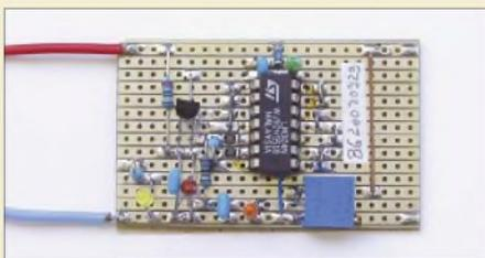
Eine kleine Schutzschaltung verhindert wirkungsvoll die Tiefentladung von Bleigel-Akkumulatoren. Wir erläutern Funktion, Bemessung und Aufbau der Variante mit einem OPV.
