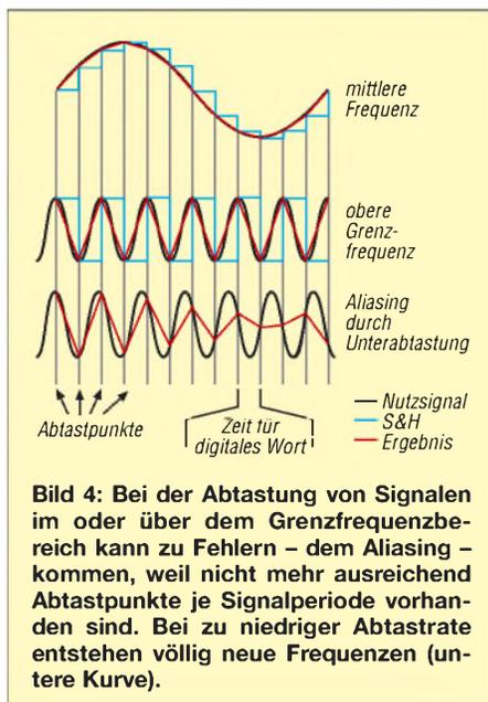
**Bild 4:** Bei der Abtastung von Signalen im oder über dem Grenzfrequenzbereich kann zu Fehlern – dem Aliasing – kommen, weil nicht mehr ausreichend Abtastpunkte je Signalperiode vorhanden sind. Bei zu niedriger Abtastrate entstehen völlig neue Frequenzen (untere Kurve).
