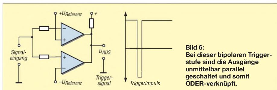
**Bild 6:** Bei dieser bipolaren Triggerstufe sind die Ausgänge unmittelbar parallel geschaltet und somit ODER-verknüpft.
