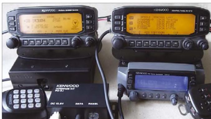
**Bild 22:** Im Vergleich mit dem Bedienteil des TM-D710E weist das RC-D710 kaum Unterschiede auf. Es bringt auch anderen Funkgeräten volle Datenfunktionalität. Das Interface PG-5J (links unten) ist an unauffälliger Stelle montierbar. Für den Anschluss an das Mobilfunkgerät TM-V71E ist es überflüssig.
