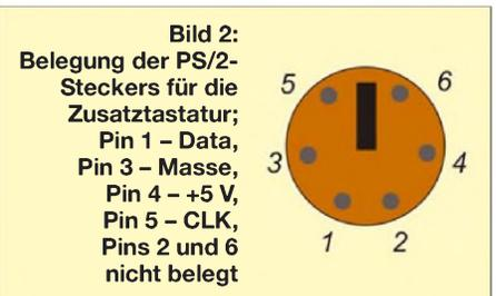
**Bild 2:** Belegung der PS/2-Steckers für die Zusatztastatur; Pin 1 – Data, Pin 3 – Masse, Pin 4 – +5 V, Pin 5 – CLK, Pins 2 und 6 nicht belegt
