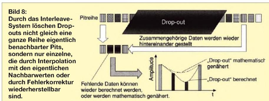
Bild 8: Durch das Interleave-System löschen Drop-outs nicht gleich eine ganze Reihe eigentlich benachbarter Pits, sondern nur einzelne, die durch Interpolation mit den eigentlichen Nachbarwerten oder durch Fehlerkorrektur wiederherstellbar sind.
