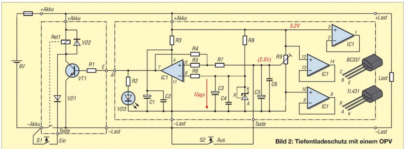
Bild 2: Tiefentladeschutz mit einem OPV
