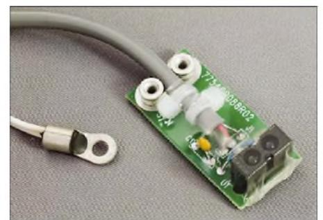
**Bild 3:** Temperatursensoren (links) und Drehzahlsensor (rechts)
