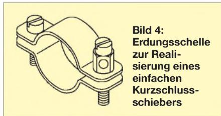
**Bild 4: Erdungsschelle zur Realisierung eines einfachen Kurzschlusschiebers**
