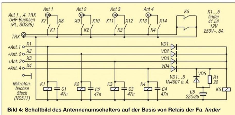
**Bild 4:** Schaltbild des Antennenumschalters auf der Basis von Relais der Fa. finder
