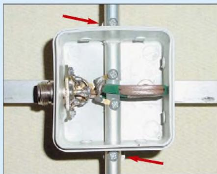
**Bild 1:** In dieser Anschlussdose ist deutlich das Kunststoffstückchen zu erkennen, welches zur Führung in beiden Strahlerhälften steckt und mit diesen verschraubt ist. An den Laschen der Anschlussdosen (Pfeile) werden die Strahlerhälften angeschraubt.
