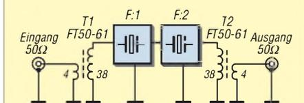
Bild 3: Stromlaufplan des Probeaufbaus für zwei kaskadierte Quarzfilter
