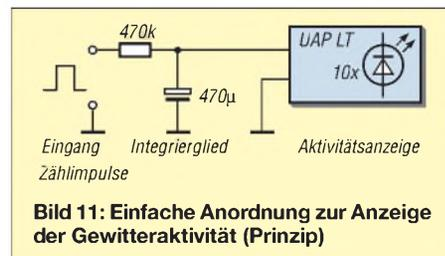
**Bild 11: Einfache Anordnung zur Anzeige der Gewitteraktivität (Prinzip)**
