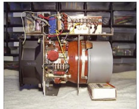
**Bild 2:** Der geschlossene Aufbau lässt keine Nebenluft zu. Oben von links nach rechts: Ausgangsrelais, Eingangsrelais, 50-Ω-Widerstand; darunter links der Ventilator und rechts daneben die Gitterbeschaltung
