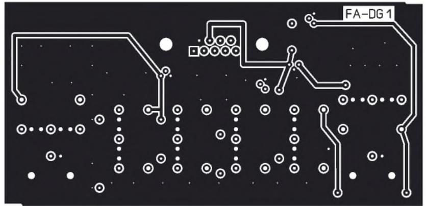
**Bild 7:** Layout der Platinenoberseite des schaltbaren Dämpfungsgliedes
