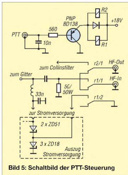
Bild 5: Schaltbild der PTT-Steuerung
