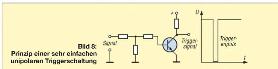
**Bild 8:** Prinzip einer sehr einfachen unipolaren Triggerschaltung
