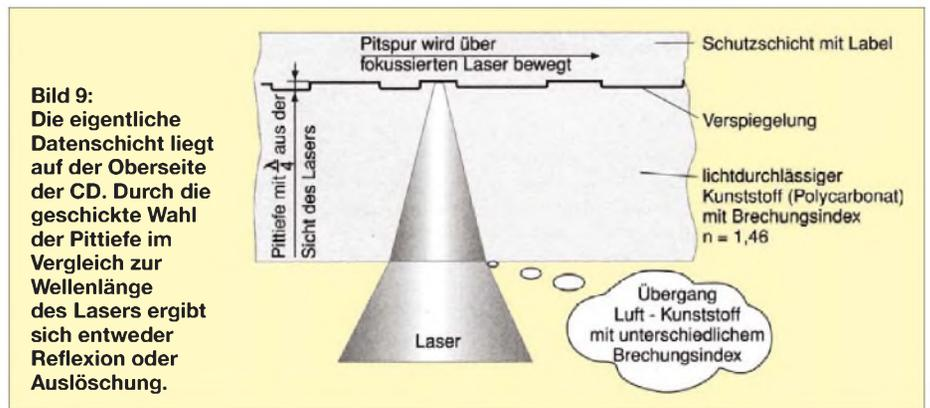
Bild 9: Die eigentliche Datenschicht liegt auf der Oberseite der CD. Durch die geschickte Wahl der Prittiefe im Vergleich zur Wellenlänge des Lasers ergibt sich entweder Reflexion oder Auslöschung.
