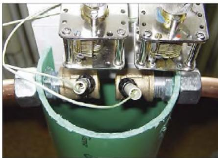
**Bild 3: Modularer Aufbau der miniLOOP und Ermeto-Verschraubung**
