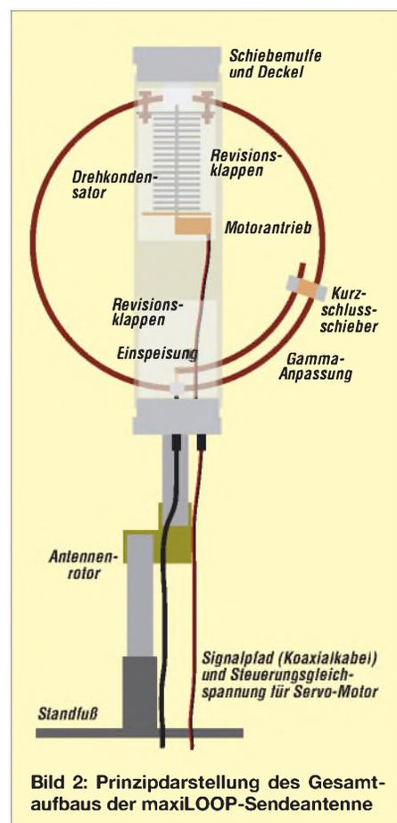
**Bild 2:** Prinzipdarstellung des Gesamtaufbaus der *maxiLOOP*-Sendeantenne
