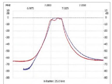
**Bild 10:** Die Durchlasskurve der Filter verschiebt sich bei ungünstiger Anpassung, so dass die untere Frequenzgrenze nicht mehr nutzbar ist. Es wurden hier zwei 7007M15A verwendet, wobei die FT50-61 jeweils 38:4 (rot) und 48:4 (blau) Windungen aufwiesen.
