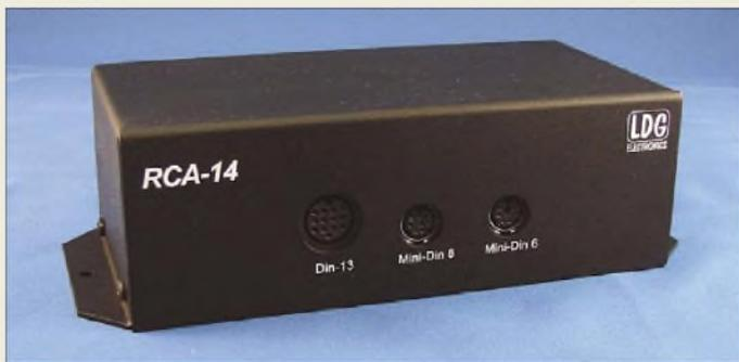
An der einen Seite der Interfacebox **RCA-14** befinden sich transceiver-typische Steckverbinder, an der anderen 1:1 verbundene Cinch-Buchsen.
