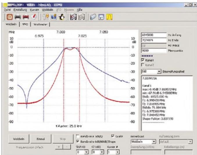
Bild 1: Durchlassdämpfung eines einzelnen Filters (blau) und zweier kaskadierter Quarzfilter (rot) des Typs 7007M15A
