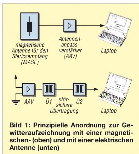
**Bild 1:** Prinzipielle Anordnung zur Gewitteraufzeichnung mit einer magnetischen- (oben) und mit einer elektrischen Antenne (unten)
