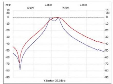
**Bild 9:** Gut erkennbar sind die Auswirkungen der Ankopplung auf die Durchlasskurve eines Filters. Bei einem zu kleinen Übersetzungsverhältnis von 26:4 (blau) treten „Kamelhöcker“ auf. Sie verlieren sich bei einem Verhältnis von 44:4 (rot), doch der Durchlassbereich wird dann breiter.
