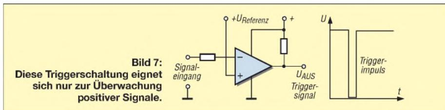
**Bild 7:** Diese Triggerschaltung eignet sich nur zur Überwachung positiver Signale.
