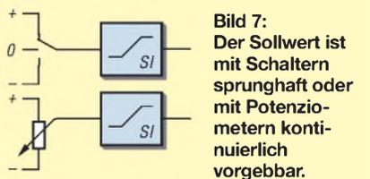
Bild 7: Der Sollwert ist mit Schaltern sprunghaft oder mit Potenziometern kontinuierlich vorgebar.
