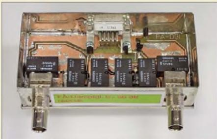
Die für einige Messungen erforderliche Absenkung des vom FA-Netzwerktester abgegebenen Ausgangssignals übernimmt ein per Software gesteuertes, in 2-dB-Stufen einstellbares Dämpfungsglied, das den Generatorpegel auf bis zu -60 dBm reduziert. Ein Bausatz ist im FA-Leserservice erhältlich. Foto: DM2CMB 166
