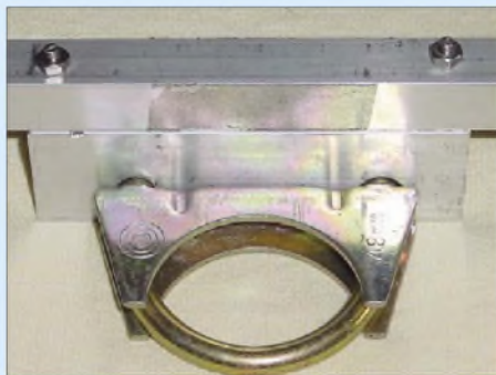
Bild 7: Die Masthalterung nach DK7ZB [9] besteht aus einem kräftigen Aluminiumwinkel und einer Kfz-Auspuffschelle
