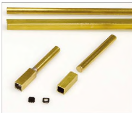
Bild 2: Ein Vierkantprofil aus Messing mit 4 mm Seitenlänge eignet sich gut zum Auslöten von Schaltkreisen im LFCSP-Gehäuse. Fotos: DK3RED
