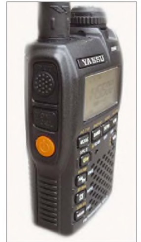
Bild 2: Griffig ist die Sendetaste gestaltet. In ihrer unmittelbaren Nähe sitzt die Sendestufe.
