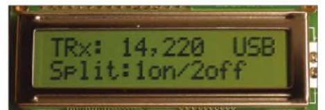
Bild 2: Ob der Split-Betrieb aktiviert werden soll oder nicht, lässt sich in der zweiten Zeile auswählen.
