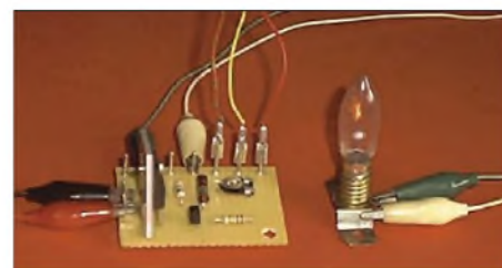
Bild 7: Für den ersten Funktionstest reicht statt des Lüfters auch eine vorübergehend angeklemmte Glühlampe. Fotos: DO2AV
