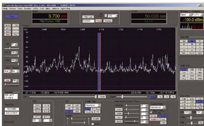
Bild 4: Bedienoberfläche ( Konsole ), die farblich individuell gestaltet werden kann. Sie wird bald abgelöst werden durch eine frei gestaltbare Oberfläche, die sich für spezielle Funktionen optimieren lässt: Contest, Messanwendung, digitale Betriebsarten usw.
