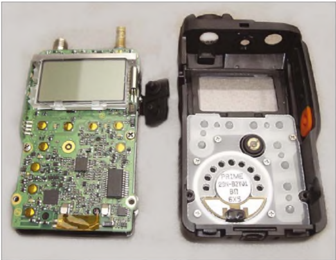
Bild 5: Die Tasten liegen unmittelbar auf der Platine. Daneben angeordnete LEDs durchleuchten ihre Abdeckung im Gehäuse.
