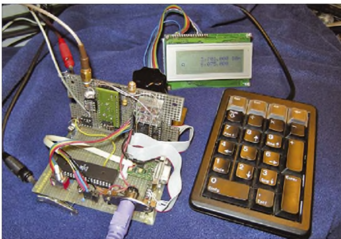
Bild 1: Versuchsaufbau DDS-VFO von DL7IY mit Drehgeber, PS/2- Numerntastenfeld von Cherry, Display und dem Controller ATmega 32
