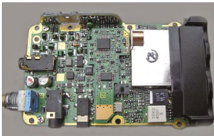
Bild 6: Nach dem Lösen einiger weiterer Schrauben zeigt sich der HF-Teil mit der darüber liegenden Speicher- und Regionalisierungs- platine.
