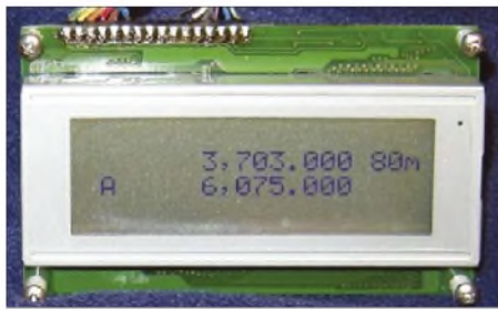
Bild 6: Als Anzeige lassen sich auch vierzeilige Displays mit je 20 Zeichen verwenden.
