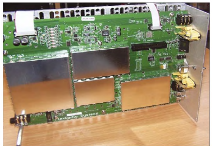
Bild 3: Die Ansicht der Trägerplatte von unten zeigt das HTRX-Board. Hermetisch abgeschirmt sind Frequenzaufbereitung, 11-poliger Tiefpass, RX-Mischer mit 24-Bit-A/D-Umsetzer sowie Firewire-Interface.
