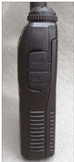
Bild 3: Zur Lade- bzw. Stromversorgungsbuchse auf der rechten Seite gesellt sich nun noch eine Klinkenbuchse für einen Kopfhörer. UKW-Empfang in Stereo möglich! Nach wie vor gibt es auf der Oberseite eine vierpolige Buchse zum Mikrofonanschluss.
