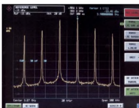
Bild 18: Mischerspektren von MAX 4544 (oben), IE-500 (Mitte) und SA 602 (unten) im Vergleich je mit Zweitonsignal 7,1/7,15 MHz und 11 MHz Oszillatorsignal; der SA 602 wird dabei bereits erheblich übersteuert.
