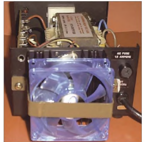
Bild 3: Der Lüfter wird von außen direkt auf den Kühlkörper des Netzteils gesetzt und mit einem Bügel an der Rückwand befestigt. Seine Anschlüsse führen zur Zusatzplatine im Gehäuseinneren.
