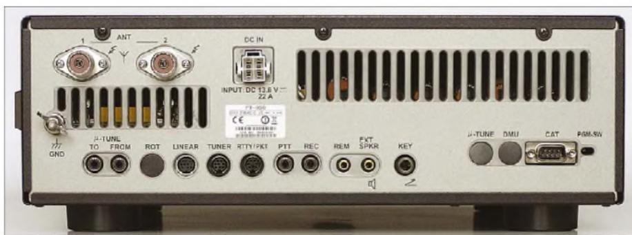
**Bild 2:** Rückansicht des FT-950. Der Lüfter befindet sich im Innern; die erwärmte Luft strömt durch die Schlitzzeilen. Die Beschriftung der Buchsen ist auch bei ungünstiger Beleuchtung gut zu lesen. Man beachte die Stopfen in drei der Buchsen.
