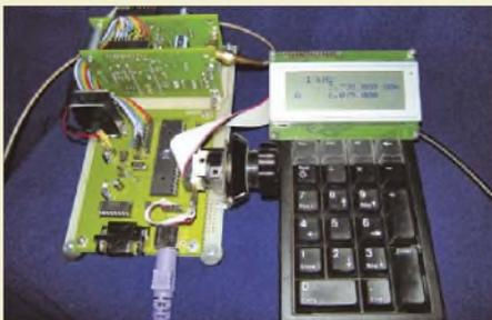
Die Controller-Platine, die die Steuerung des High-End-DDS-VFOs übernimmt, ist auch separat für andere Projekte nutzbar. Im FA 5/08 werden wir den DSP-Transceiver, für den der VFO hauptsächlich gedacht ist, komplettieren.
