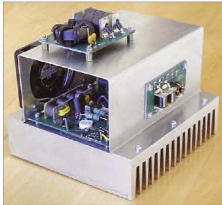
**Bild 3: Die eigentliche Endstufe besteht aus zwei Modulen nebst Leistungsaufteilung und -zusammenführung. Fotos: OE2KHM**
