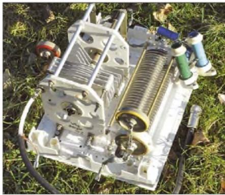
**Bild 2: Abstimmkasten für die Omega-Einspeisung**
