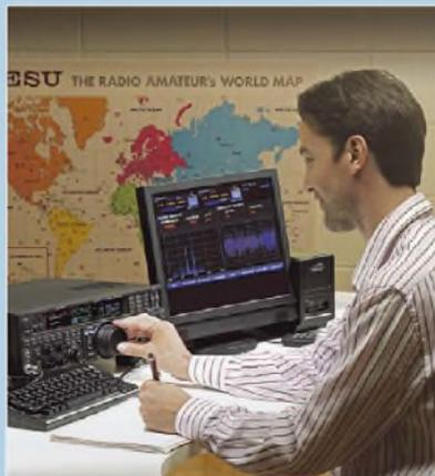
Der FT-950 füllt die Lücke zwischen FT-450 und FT-2000 in der aktuellen Transceiver-Reihe von Yaesu, die durch die Innovationen und Lösungswege des Flaggschiffs FTdx9000 geprägt wird. Ein auch mechanisch solides und mit seinen 10 kg noch ganz gut zum Mitnehmen geeignetes Gerät, das zeitgemäße DSP-Funktionalität im ZF-Bereich bei einem guten Preis-Leistungs-Verhältnis bietet. Foto: Werkfoto
