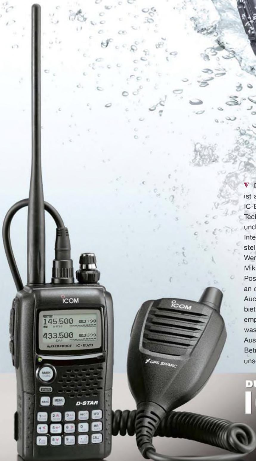
▼ D-STAR (Digital Smart Technology for Amateur Radio) ist auf dem Vormarsch. Und auch Sie können mit einem IC-E92D die neuen Möglichkeiten dieser fortschrittlichen Technologie nutzen: Stationen gezielt anrufen, Rufzeichen und kurze Textmeldungen austauschen, über mit dem Internet verlinkte Repeater weltweite Verbindungen herstellen u. v. m.
