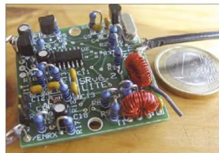
Bild 2: Softrock SRv6.2 Lite für 80 m; der sehr kleine Direktmischer überstreicht etwa den Bereich 3505 bis 3550 kHz.
