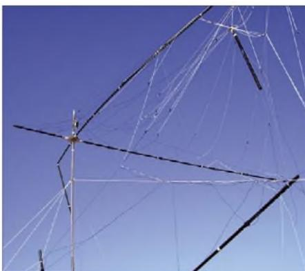
**Der beim Sturm beschädigte Spider-Beam**
