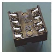
**Bild 4:** Im Schritt 2 sind die Verbindungsdrähte in die Kontakte der Fassung zu löten.
