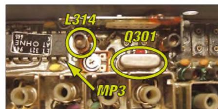
von genau -600 kHz. Dazu ist der im Bild gezeigte Q301 gegen einen 10,4-MHz-Quarz [2] zu tauschen. Zum Abgleich tastet man den Sender, misst mit einem Oszilloskop die HF-Spannung an MP3 und gleicht mithilfe von L314 auf höchste HF-Spannung ab.
