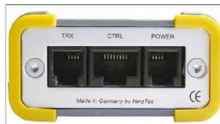
**Bild 5:** Für den Anschluss an die Western-Modularbuchsen liegen dem Gerät bereits konfektionierte Anschlusskabel bei, die nur noch mit passenden Steckern für Wetterstation bzw. GPS und Funkgerät versehen werden müssen.
