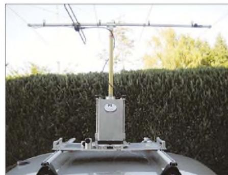
Bild 3: Antenne und Plattform des Peilers
