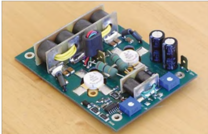
Bild 7: Auf jeder der beiden im Gerät einzusetzenden PAMOD-Platinen befindet sich ein 200-W-Breitband-Leistungsverstärker.
