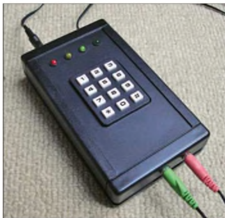
Bild 7: Handliche Aufbauvariante des Sprachverschlüsslers Hektor Foto: Thomas
