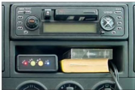
Bild 1: Das neue Gerät TalkSafe der englischen Firma RPF Communications stellt die drahtlose Verbindung zwischen dem Headset und dem Funkgerät her.
