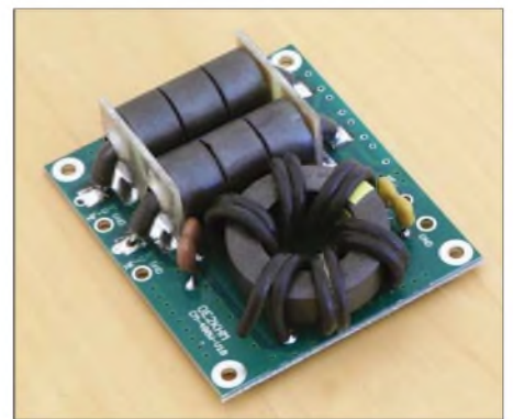
Bild 8: Die PCOM-Platine führt die Ausgänge der beiden Endstufenmodule zusammen.
