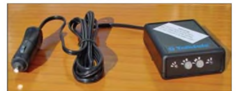
Bild 3: TalkSafe wird mittels mitgeliefertem 12-V-Kabels für die Zigarettenanzündersteckdose an die Bordversorgung angeschlossen.
