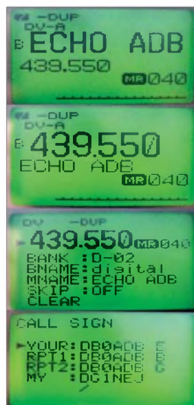
Bild 7: Speicherkanäle lassen sich mit Namen versehen und wahlweise die Bezeichnung oder die Frequenz größer darstellen. Im DV-Modus wird sogar die Adressierung mit abgelegt.
