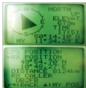
Bild 8: Absolutes ODX für 70 cm im DV-Modus: angezeigte Distanz zur Gegenstation 8124 km! (tatsächliche Entfernung unter 80 km)
