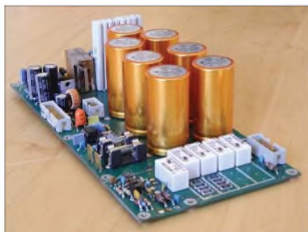
Bild 14: Energieversorgung mit Strommessung und Eingangsabschwächer finden auf der PSCATT-Platine Platz.
