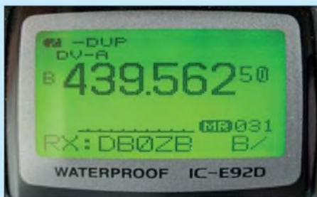
Bild 2: Hier meldet der Repeater DB0ZB den Empfang der Sendung. Was sie nicht meldet ist, dass die gewünschte Station gar nicht existiert. Meldungen helfen also nur bedingt weiter.
