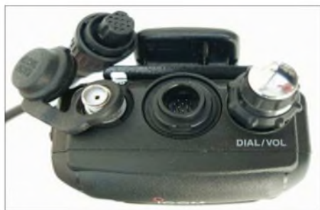
Bild 4: Eine ganz ungewöhnliche Buchse dient zum Anschluss von Mikrofon und Datenkabel.
