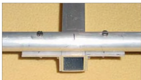
Bild 6: Elementbefestigung auf Vierkant-Boom
