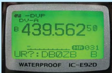
Bild 3: Hier antwortet der Repeater auf eine Aussendung ohne jede Adressierung und meldet, dass er 1. auf dieser Frequenz QRV ist und 2. keine Zieladresse erkennen konnte. Fotos: DG1NEJ
