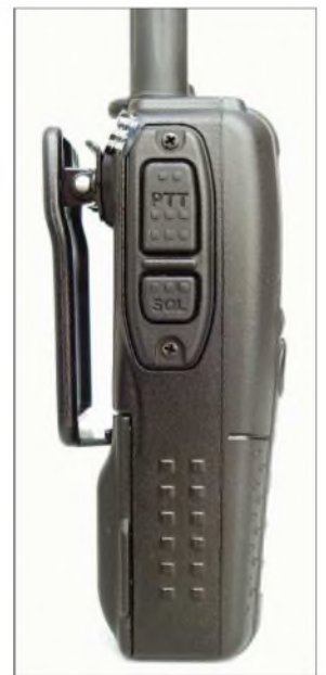
Bild 2: Blick auf die Sendetaste; der massive Clip hält das Gerät nicht nur am Gürtel fest.
