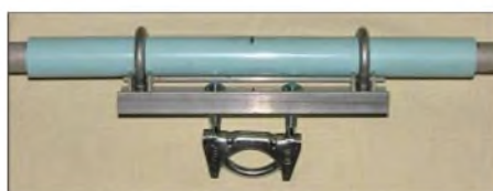
Bild 8: Konstruktion des Mittelstückes mit Halterung
