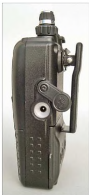
Bild 3: Alle Buchsen verfügen über Dichtungen.
