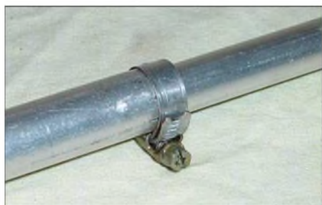
Bild 7: Verbindung zwischen 16-mm- und 12-mm-Rohren mit Schlauchschelle
