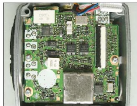
Bild 5: Blick auf den HF-Teil des Geräts
