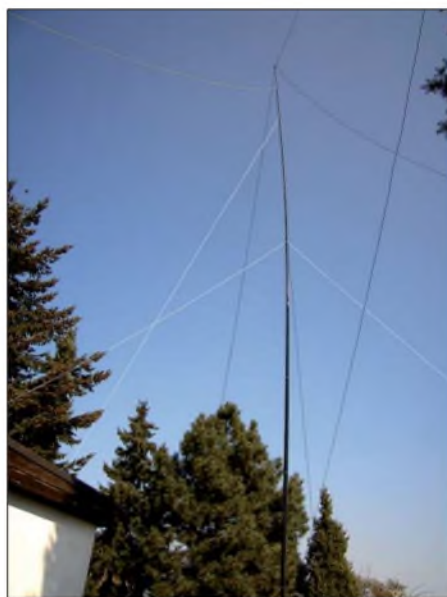
Teilansicht des 16-m-Mastes mit Loop Foto: DL2FI
