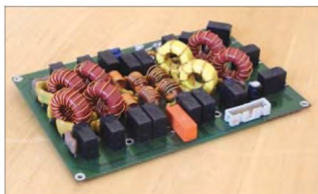
Bild 13: Auf der FPWRN-Platine sitzen die Ausgangsfilter nebst Leistungsmessung.
