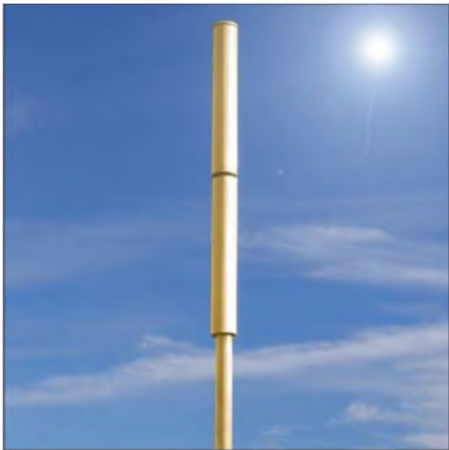
Bild 2: Fertig aufgebauter Doppelsperrrtopf mit Tragrohr Foto: DJ9YW
