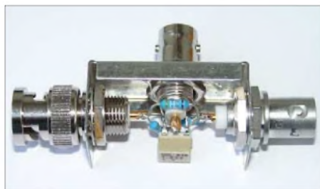
Bild 15: Fertig aufgebauter Hybridkopppler
