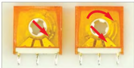
Bild 26: Der Schleifer des Miniaturdrehschalters ist vor dem Einbau durch Rechtsdrehung so einzustellen, dass er das erste Kontaktpaar von rechts kurzschließt.
