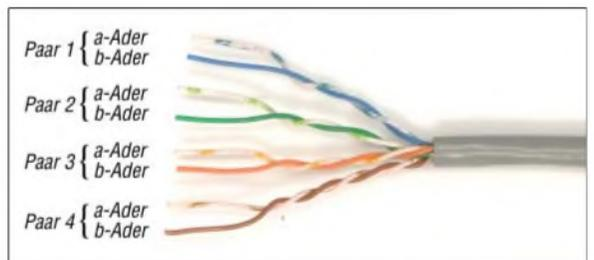
Bild 6: Netzwerkkabel nach EIA/TIA-568B
