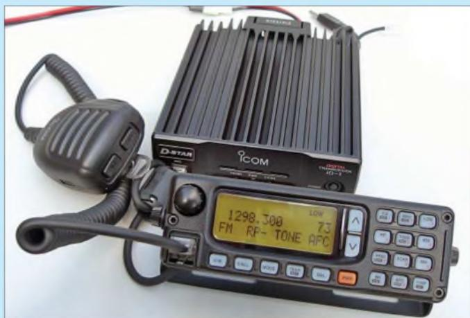
**Bild 4:** Bis dato gibt es nur wenige, für schnelle Datenübertragung geeignete Funkgeräte – hier ein Vertreter: ID-1 von Icom [8].
