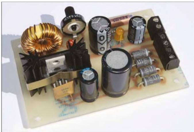
Bild 1: Ansicht des 3-A-Schaltreglers für einstellbare Ausgangsspannungen
