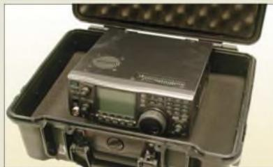
Transportkoffer aus ABS – das kleinere Modell PPS-PC3810 misst 380 mm x 300 mm x 100 mm und kostet 60 €, der größere Koffer PPS-PC4618 ist 460 mm x 370 mm x 180 mm groß und kostet 120 €.
