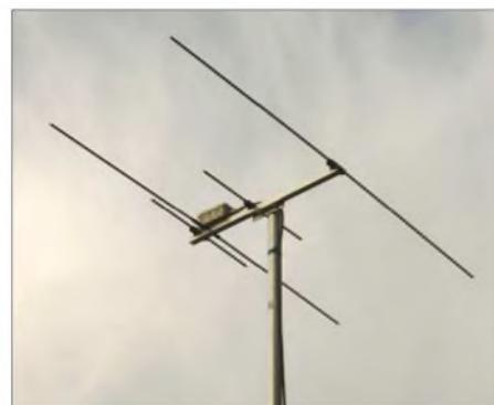
**Bild 4: Die fertige Antenne vom Typ 1 auf dem Mast**
