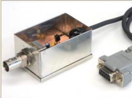
Besonders bei der Aufnahme von Filterkurven mit dem FA-Netzwerktester ist die gleichzeitige Aufnahme eines zweiten Messwerts willkommen. Einen passenden externen Messdetektor, der als Bausatz verfügbar sein wird, stellt dieser Beitrag vor.
