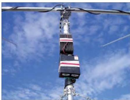
Bobs „Geheimwaffe“ – die Endstufe direkt unter dem Antennenaufbau
