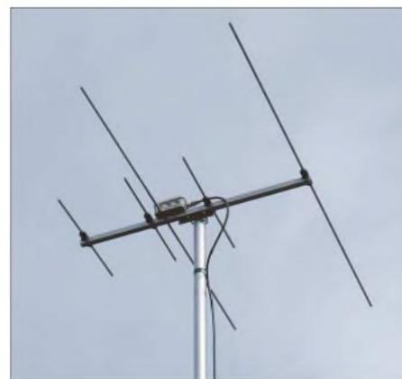
**Bild 14: Die um einen weiteren 70-cm-Direktor ergänzte Yagi vom Typ 2 Fotos: DK7ZB**
