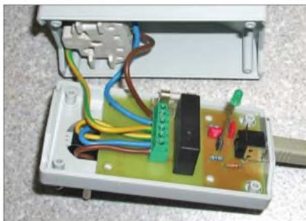
**Bild 1: Platine im Steckergehäuse mit integrierter Steckdose** Foto: DK7NT
