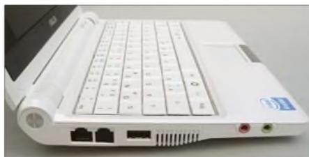
**Bild 2:** Auf der linken Seite befinden sich die Buchsen der Soundkarte, einer der drei USB-Anschlüsse, eine Netzwerkbuchse und die blinde Modembuchse.
