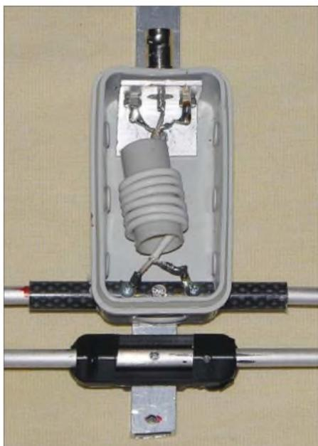
**Bild 12: Anschlussdose mit Speisedrossel und BNC-Buchse**
