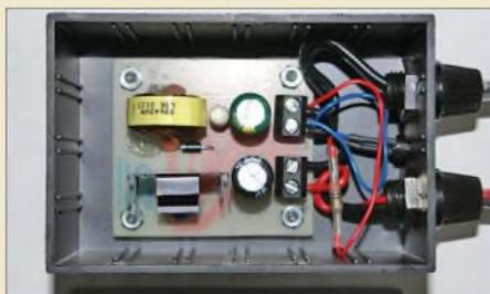
Schaltregler lassen sich unkonventionell und kompakt aufbauen. Wir stellen zwei Varianten mit hohen Wirkungsgraden vor: eine für 5 V/1 A und eine von 2,4 bis 24 V einstellbare für bis zu 3 A.
