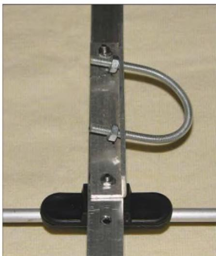
**Bild 13: U-Bügel aus einer Gewindestange als Halterung**
