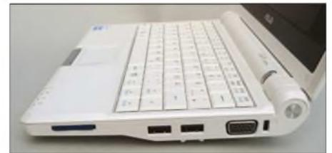
**Bild 3:** Rechts lässt sich eine Speicherkarte einschieben und ein externer Monitor anschließen.
