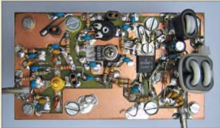
Der Beitrag beschreibt eine 5-W-Linearendstufe für den KW-Bereich und das 6-m-Band mit dem Mitsubishi-MOSFET RD16HHF1. In der ersten Folge werden Vorüberlegungen geschildert und die Schaltung beschrieben.
