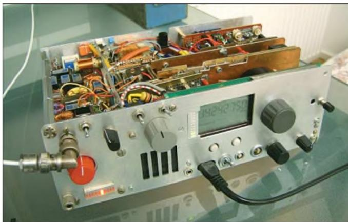
**Bild 1:** Der kompakte Aufbau des kompletten Gerätes (250 x 80 x 160 mm<sup>3</sup>) auf überwiegend HF-Lochrasterplatten. Links neben der Frequenzanzeige das S-Meter in 10-dB-Schritten.
