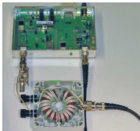
**Bild 6:** 1:4-Balun auf einem großen Eisenpulver-Ringkern T200A-2 (rot)
