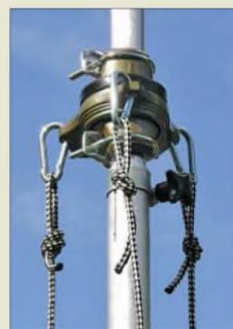
Die für eine Vielzahl an Mastausführungen geeignete Abspanneinrichtung zeigt UKW-Berichte auf der Ham Radio am Stand A1-415.
