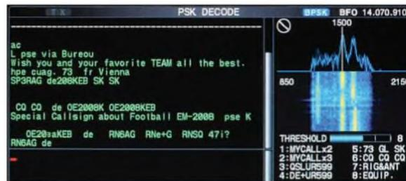
Ein 32-Bit-Fließkomma-DSP sorgt zusammen mit 24-Bit-A/D-Umsetzern u. a. für hervorragende Eigenschaften in Bezug auf Selektion und die weiteren DSP-Funktionen. Dazu gibt es außer der im DSP-Zweig noch eine weitere Regelschleife, die bei sehr starken Signalen in der Nähe des Empfangskanals für eine Abregelung im Bereich der ersten ZF sorgt, um eine Übersteuerung des DSPs zu vermeiden.
