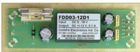
Bild 1: UAP DCW bestückt mit Chinfa-Gleichspannungswandler  $\pm 12\text{ V}$
