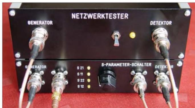
Bild 1: S-Parameter-Umschalter und FA-Netzwerktester, beide in Eigenbau-Gehäusen
