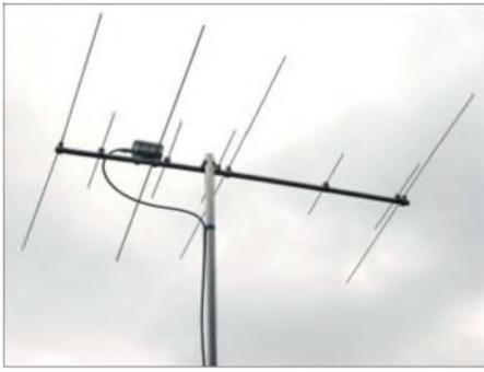
**Bild 4: Die erweiterte Vierelement-Yagi mit den 70-cm-Elementen**
