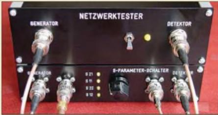
Für anspruchsvolle HF-Aufbauten ist neben der Messung der Durchgangverstärkung und Eingangsreflexion die Kenntnis weiterer Parameter unabdingbar. Dabei erspart die im Beitrag beschriebene Umschaltbox, hier im Bild unterhalb des FA-NWT in einem Eigenbaugehäuse, allzu häufiges Umstecken.
