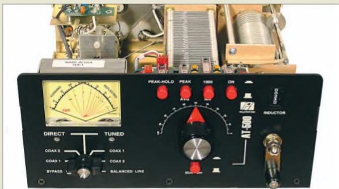
Der 500-W-Antennenkoppler ist sowohl für koaxiale als auch Paralleldrahtleitungen gleichermaßen geeignet.
