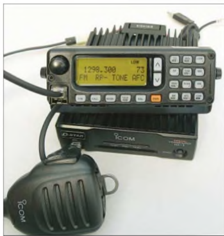
Bild 1: Das eigentliche Funkgerät ist eine Black Box, die entweder vom PC aus oder über ein externes Bedienteil gesteuert wird.
