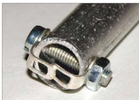
Bild 7: Konstruktion der Innenrohre mit Schrauben und Lötösen
