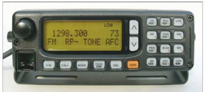
Bild 2: Tasten und Display des Bedienteils RC-24 werden beleuchtet. Das Bedienteil ist nicht in jedem Lieferumfang enthalten.
