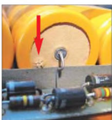
Bild 1: Defekter Hochspannungskondensator mit aufgeplatzter Kappe
