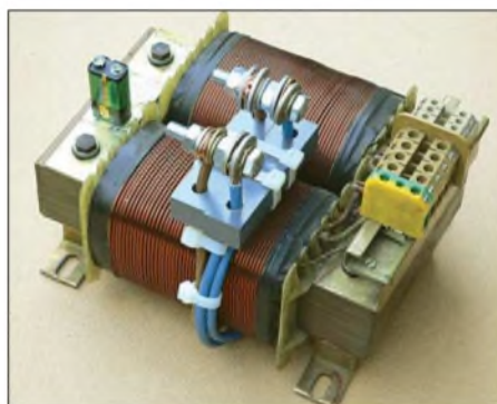
Bild 17: Kräftige Schraubanschlüsse dienen zur Kontaktierung der Hochstromwicklung.
