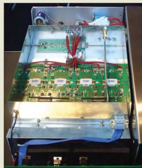
Die neue 23-cm-MOSFET-PA HLV-500 von Be-ko liefert, mit 230 V Netzspannung versorgt, 550 W Sendeleistung bei 1 W Ansteuerung.
