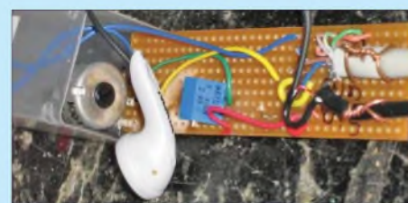
Bild 16: Aufbau der Pegelanpassung auf einer Universalleiterplatte
