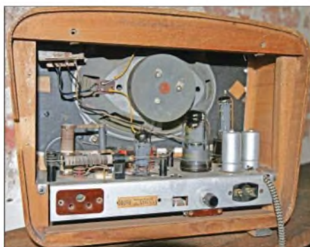
Bild 6: Blick auf das Chassis des Vierkreis-MW-Kleinsupers „Oberhof“ mit induktiver Abstimmung
