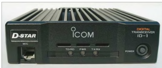
Bild 3: Die Vorderseite des ID-1 bietet außer der Mikrofonbuchse und einigen Status-LEDs nur eine Ein-/Ausschalttaste.
