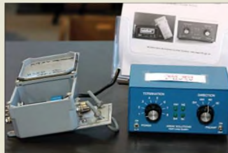
Interessantes Utensil am Stand von appello : fertig aufgebaute Umschalt- und Steuereinheit der K9AY-Schleifenantenne, s. a. FA 4/08, S. 414 f.
