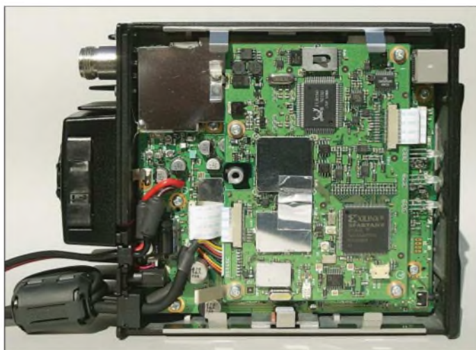
Bild 5: Sauberer Aufbau im Druckgussgehäuse – hier ein Blick auf die Digitalplatine Fotos: DG1NEJ
