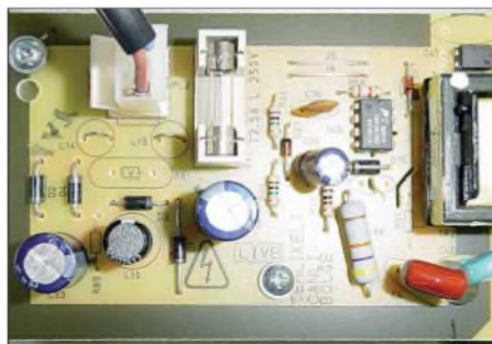
Die auf der Platine erkennbaren Einsparungen sprechen geltenden Sicherheitsbestimmungen Hohn und sind Anlass für breitbandige Funkstörungen.
