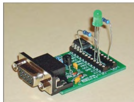
Bild 2: Bauelemente für anwendungsabhängige Teilschaltungen werden in die freien Pins der IC-Fassung gesteckt.
