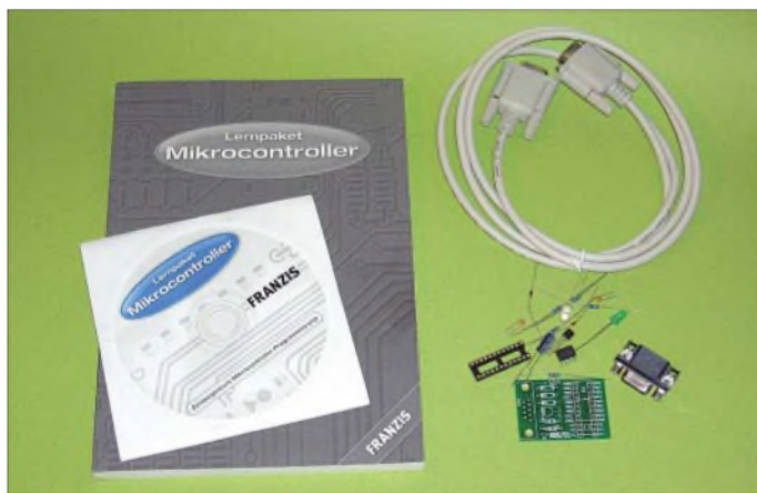
Bild 1: Zum Lernpaket Mikrocontroller gehört eine unbestückte Platine mit den notwendigen Bauelementen.
