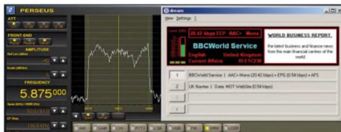
Bild 1: Perseus zeigt nun bis zu 800 kHz im Spektrogramm oder Wasserfalldiagramm.
