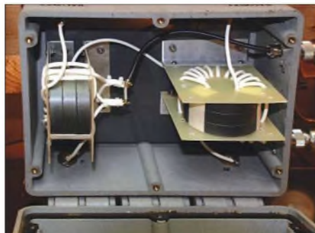
Bild 2: Baluns zur Anpassung der Sendeanenne
