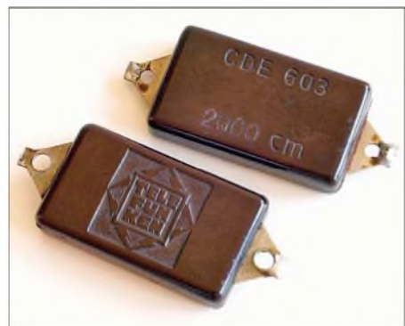
Bild 6: In der Anfangszeit wurde die Kapazität von Kondensatoren in der Einheit cm gemessen, 1 cm entspricht 1,1 pF.
