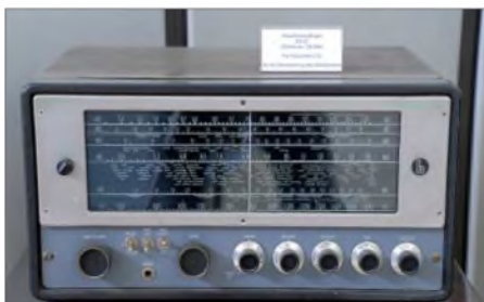
Dieser Allwellenempfänger von Hallicrafters wurde zur Überwachung der eigenen Kurzwellensendungen benutzt.
