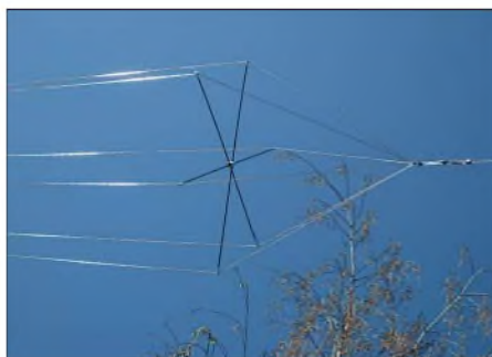
Bild 2: Sechsadriger Kegelreusenstrahler mit selbst gebautem Spreizer (1 m Durchmesser)
