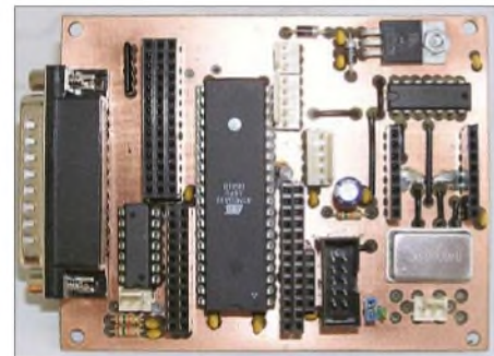
Bild 8: Bestückungsansicht einer voll bestückten Prototypen-Platine der Version B. Im aktuellen Layout sind einige Stecker abweichend positioniert, um die neuesten Erweiterungen (acht- statt fünfpoliger DDS-Stecker) zu berücksichtigen.
