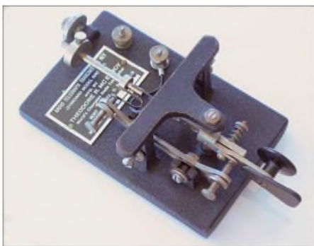
„Mac-Key Standard“, halbautomatische Morsetaste von 1939, Metallteile vernickelt, Preis damals 7,50 US- \text{\$} ; Aufnahme von Adam Nathanson, N4EKV
