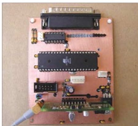
Bild 5: Diese Platine entspricht der Minimalbestückung für die Version A mit einem DDS. Der Anschluss für ISP und der RS232-Stecker sind dabei schon als empfohlene Zusätze anzusehen.
