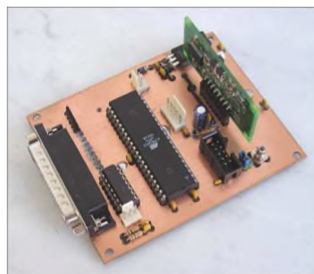
Bild 2: Version-A-Platine, bestückt mit einem DDS; gut zu erkennen sind die Stecker für die Spannungsversorgung, die RS232-Schnittstelle, den ISP-Wannenstecker und unten links den Stecker für PTT bzw. Dot/Dash im CW-Mode. Der DDS-HF-Ausgang steht an der SMC-Buchse zur Verfügung.
