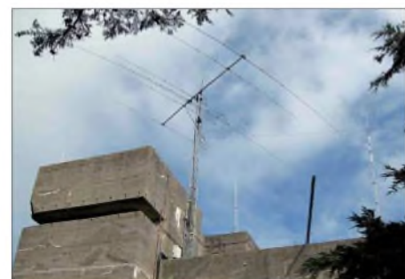
Mehrelement-Richtantenne für die oberen sowie Vertikalantenne für die niederfrequenten Bänder auf ehemaligen militärischen Bollwerken des Zweiten Weltkrieges Foto: OE5HDN
