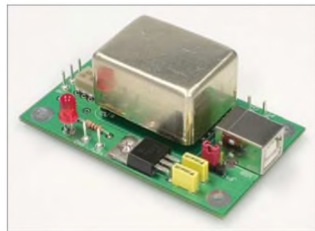
Bild 3: Bei Bedarf lassen sich noch Spannungsregler, Betriebsspannungskontrolle und Übertrager auf der Platine bestücken.
