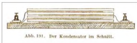
Bild 3: Ansicht des zusammengesetzten Kondensators im Schnitt
