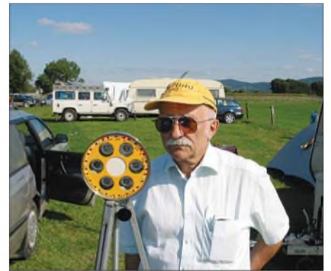
Peter, DL7UHU, und sein Eigenbaugerät zur Justage von Lichtsprechgeräten, mit Tripelprismen und Sender für 348 und 455 THz.
