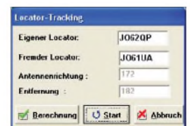
Bild 5: Nach Start dreht sich die Antenne in die berechnete Richtung zur Gegenstation.
