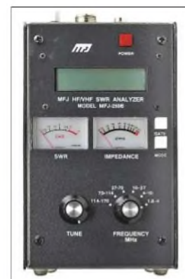
Bild 20: Das eigentlich für Antennen- messungen gedachte MFJ-259B eignet sich auch zum Messen der Resonanz- frequenz von Kondensatoren.
