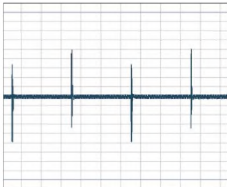
Bild 7: Selbst die Schaltimpulse des Ankers in einer Quarzuhr mit Analoganzeige lassen sich bei der WAV-Aufzeichnung mit dem H-Feld-Messmodul festhalten.
