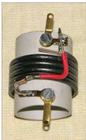
Bild 6: Sperrkreis für 28,4 MHz aus Koaxialkabel RG174
