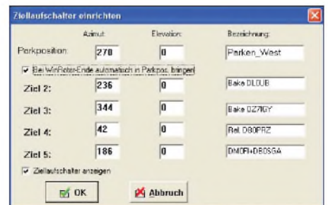
Bild 4: Sehr nützlich ist es, Zielaufschalter mit bevorzugten Relais und Baken zu belegen sowie die Parkposition einzustellen.
