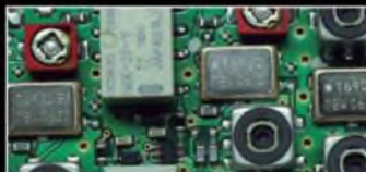
1. ZF: Drei Roofing-Filter bei 69,45 MHz
