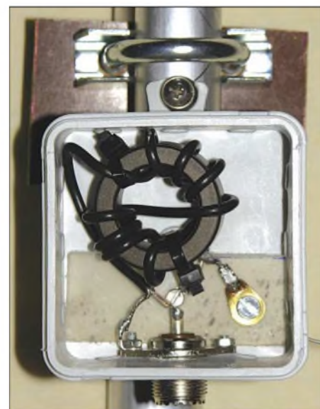
Bild 3: Praktische Ausführung des Baluns in der Anschlussdose am Strahler
