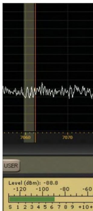
vBild 3: Im 40-m-Band bringt die Drahtantenne einen Rauschpegel von etwa S6, ...
