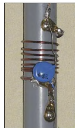
Bild 4: Aufbau des 10-m-Sperrkreises aus CuL-Draht und Hochspannungskondensator
