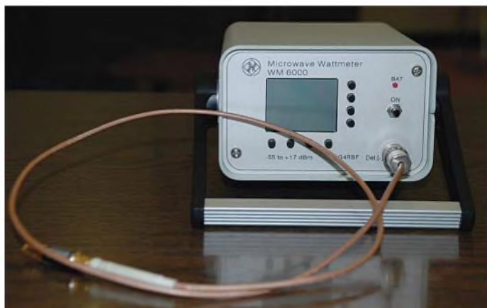
Mit diesem Milliwattmeter mit 2,1-Zoll-Farbdisplay aus einem Mobiltelefon wurde Bernd Kaa, DG4RBF, zum Sieger des Selbstbauwettbewerbs.
