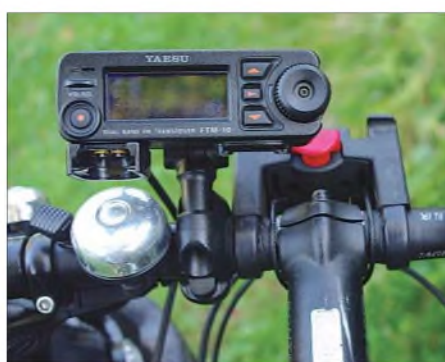
Bild 5: Das mit einem Mikroprozessor ausgestattete Bedienteil enthält auch ein Mikrofon und einen Lautsprecher. Es lässt sich mit variablen Schellen und Bolzen mechanisch stabil an einem Fahrradlenker unterbringen. Links unten ist die Ladeschale und Halterung CAB-1 für das Bluetooth Headset BH-1 erkennbar, das nur über diese aufgeladen werden kann. Das Steuerkabel lässt sich nicht vom Bedienteil abnehmen, was dessen Mitnahme, etwa bei einer Übernachtung, erschwert.
