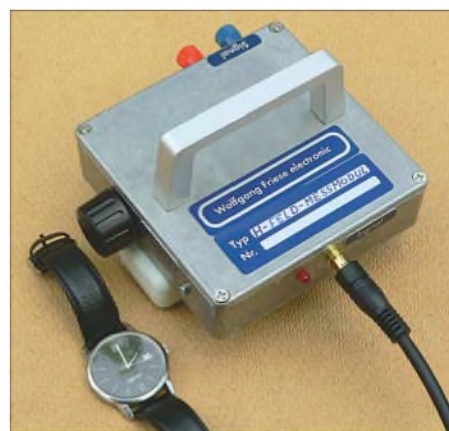
Bild 8: Hier detektiert das H-Feld-Messmodul die magnetischen Impulse, die von dem Anker der Armbanduhr ausgesendet werden. Fotos und Screenshots: DG9WF
