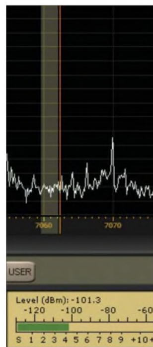
Bild 4: ... der sich beim Wechsel zur Magnetantenne auf S4 reduziert. Jetzt sind auch vormals im Rauschen versunkene Signale sichtbar und hörbar. Bilder: DL1ABJ
