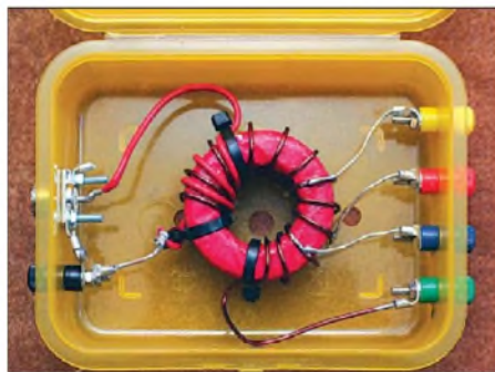
Bild 3: Der fertige Unun im Tupper-Design mit Anzapfungen für 1:6, 1:9, 1:12 und 1:16; die drei Koppelwindungen werden zwischen die letzten drei Windungen der Hauptspule gewickelt.
