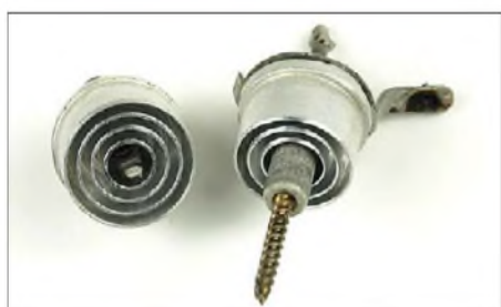
Bild 49: Hauptbestandteile des Lufttrimmers aus Bild 48
