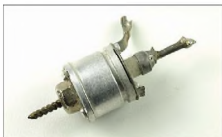
Bild 48: Außenansicht eines zusammengesetzten Lufttrimmers
