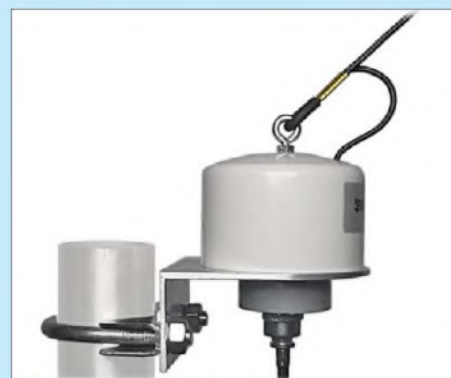
Bild 4: Dieser MTFT-Balun (genau genommen eigentlich ein Unun [5]) zur Anpassung von Langdrahtantennen dient gleichzeitig als Aufhängepunkt. Werkfoto: Berlinfunk.de
