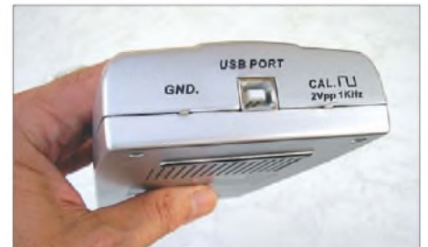
Bild 2: Spartanisch geht es auch auf der Rückseite zu: USB-Anschluss sowie Kontakte für Masse und das 1-kHz-Prüfsignal.
