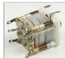
Bild 38: Ein Mehrfachdrehkondensator mit Folie als Isolator
