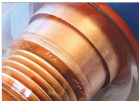
Bild 52: Konzentrischer Zylinder des Vakuumdrehkondensators aus Bild 51
