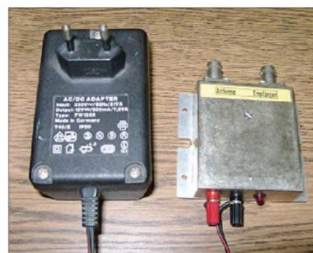
Bild 14: Die Fernspeisung nach Bild 13 ist in ein geschirmtes Gehäuse einzubauen.
