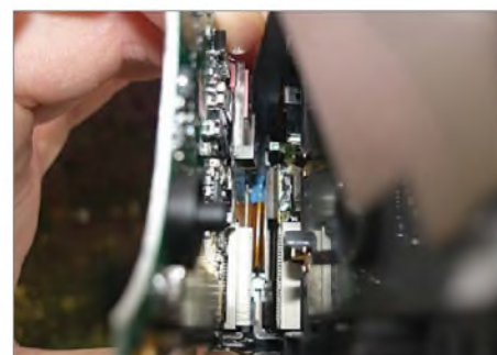
Bild 6: Für mehr Einblick müssten die Ferritantenne und der Abstimm-drehschalter entlötet werden.
