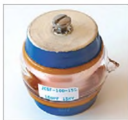
Bild 47: Vakuumpendensator mit fester Kapazität Fotos: DJ3TZ
