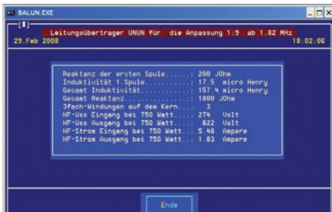
Bild 9: Rechenergebnis für den Leitungsübertrager 1:9 in Bild 8
