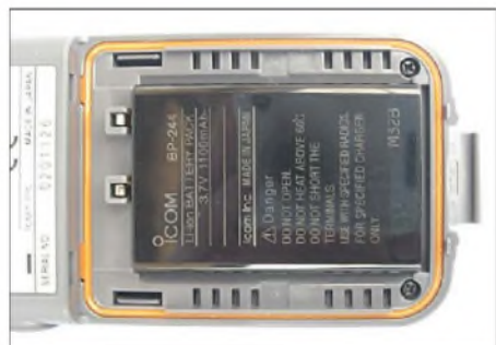
Bild 4: Auch das Akkumulatorfach ist gut abgedichtet.
