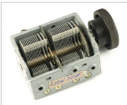
Bild 33: Typischer Luftdrehkondensator aus einem Röhrenradio
