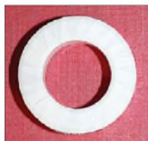
Bild 5: Ringkernbehandlung; oben die zwei FT-240-43 im Originalzustand, darunter zusammen- geklebt und zum Fixieren bis zum Ab- binden des Klebstoffs über ein Staubsauger- rohr geschoben; darunter mit PTFE- Band sowie unten mit Textilband bewickelt
