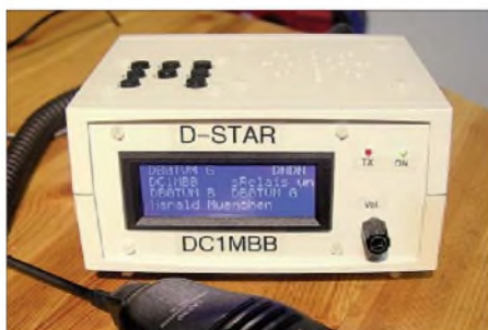
Aufbauvariante von Harald Schmid, DC1MBB, basierend auf einem Standardgehäuse Typ BOPLA U 160, 160 x 75 x 133 mm³, grau (Bezug: Reichelt Elektronik); leider ist dieses Gehäuse nur aus Kunststoff, aber dafür passt es fast wie maßgeschneidert, Einstrahlungsprobleme oder Störsignale vom Adapter sind nicht aufgetreten. Foto: DC1MBB
