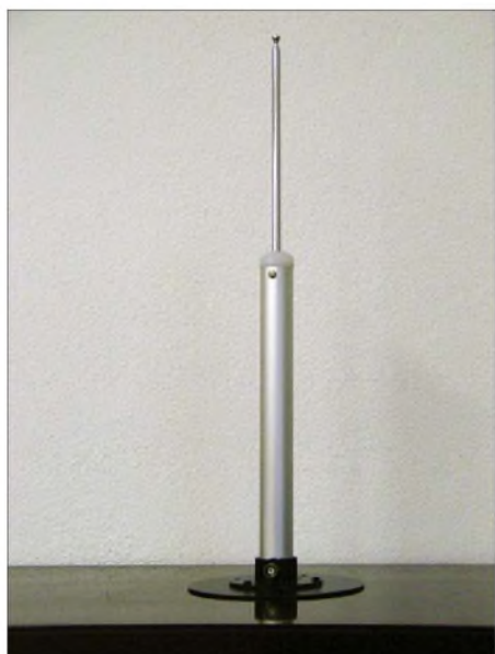
Bild 9: Antennenstab einer Aktivantenne mit Operationsverstärker nach Bild 10
