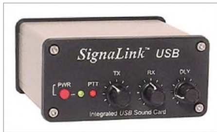
Bild 3: Tigertronics SignaLink USB-Interface mit eingebauter Soundkarte Foto und Screenshots: DL2RUM
