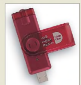
An den Receiver im USB-Stick-Format ist nur noch die Antenne anzustecken.
