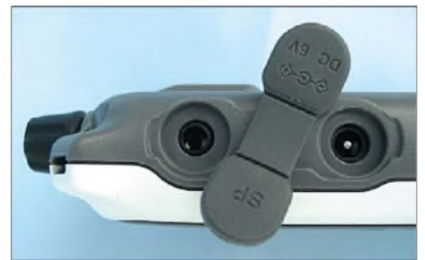
Bild 3: Auf der rechten Seite liegen die Anschlussbuchsen.
