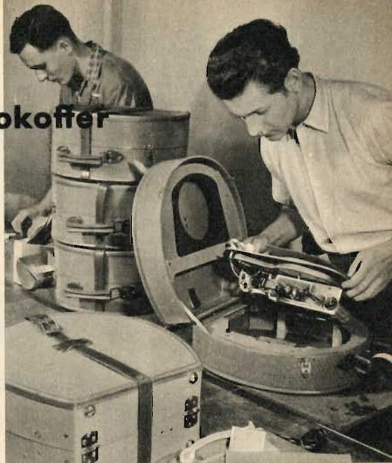
Ein letzter Blick in das Innere des Gehäuses für den Philips-Phonokoffer III. Dann wird das Chassis mit dem fest montierten Verstärkerteil (die Röhren sind deutlich sichtbar) eingesetzt
