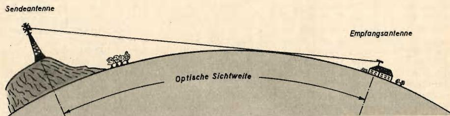
Abb. 1. Definition der „optischen Sichtweite“
