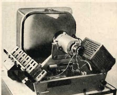
Abb. 1. Chassisansicht einer für den Service zweckmäßigen Bauform (Metz 901)
